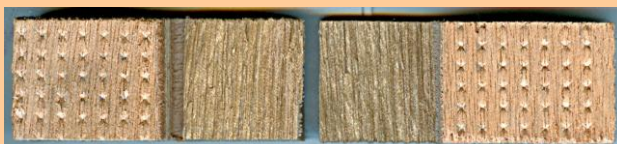
δοκιμασθέν Κ/Π σε τεστ διάτμησης
