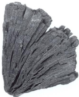
Εγκάρσια τομή λευκής δρυός σε καρβουνοποιημένο δείγμα ξύλου
