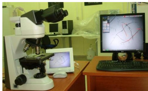
Εργαστηριακό ερευνητικό μικροσκόπιο NIKON ECLIPSE 50i με ψηφιακή κάμερα, λογισμικό μορφομετρικών μετρήσεων, σύστημα φθορισμού και πόλωση
