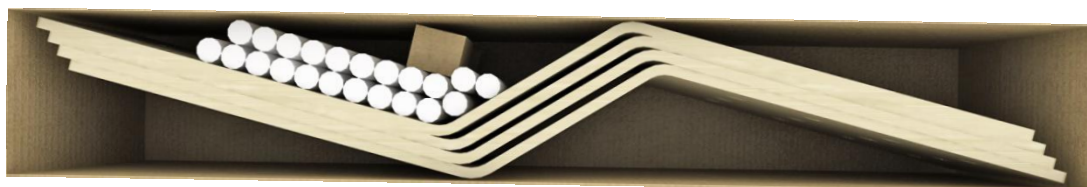
εικ 4. 7 Τα ράφια στοιβάζονται το ένα πάνω στο άλλο ενώ στα κενά που δημιουργούνται αποθηκεύονται τα πηγάκια, οι καβίλλες, οι βίδες και τα λαστιχάκια.
