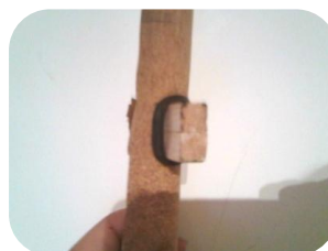
εικ. 4.1 πρόχειρη μακέτα για δοκιμή φρένου της καβίλιας με λάστιχο.
