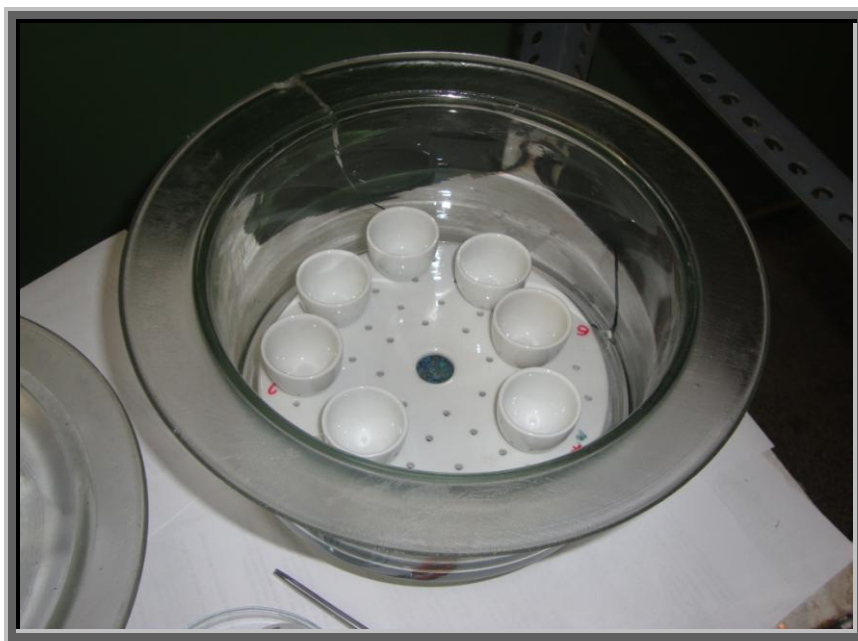
Εικόνα 26: Κάψες μετρήσεων τέφρας πάνω σε πορσελάνινο δίσκο.
