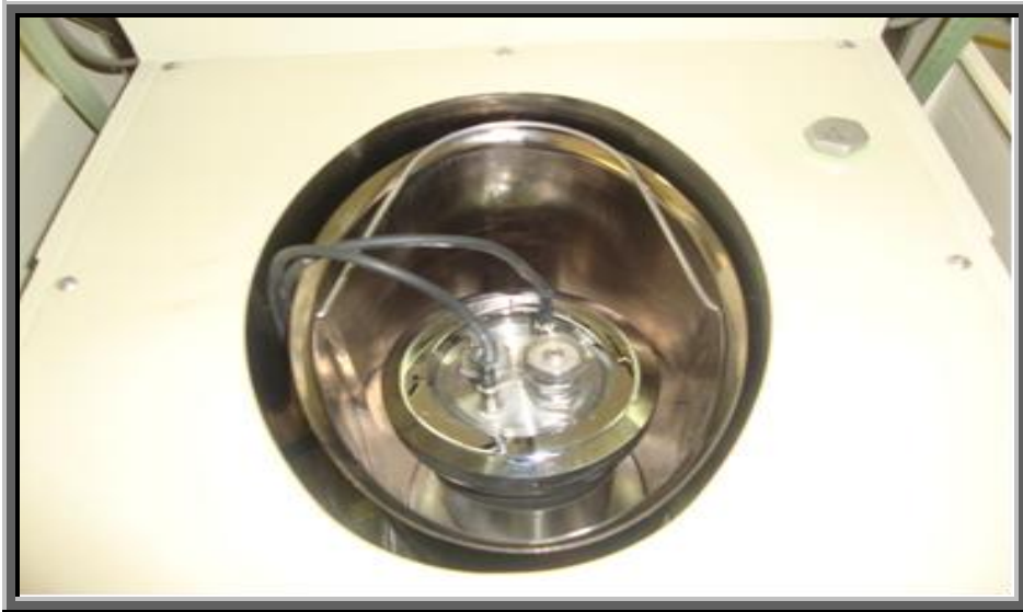
Εικόνα 25: Τοποθέτηση οβίδας-κάδου στο θερμιδομετρητή και σύνδεση ηλεκτρονίων.
