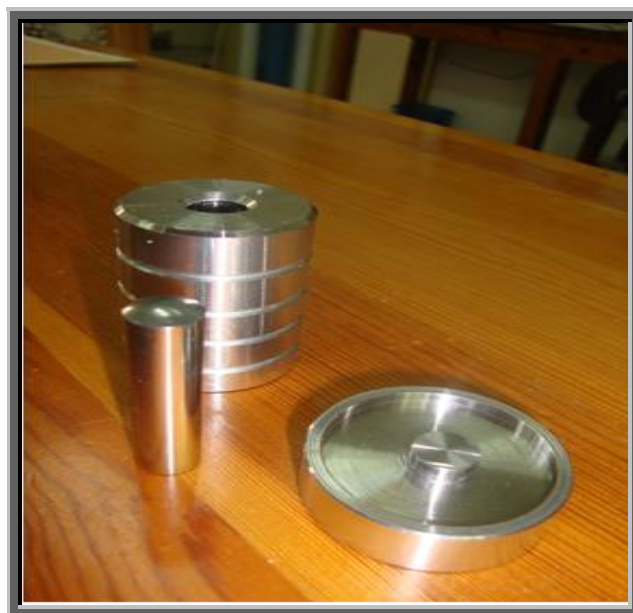
Εικόνα 14: Μήτρα παραγωγής εργαστηριακών pellet.
