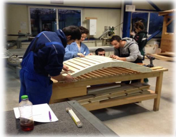
Εικόνα 2. Παράλληλα με το γυαλοχάρτισμα & το στοκάρισμα, διαμορφώνονται τα σημεία σύνδεσης με μεντεσέ.
