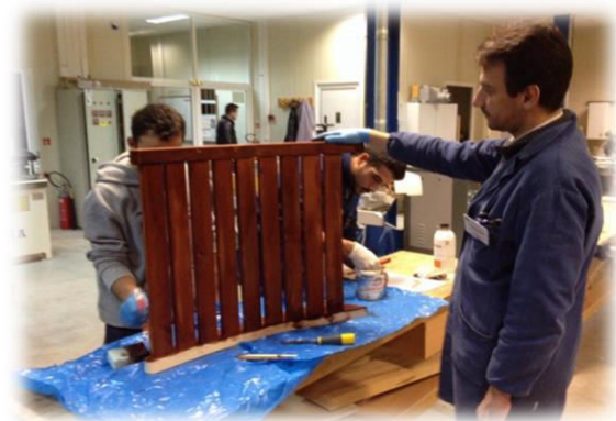
Εικόνα 4. Φάση από το φινίρισμα. Περνιέται το δεύτερο χέρι βαφής. Παράλληλα, οπτικός έλεγχος για κάλυψη "αστοχιών".
