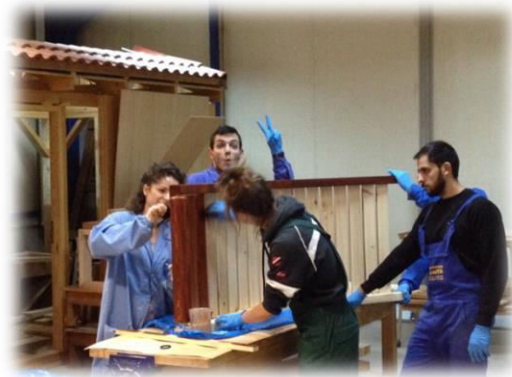
Εικόνα 3. Φάση από το φινίρισμα. Η εργαστηριακή ομάδα περνάει το πρώτο "χέρι" της βαφής.
