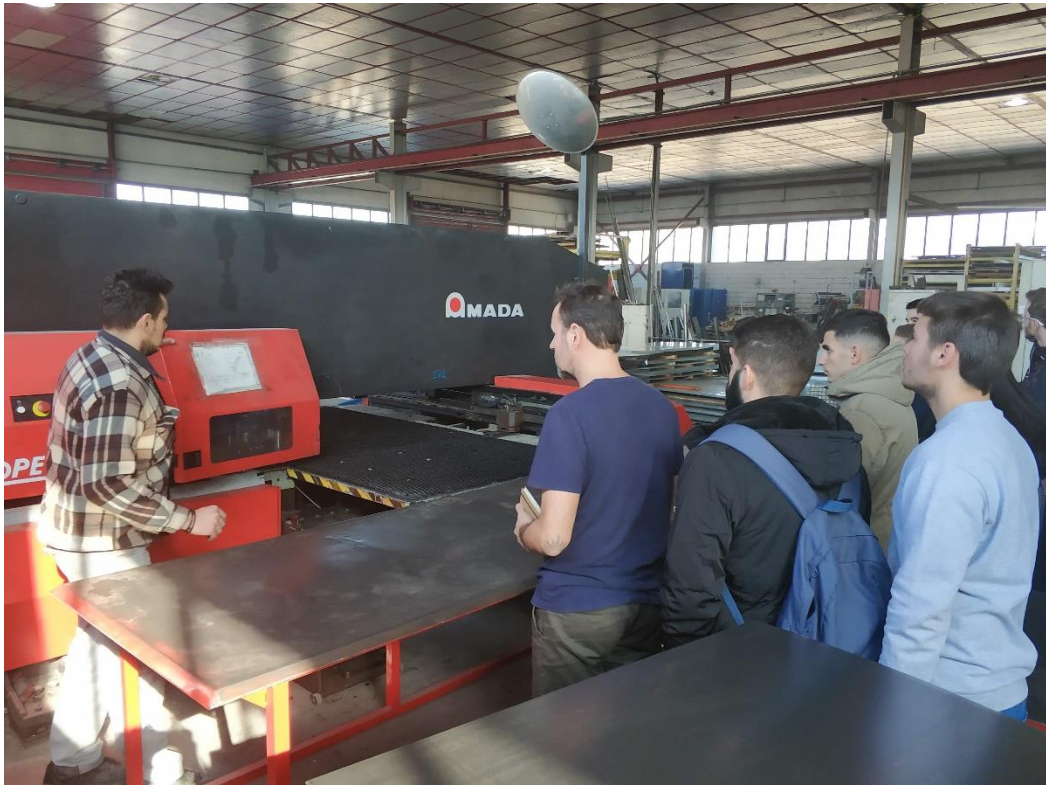
Μηχάνημα punching για αφαίρεση υλικού
