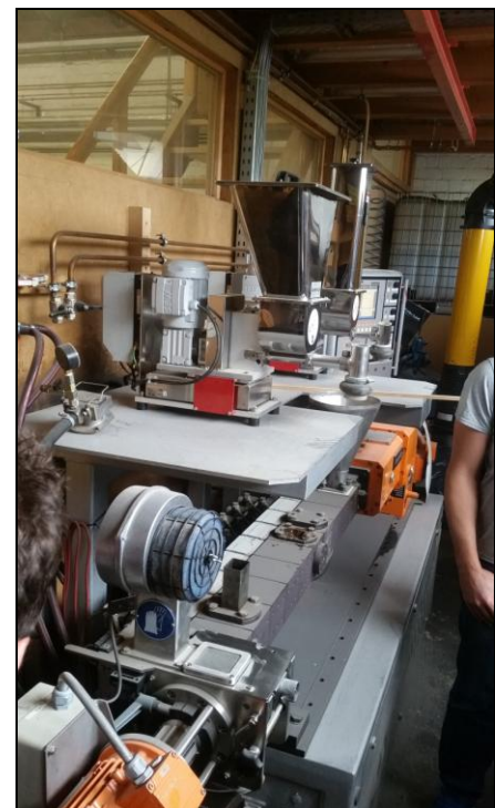
Φωτ. από την επίδειξη παραγωγής WPC που μας έγινε στο pilot plant ( extruder )
