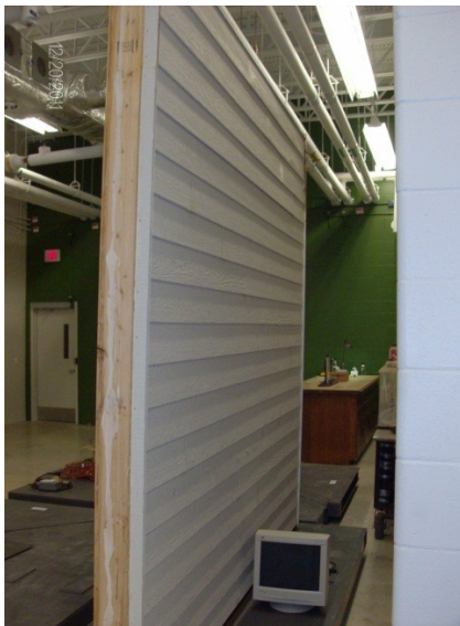
Πλαίσιο ξύλινης επένδυσης (πραγματικών διαστάσεων) υπό δοκιμή – Δεξιά, στο Forest Products Laboratory φαίνεται ο θάλαμος κλιματικών δοκιμών για κατασκευές μεγάλων διαστάσεων
