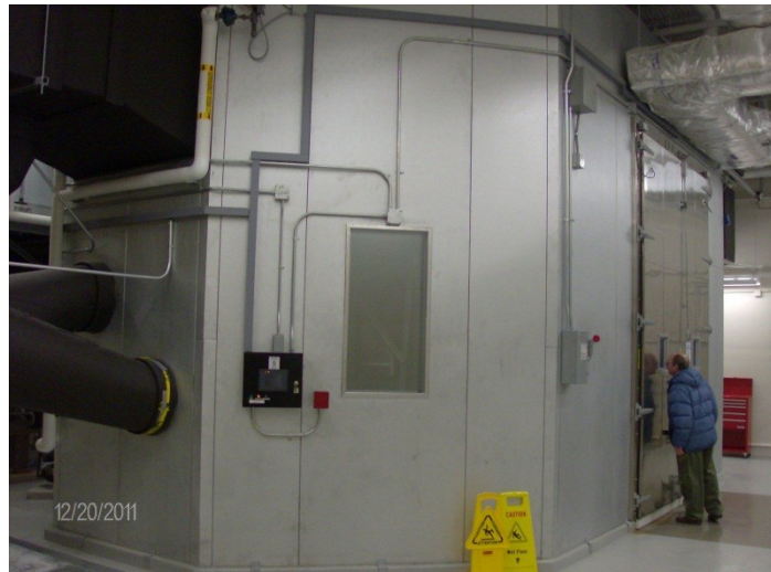
Πλαίσιο ξύλινης επένδυσης (πραγματικών διαστάσεων) υπό δοκιμή – Δεξιά, στο Forest Products Laboratory φαίνεται ο θάλαμος κλιματικών δοκιμών για κατασκευές μεγάλων διαστάσεων
