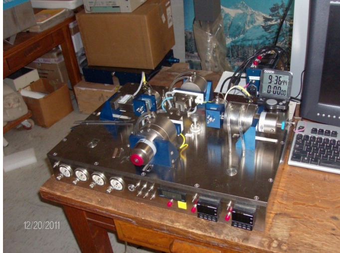
Συσκευή ελέγχου ποιότητας συγκόλλησης ABES στο FPL (Εργαστήριο Τεχνολογίας Ρητινών, Dr. Charles Frihart), βλ. paper – Στο χώρο υποδοχής του Forest Products Laboratory
