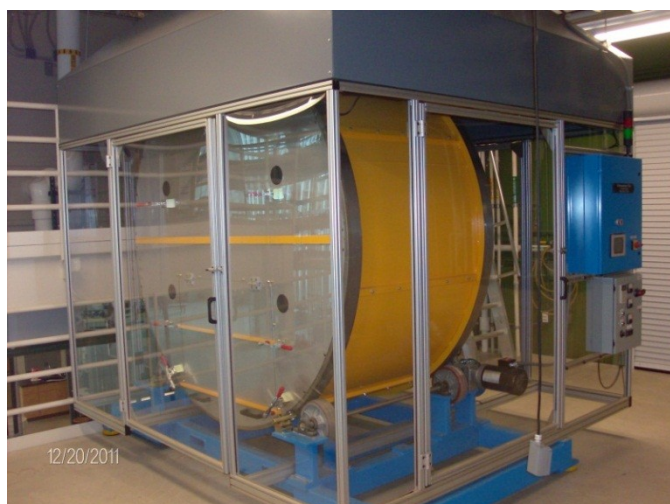
Στο FPL (Centennial Research Facility) φαίνονται στις παραπάνω φωτ. οι εργαστηριακές συσκευές του pilot plant για δοκιμές συγκολλημένων προϊόντων ξύλου π.χ. OSB, MDF, PB κ.α.
