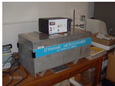
Στο FPL μαζί με τον συνάδελφο Dr. C. Frihart , που μας ξενάγησε στα εργαστήρια - Στη μικρή φωτ. φαίνεται το Dynamic micro chamber (DMC) με το οποίο εκτιμάται η αέρια φορμαδεΰδη σε προϊόντα ξύλου (σημ. στις ΗΠΑ η μέθοδος Perforator δεν είναι διαδεδομένη και δεν χρησιμοποιείται συχνά) βλ. συνθετική εργασία - report (2011)
