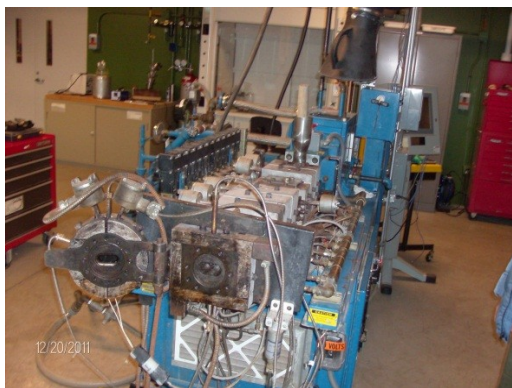
Πιλοτική δοκιμή προϊόντος WPC σε πιλοτικό twin-screw extruder στο FPL (20-12-2011)
