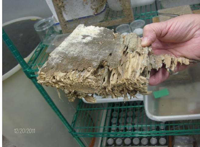
Αριστερά, ο Dr. F. Green – Ξύλινο πάτωμα προσβεβλημένο από τερμίτες (Εργαστήριο Προστασίας Ξύλου & Βιολογικών Δοκιμών, Dr. Frederick Green III)
