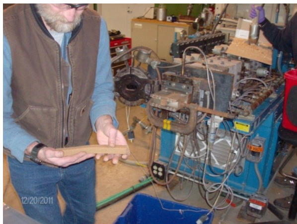
Πιλοτική δοκιμή προϊόντος WPC σε πιλοτικό twin-screw extruder στο FPL (20-12-2011)
