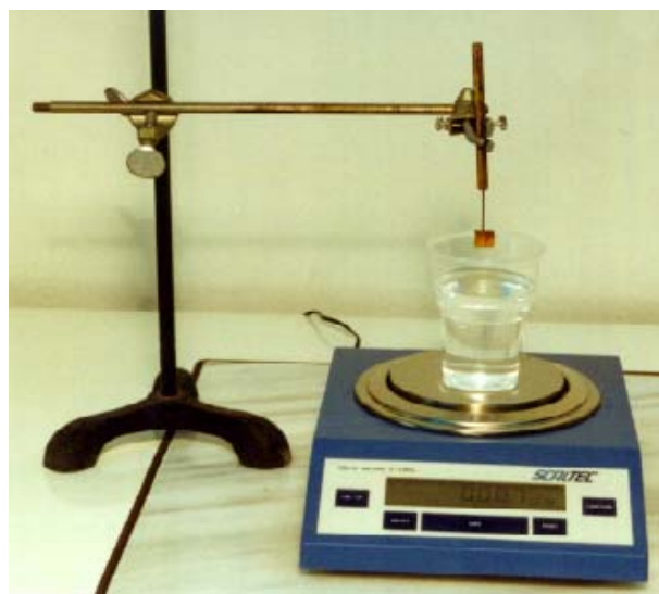
Προσδιορισμός του όγκου με εμβάπτιση του δείγματος σε δοχείο με νερό
