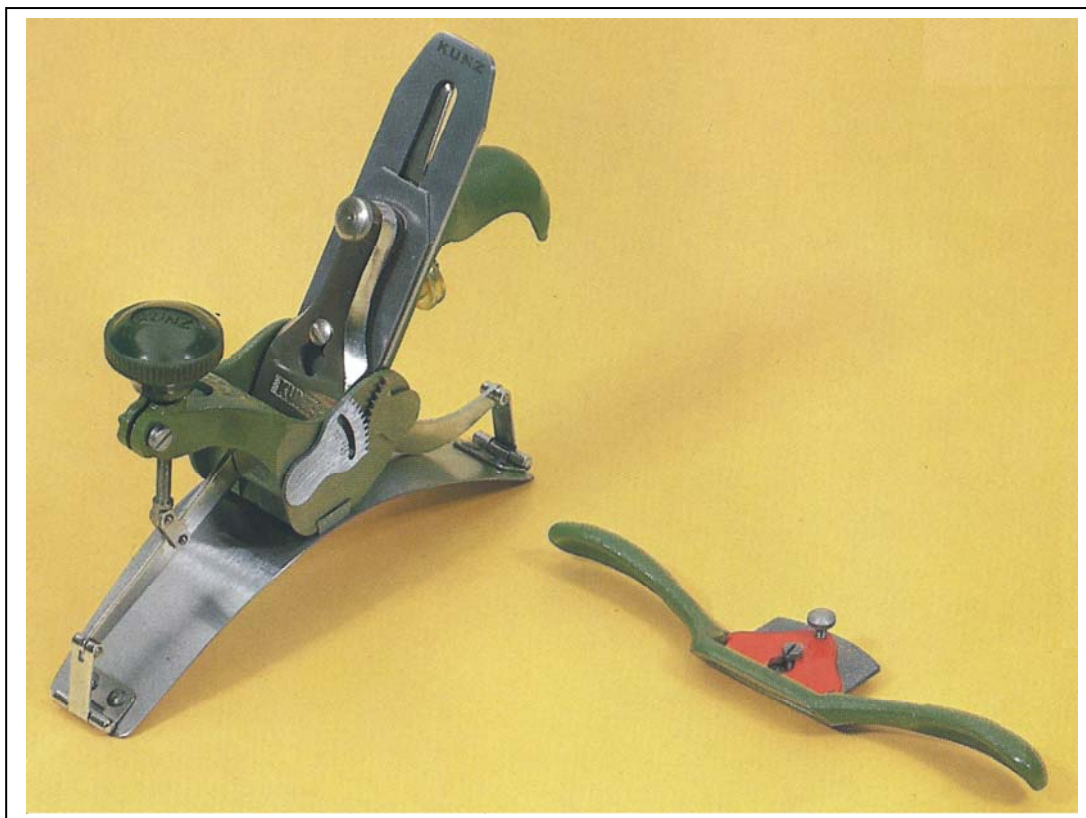
Εικ. 22. Μεταλλική πλάνη για πλάνισμα σε καμπύλες επιφάνειες (με ρύθμιση της ακτίνας καμπυλότητας) και πλάνη καμπύλων μερών με ελεύθερη κίνηση (παστράγκουλο ή παστράγκαλο).
