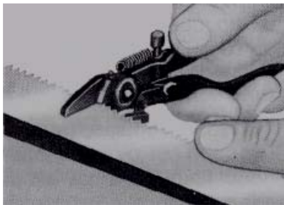
Εικ.12. Ρύθμιση έκκαμψης δοντιών με τσαπραζολόγο.
