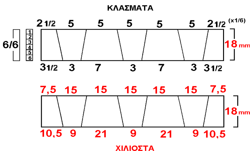
Εικ. 1. Τρόπος υπολογισμού και σημαδέματος για την κατασκευή λοξών δοντιών (τύπου χελιδονοουράς). Επάνω οι θεωρητικές αναλογίες που ισχύουν για κάθε σύνδεσμο. Κάτω (με κόκκινο) το τελικό αποτέλεσμα σε χιλιοστά (mm), σύμφωνα με το παράδειγμα που χρησιμοποιήσαμε (πάχος ξύλου 18 mm).
