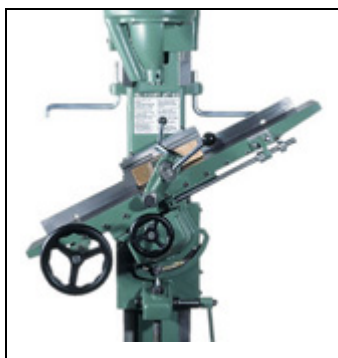
Εικόνα 4.3. Κεκλιμένη τράπεζα εργασίας.
