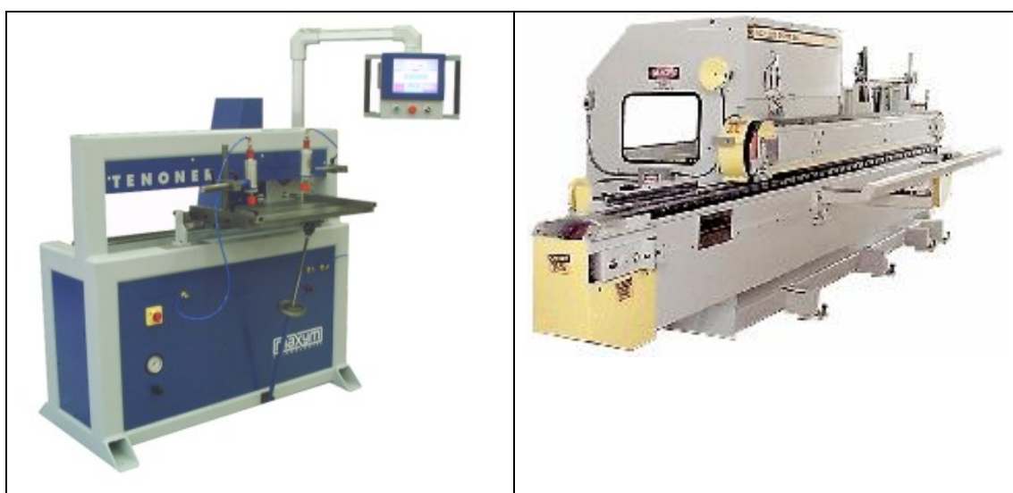
Εικόνα 4.1. Απλή ξεμορσαρίστρα χαμηλής παραγωγικότητας (αριστερά) και υψηλής παραγωγικότητας (δεξιά).
