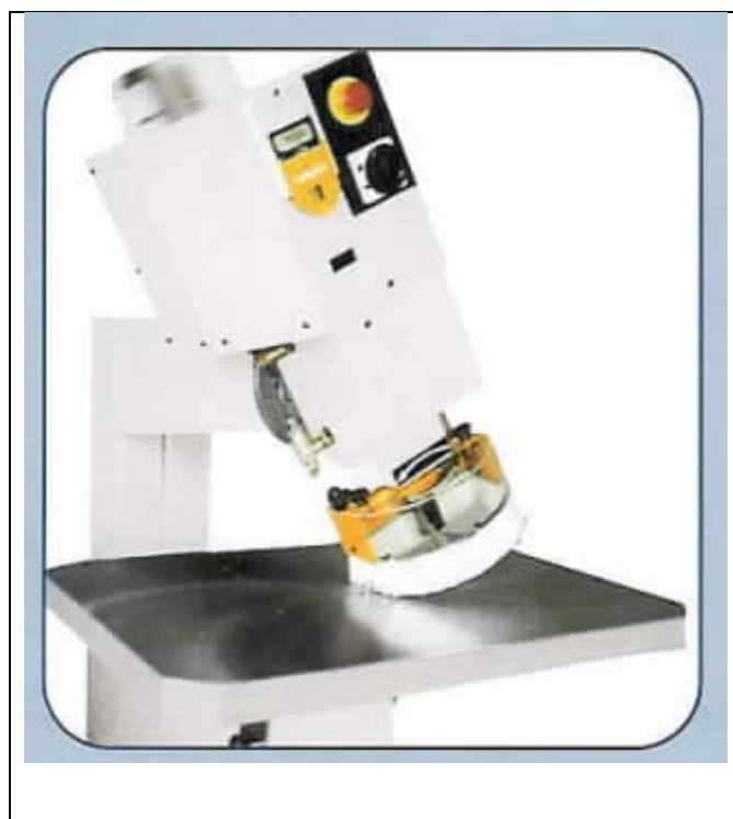
Εικόνα 2.2. Κεκλιμένη κοπτική κεφαλή.
