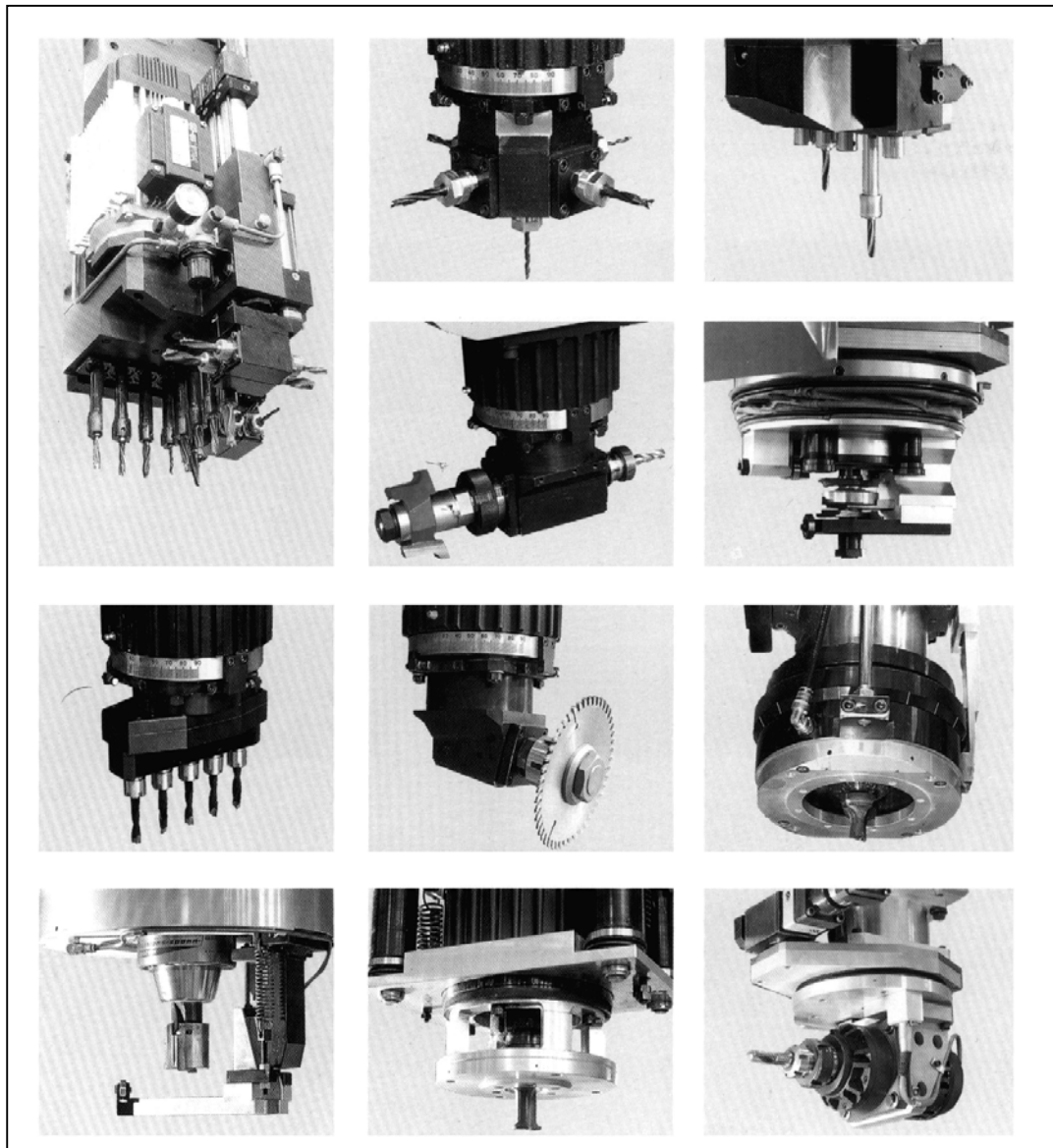
Εικ. 3.5. Διάφορα μέσα κατεργασίας που χρησιμοποιούνται σε κέντρα εργασίας.
