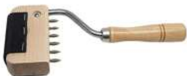
Εικ. 23. Εργαλείο τάνυσης ιμάντων, πριν τη στερέωσή τους με καρφιά ή με δίχαλα.
