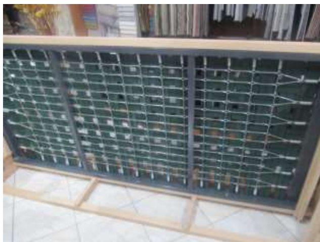
Εικ. 9. Μεταλλικό πλαίσιο, στο οποίο συγκρατείται πλέγμα ελατηρίων με μεταλλικές ταινίες. Προσδίδει ελαστικότητα και χρησιμοποιείται περισσότερο σε καναπέδες ή/και κρεβάτια. Επενδύεται με αφρώδη υλικά.
