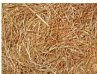
Εικ. 6. Τζίβα. Φυτικό προϊόν, χρησιμοποιείται σαν υλικό πλήρωσης. Έχει τάση φυσικής επαναφοράς στον αρχικό όγκο της.
