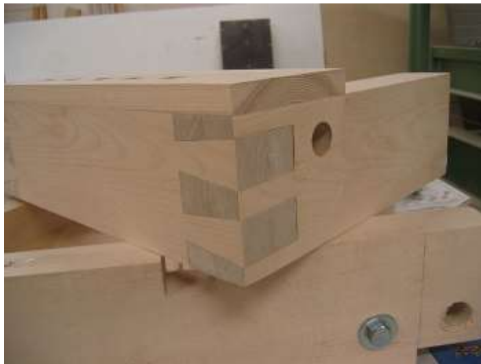
Εικ. 36. Σκελετός επίπλου ταπετσαρίας από συμπαγή ξυλεία. Χρησιμοποιήθηκαν μεγάλες διατομές, σύνδεσμοι κιβωτίου με λοξά δόντια (χελιδονοουρές) και μεγάλης διαμέτρου βίδες με παξιμάδι. Η κατασκευή αυτή αναμένεται να έχει μεγάλο βάρος αλλά και αντίστοιχα πολύ μεγάλη αντοχή (πηγή: https://arjdesign.com/blog/upholstery-the-price-vs-the-cost )
