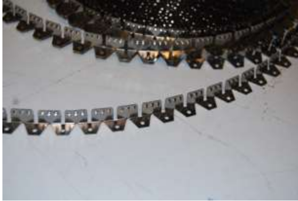
Εικ. 10. Μεταλλικό τσέρκι συγκράτησης της υφασμάτινης επένδυσης.
