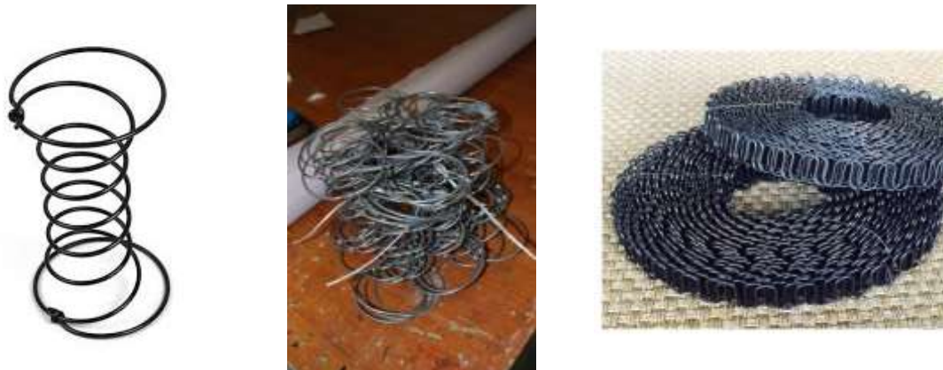
Εικ. 8. Τύποι ελατηρίων. Αριστερά, ελικοειδές (σπειροειδές) ελατήριο. Κέντρο, συσκευασία ελατηρίων. Δεξιά, συσκευασία σιγμοειδών ελατηρίων (τύπου ζιγκ-ζάγκ).
