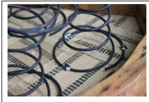
Εικ. 30, 31. Αριστερά, εργαλείο αγκύρωσης ελατηρίων πάνω σε υφασμάτινη βάση ή ιμάντες. Δεξιά, ελατήρια αγκυρωμένα με μεταλλικά κλιπς πάνω σε ιμάντες βάσης καθίσματος.
