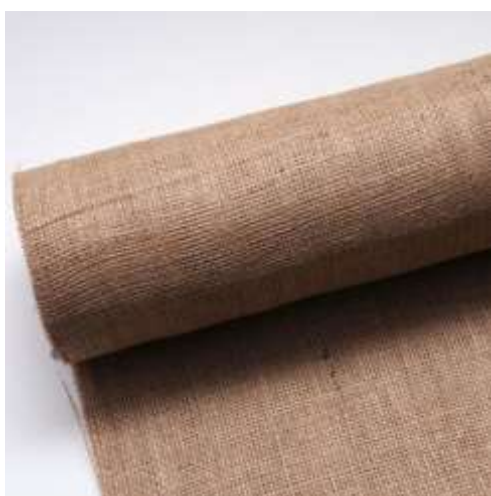
Εικ. 7. Λινάτσα γιούτας. Φυτικό προϊόν, χρησιμοποιείται σαν υλικό επικάλυψης ελατηρίων ή άλλων υλικών πλήρωσης. Είναι ανθεκτικό αλλά έχει τραχεία επιφάνεια που απαιτεί πρόσθετη επικάλυψη με ύφασμα, ώστε να προσδίδει πιο ομαλή και μαλακή στην αφή επιφάνεια.
