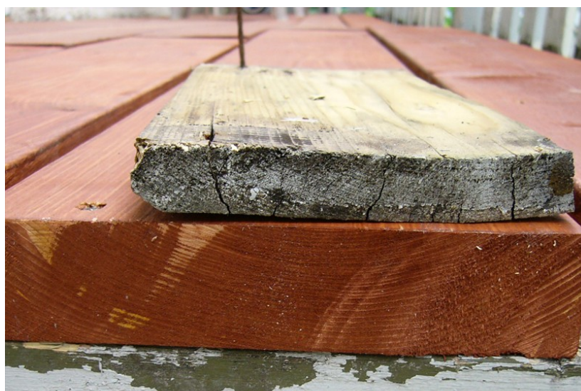
Σχήμα 1.4. Στρέβλωση και ραγάδες σε ξύλο εξαιτίας απότομων μεταβολών υγρασίας.
