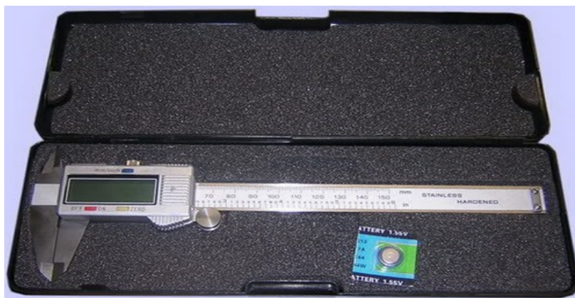
Σχήμα 2.4. Ηλεκτρικό παχύμετρο μέσα στη θήκη του μαζί με μπαταρία.
