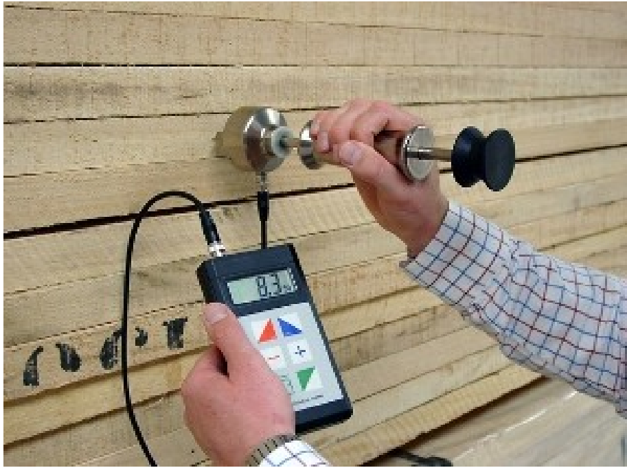
Σχήμα 2.8. Ηλεκτρικό υγρόμετρο και τοποθέτησή του πάνω σε στοιβαγμένη ξυλεία για μέτρηση της περιεχόμενης υγρασίας.
