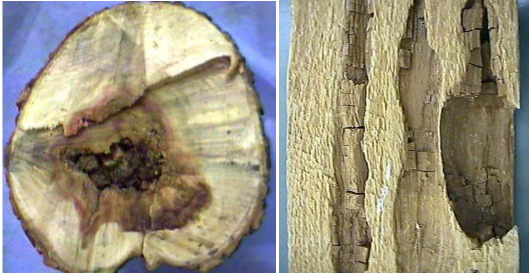
Σχήμα 1.6. Ξύλο που έχει προσβληθεί από μύκητες (αλλοίωση).
