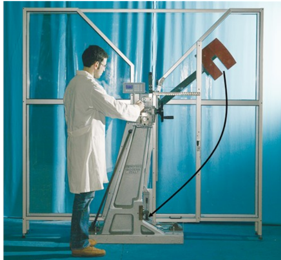
Σχήμα 5.7. Συσκευή για απότομη θραύση (κρούση) του ξύλου
