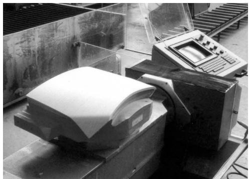
Αριστερά - Φωτογραφία του καλουπιού με ένα κομμάτι κόντρα - πλακέ αφού έχει κοπεί στη μηχανή CNC της εταιρίας.
