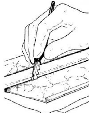
Η Χάραξη γυαλιού (Glass scoring) μπορεί να διεξαχθεί είτε με το χέρι ή σε plotter καθοδηγούμενο κατά τους άξονες x, y από υπολογιστή (cnc). Το διάγραμμα παρακάτω παρουσιάζει τη διαδικασία χάραξης οδηγούμενη από υπολογιστή.
