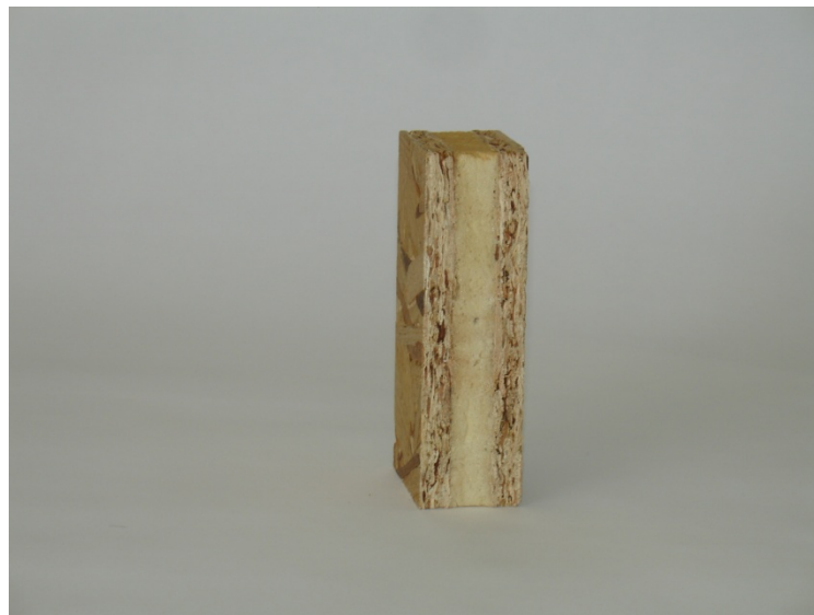
Εικ. 7. Μονωτικό πάνελ με εξωτερικές επιφάνειες από OSB.
