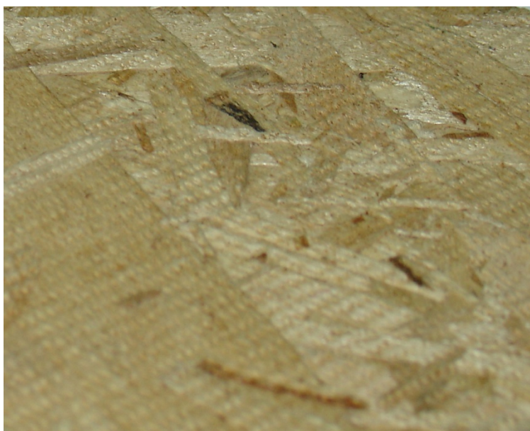
Εικ. 5. Αντιολισθητική επιφάνεια σε ξυλοπλάκα OSB.
