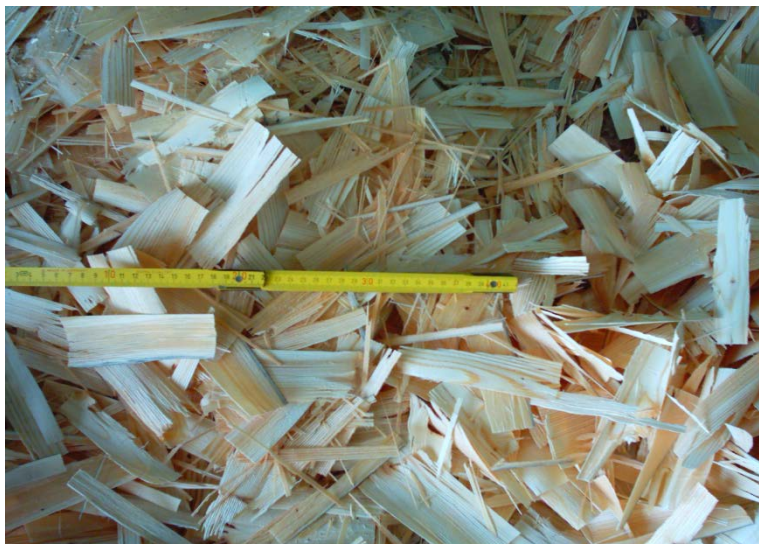
Εικ. 2. Ξυλοτεμαχίδια (strands) για κατασκευή OSB.
