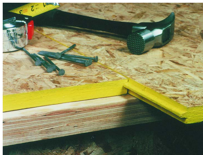
Εικ. 4. Ξυλοπλάκες OSB με μορφοποιημένα άκρα (μόρσο - εγκοπή).
