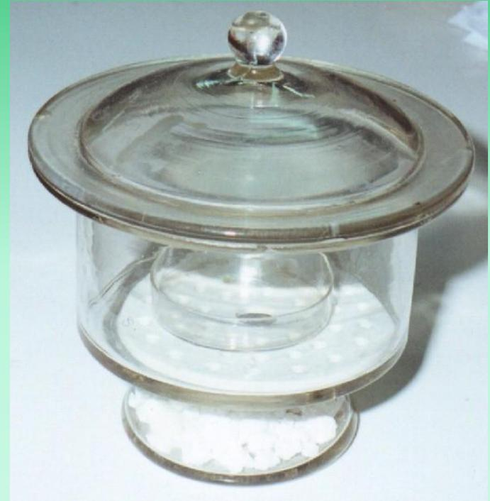
**Μέτρηση υγρασίας με ξήρανση και ζύγιση**
