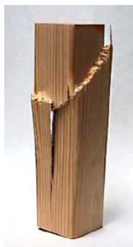
Εικόνα 2. Δείγμα μετά από πείραμα αντοχής σε θλίψη παράλληλα με τις ίνες.
