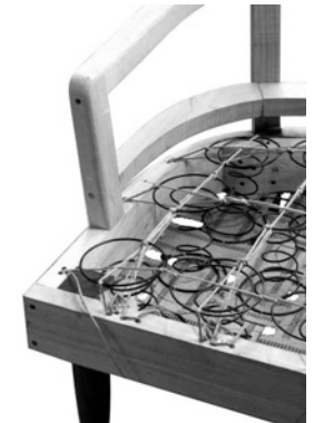
Εικόνα 15: Σούστες σε καρέκλα με μη ελαστικούς ιμάντες (jute webbing) κάτω και δέσιμο με σχοινί επάνω.
