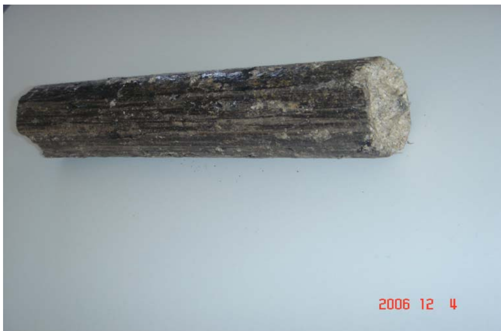
Εικ. 41. Πειραματική μπρικέτα που παράχθηκε στα πλαίσια του προγράμματος με μίξη από υπολείμματα κατεργασίας 50% ξύλου και 50% λιγνίτη.
