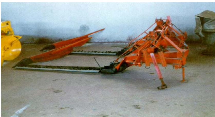
Εικ.20. Μηχάνημα κοπής τριφυλλιού με ενισχυμένα μαχαίρια κοπής
