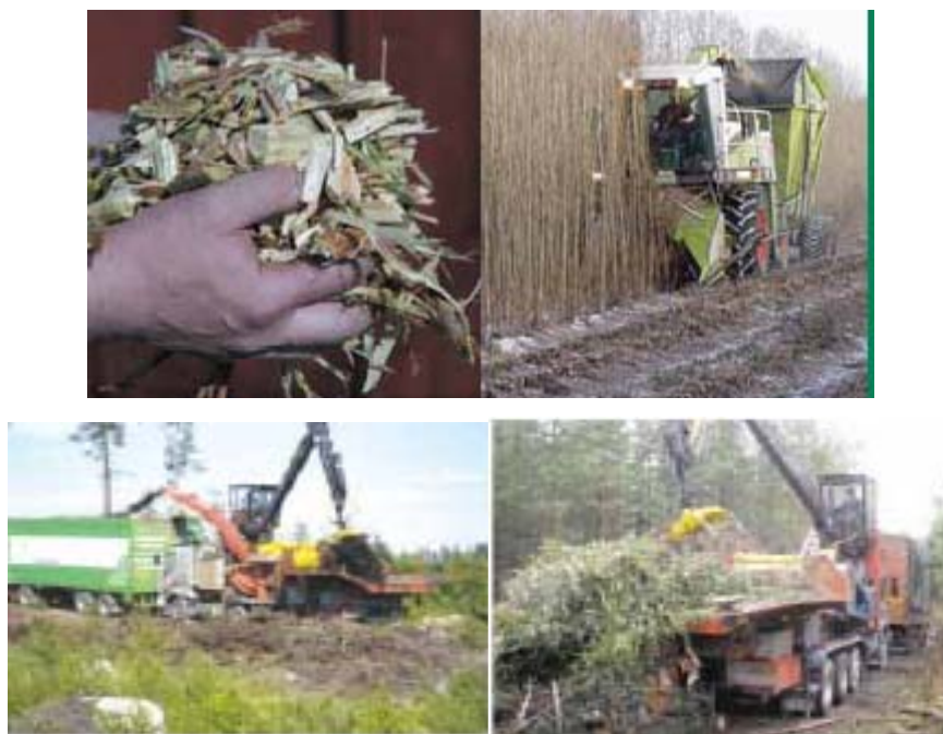
Εικόνα 45. Συλλογή και θρυμματισμός γεωργικών φυτών – δασικών υπολειμμάτων για την κατασκευή wood pellets.
