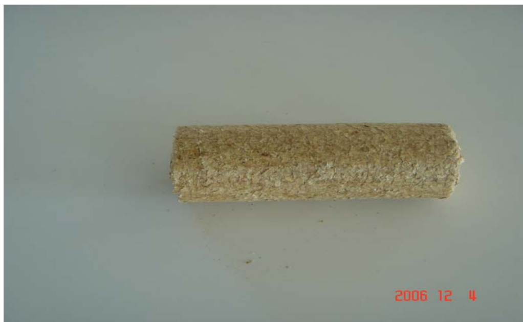
Εικ.42. Πειραματική μπρικέτα που παράχθηκε στα πλαίσια του προγράμματος με 50% ξύλο από υπολείμματα κατεργασίας και 50% καλαμπόκι.
