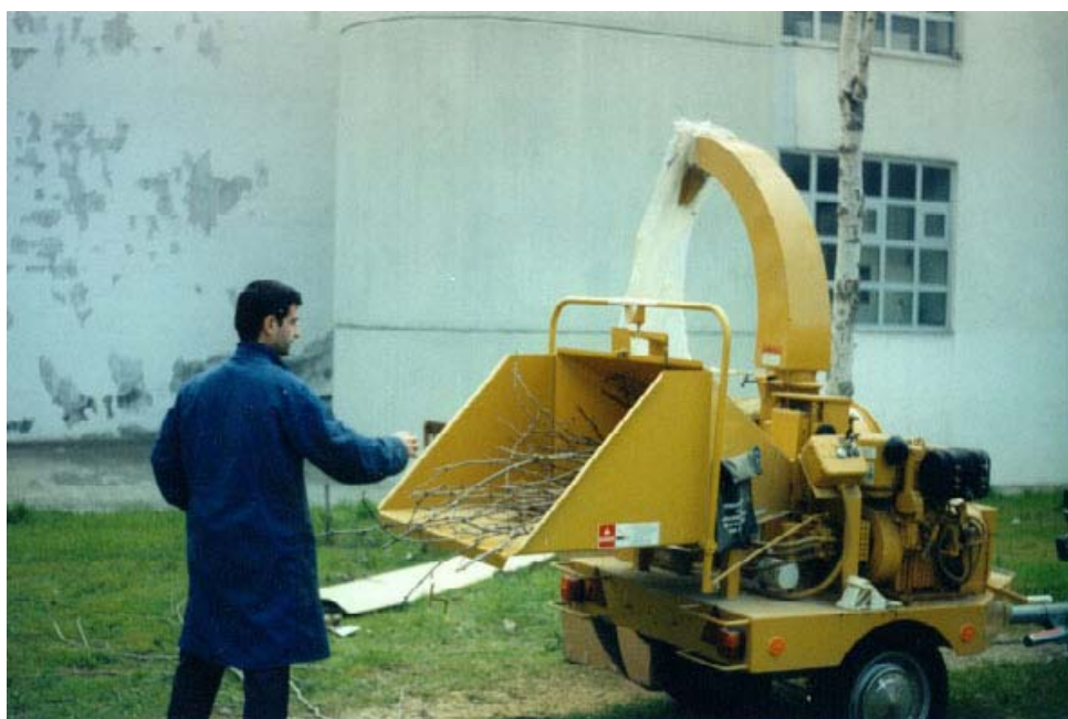
Εικ.27. Μηχανή θρυμματισμού τύπου Vermeer.
