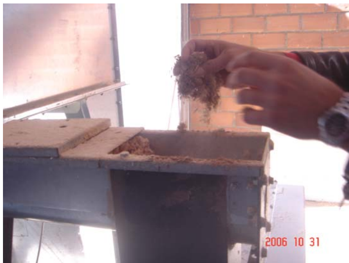
Εικ.35 Εισαγωγή θρυμματισμένων υπολειμμάτων στελεχών καλαμποκιού στην συσκευή μπρικετοποίησης
