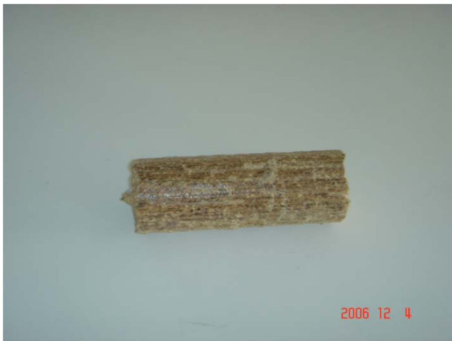
Εικ.43. Πειραματική μπρικέτα που παράχθηκε στα πλαίσια του προγράμματος με 50% ξύλο από υπολείμματα κατεργασίας και 50% υπολείμματα κατεργασίας βαμβακιού.
