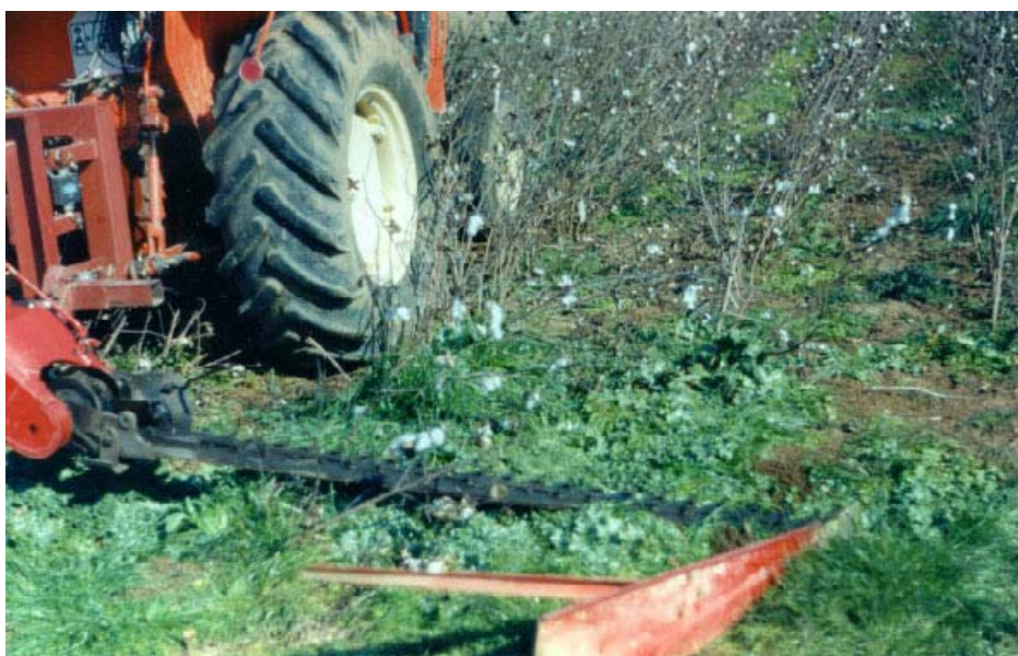
Εικ.21 . Μηχανή κοπής βαμβακιού σε λειτουργία με τη βοήθεια γεωργικού ελκυστήρα
