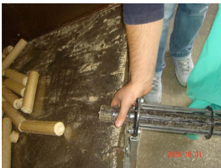
Εικ.37 Εξαγωγή των μπρικετών με ανάμιξη λιγνίτη από την μηχανή μπρικετοποίησης
