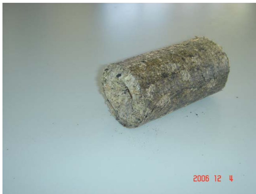
Εικ.44. Πειραματική μπρικέτα που παράχθηκε στα πλαίσια του προγράμματος με 50% ξύλο από υπολείμματα κατεργασίας και 50% ξυλάνθρακα.
