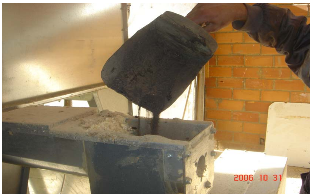
Εικ.34 Εισαγωγή θρυμματισμένου λιγνίτη στην συσκευή μπρικετοποίησης
