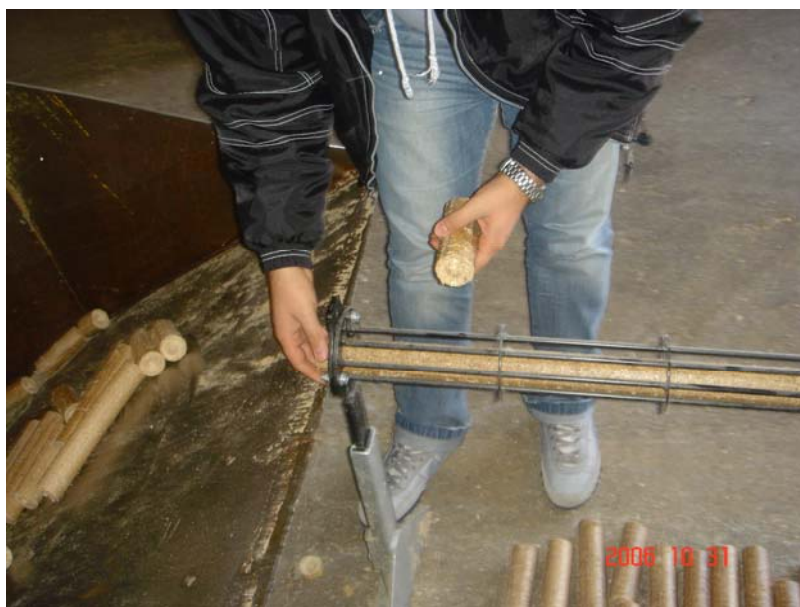
Εικ.36 Εξαγωγή των μπρικετών από την μηχανή μπρικετοποίησης
