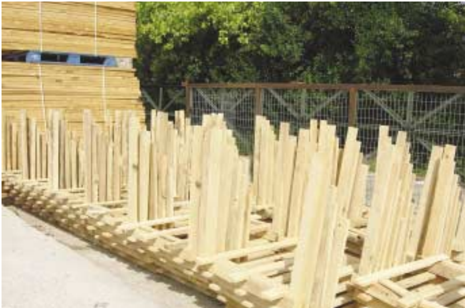
Ημιέτοιμα μέρη κιβωτίων που προορίζονται για θερμικό χειρισμό
