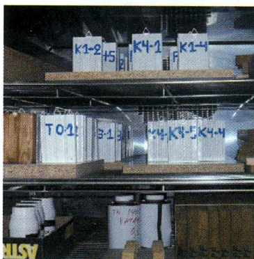
Εικ. 2: Προετοιμασία και κλιματισμός των δοκιμίων
