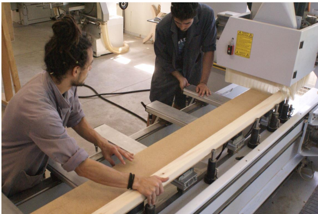
Εικόνα 97 Τοποθέτηση στο CNC
