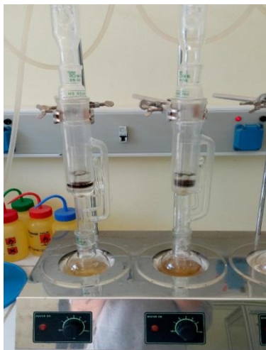
Εικόνα 24. Εκχύλιση με διαλύτη διγλωρομεθάνιου και δείγμα περιττώματα προβάτου.
