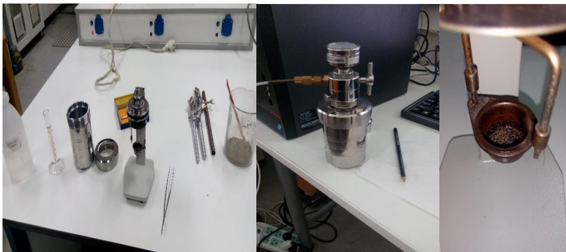
Εικόνα 27. Η διαδικασία εύρεσης της θερμιδικής αξίας
