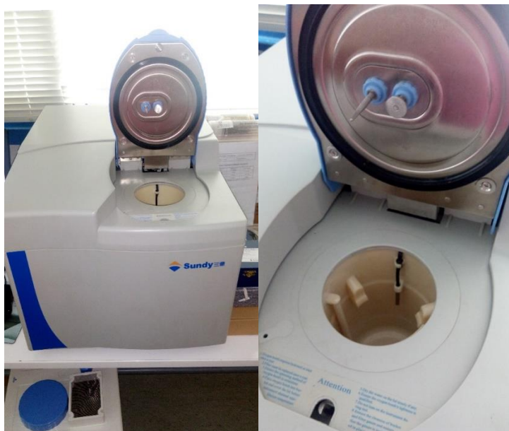
Εικόνα 28. Μηχάνημα το οποίο μετρά τη θερμидική αξία
