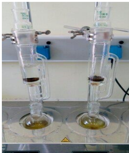
Εικόνα 25. Εκχύλιση με διαλύτη αλκοόλης και δείγμα περιττώματα προβάτου.
