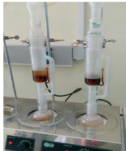
Εικόνα 26. Εκχύλιση με διαλύτη απιονισμένου νερού και δείγμα περιττώματα πτηνών.
