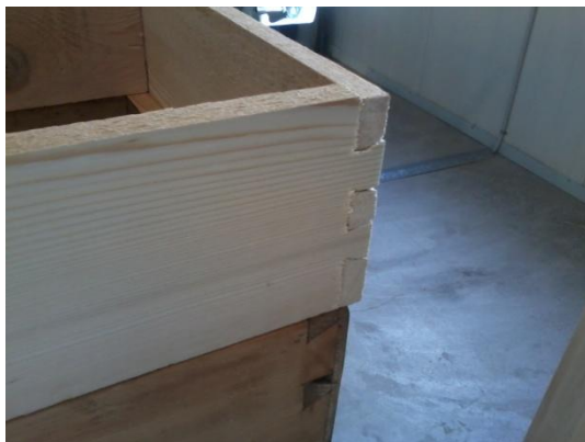
Εικόνα 80 Σύνδεσμος χελιδονοουρά στο συρτάρι
