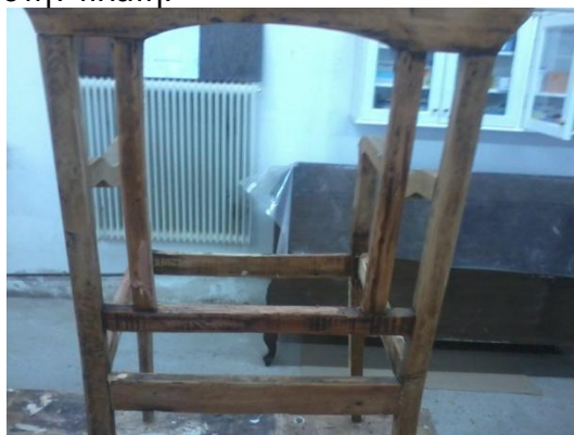
Εικόνα 103 Ανομοιομορφία στα δύο κάθετα στοιχεία της πλάτης
