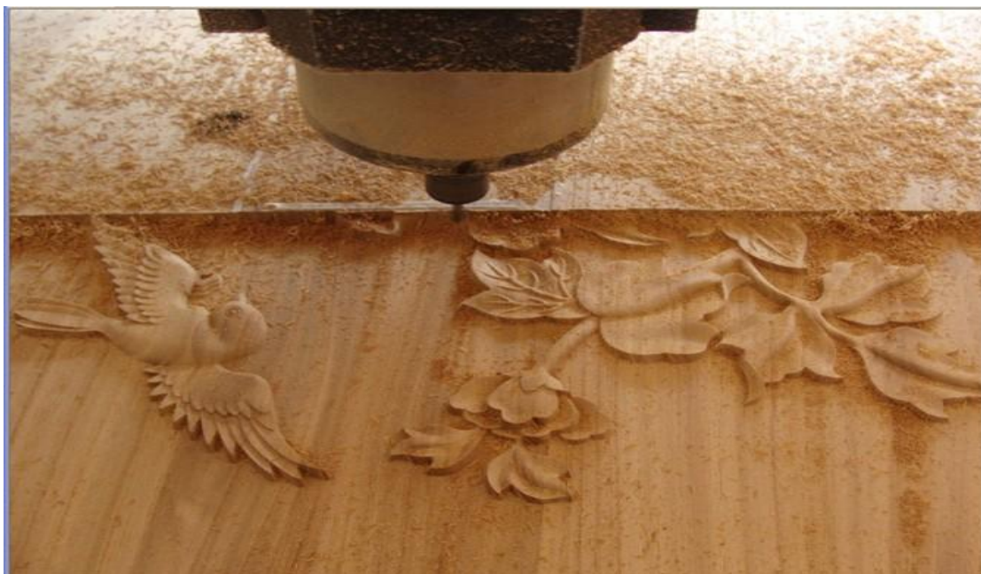
Εικόνα 37 Παραγωγή ξυλόγλυπτων με cnc
