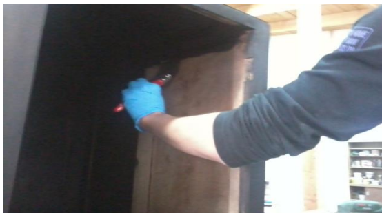
Εικόνα 74 Βάψιμο εσωτερικών τμημάτων πλαϊνών με πινέλο
