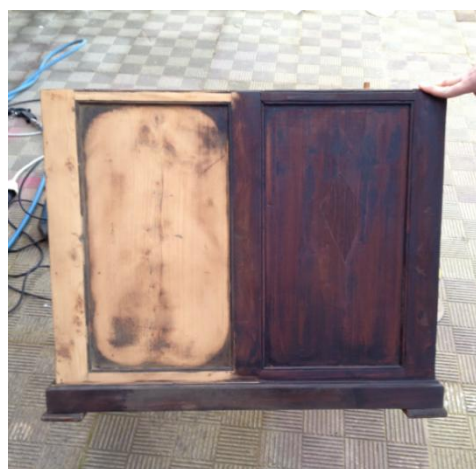
Εικόνα 55 Αποχαρτάρισμα και βαμμένη επιφάνεια
