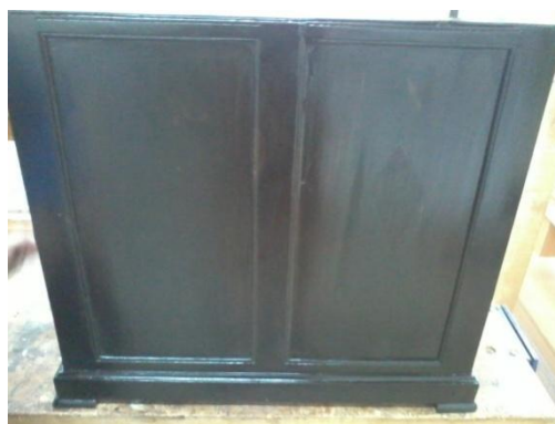
Εικόνα 101 Εφαρμογή δύο χεριών γομαλάκας
