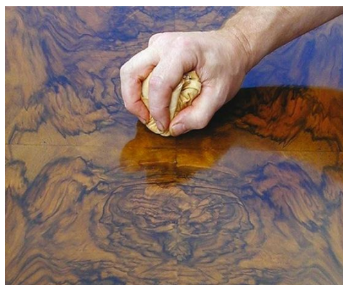
Εικόνα 32 Εφαρμογή γομαλάκας με τη μέθοδο μπάλας
