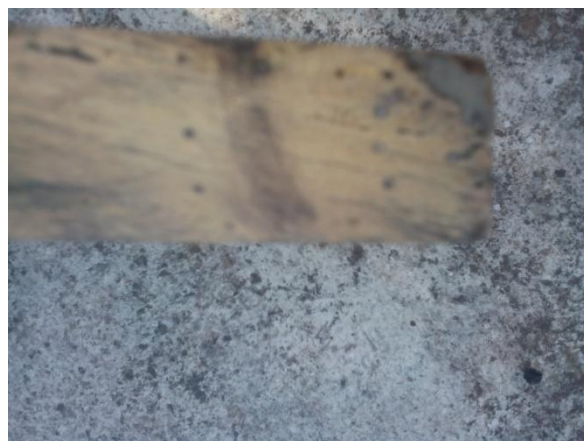
Εικόνα 91 Εμφάνιση προσβολής σε ένα από τα πολλά σημεία της καρέκλας
