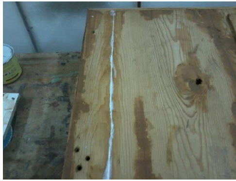
Εικόνα 66 Κόλληση πάτου επιφάνειας γραφείου
