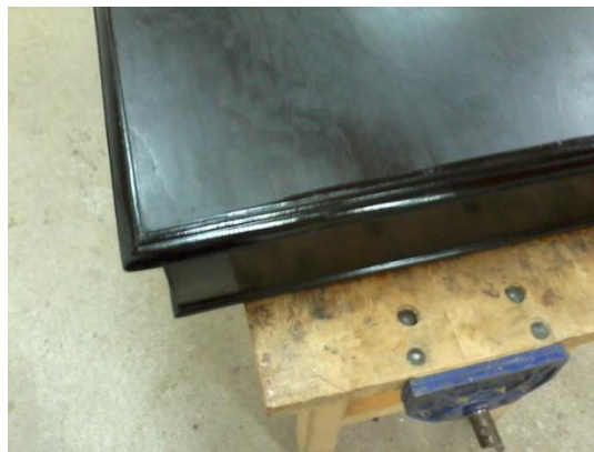
Εικόνα 78 Διαφορά γομαλάκας-βαφής νερού
