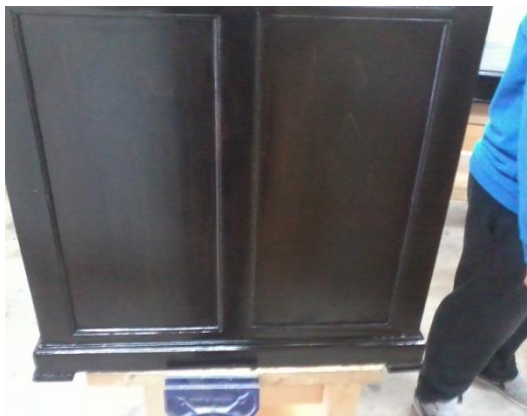
Εικόνα 79 Εφαρμογή τεσσάρων χεριών γομαλάκας
