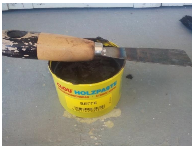
Εικόνα 101 Στόκος χρώματος Βέγγε για χρήση στην καρέκλα
