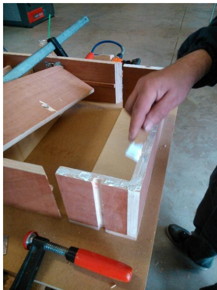
Εικόνα 139. Επάλειψη με ξυλόκολλα.
