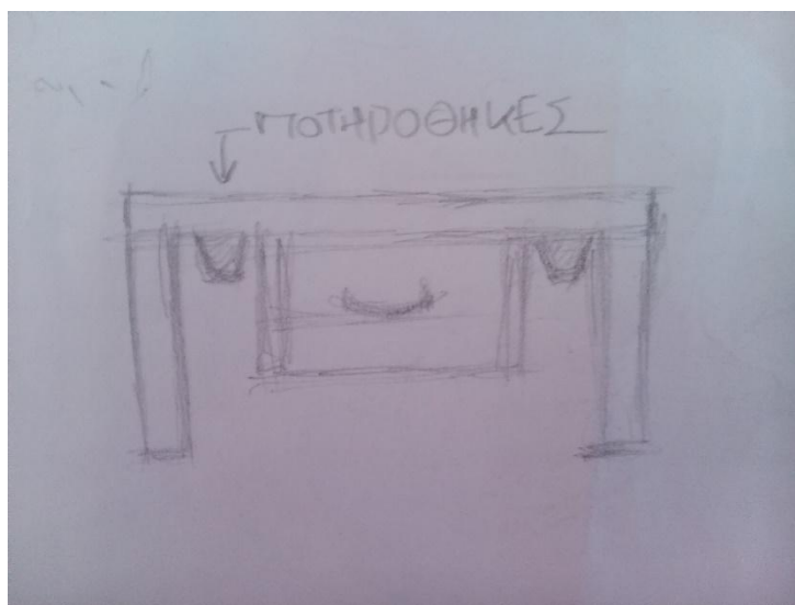
Εικόνα 46. Ξύλινο τραπεζάκι σταθερό στο έδαφος, με συρτάρι στη μέση και ποτηροθήκες αριστερά και δεξιά.
