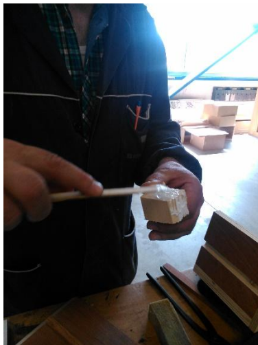
Εικόνες 135-136. Επάλειψη τάκου με κόλλα, τοποθέτηση στο σωστό σημείο και συγκράτηση με τη βοήθεια σφιγκτήρα.
