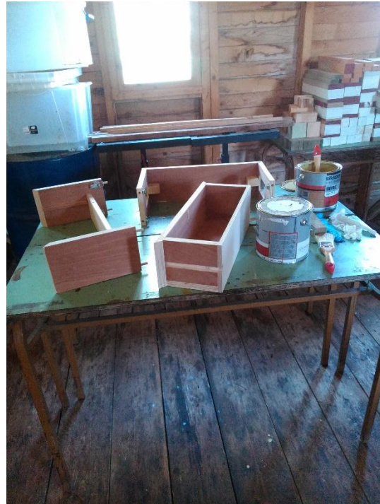
Εικόνα 146. Αποσυναρμολόγηση κατασκευής και προετοιμασία για βαφή.
