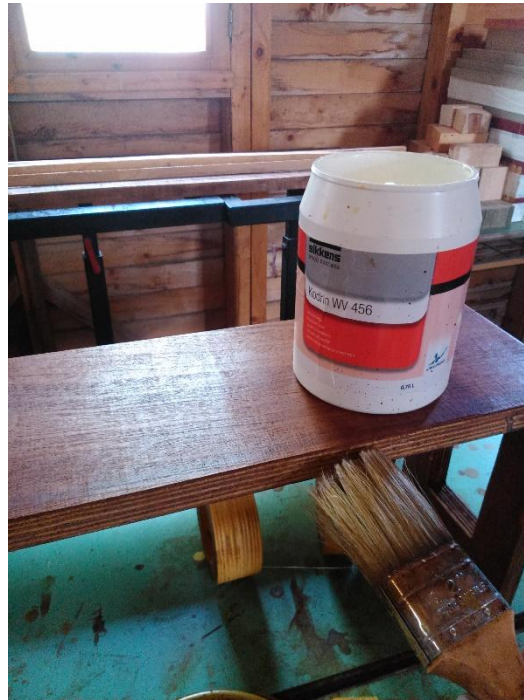
Εικόνα 148. Επάλειψη πλαϊνών με ειδική αλοιφή.
