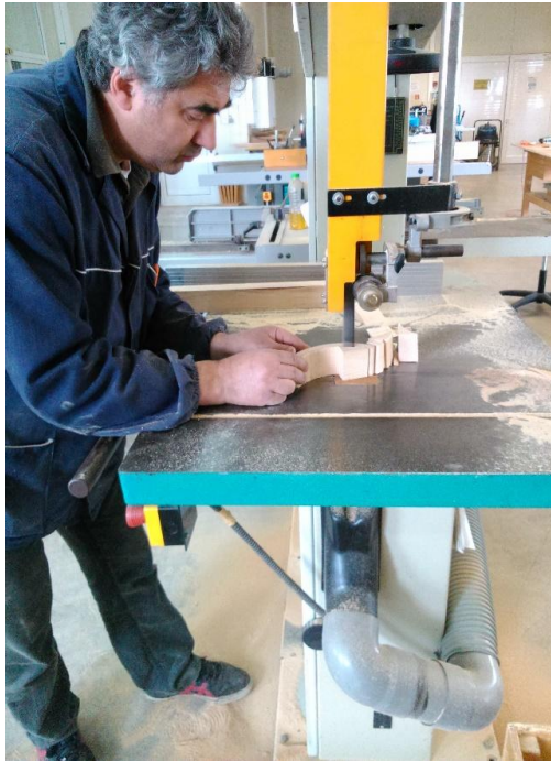
Εικόνες 107-126. Κοπή καμπύλου στοιχείου στον ταινιοπρίονα.
