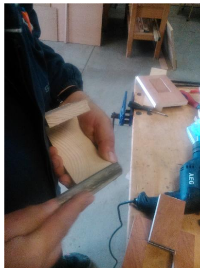
Εικόνα 128. Λιμάρισμα με ράσπα.
