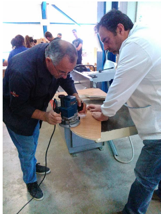
Εικόνα 144. Κατεργασία με φρέζα χειρός.
