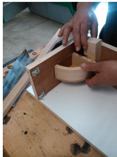
Εικόνες 135-136. Επάλειψη τάκου με κόλλα, τοποθέτηση στο σωστό σημείο και συγκράτηση με τη βοήθεια σφιγκτήρα.
