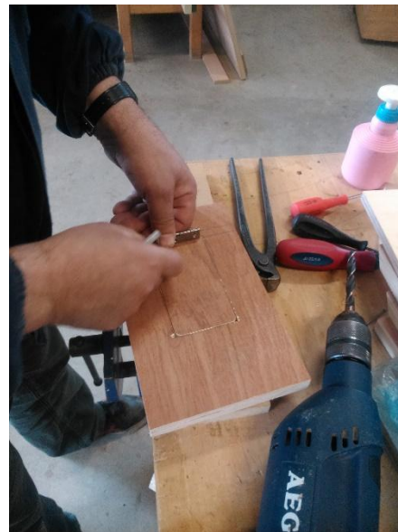
Εικόνα 121 Προσαρμογή με τη βοήθεια μεντεσέ.
