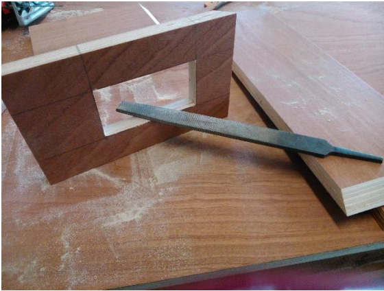
Εικόνα 118. Δημιουργία κενού ορθογωνίου με τη βοήθεια χειροπρίονου και ράσπας.
