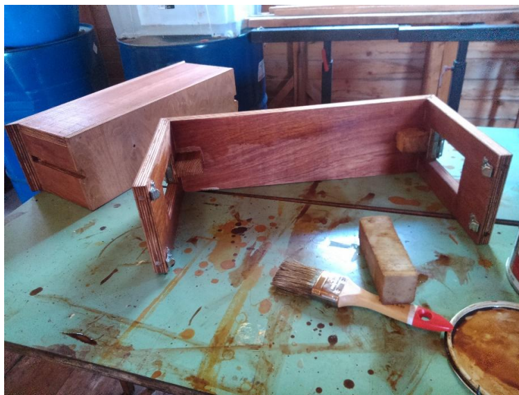
Εικόνα 147. Βαφή τεμαχίων με βερνίκι εξωτερικής χρήσης.
