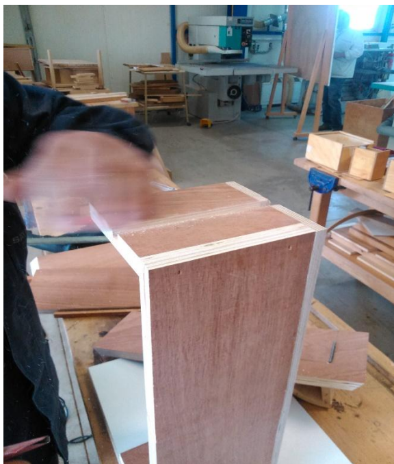
Εικόνα 114. Δημιουργία γκινισιάς στα πλαϊνά του συρταριού.
