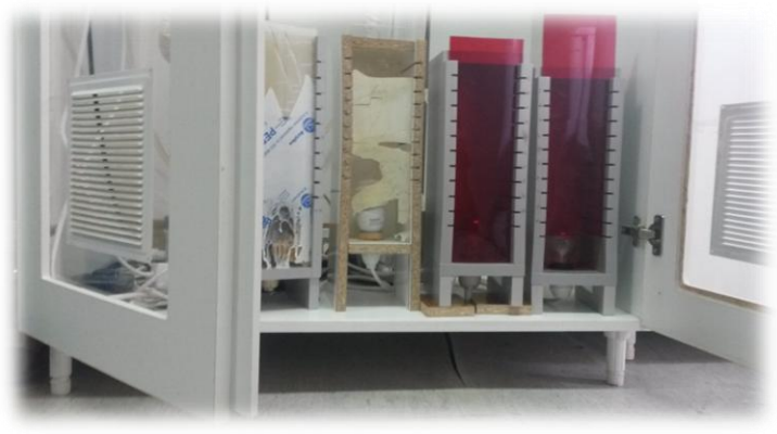
Εικόνα 14 Αριστερά: Μικροθάλαμος πειραμάτων. Κατασκευή από μοριοσανίδα, κλείσιμο με συρόμενο τζάμι. Στη βάση τοποθετήθηκε ντουί με καλώδιο που θα συνδεόταν ο λαμπτήρας. Δεξιά: Προκειμένου να διεξαχθούν τα πειράματα γρηγορότερα, κατασκευάστηκαν συνολικά τέσσερις μικροθάλαμοι. Στη συνέχεια το τζάμι αντικαταστάθηκε με Plexiglas καθώς οι υψηλές θερμοκρασίες είχαν αποτέλεσμα να ραγίζει.
