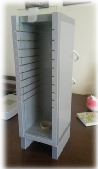
Εικόνα 14 Αριστερά: Μικροθάλαμος πειραμάτων. Κατασκευή από μοριοσανίδα, κλείσιμο με συρόμενο τζάμι. Στη βάση τοποθετήθηκε ντουί με καλώδιο που θα συνδεόταν ο λαμπτήρας. Δεξιά: Προκειμένου να διεξαχθούν τα πειράματα γρηγορότερα, κατασκευάστηκαν συνολικά τέσσερις μικροθάλαμοι. Στη συνέχεια το τζάμι αντικαταστάθηκε με Plexiglas καθώς οι υψηλές θερμοκρασίες είχαν αποτέλεσμα να ραγίζει.
