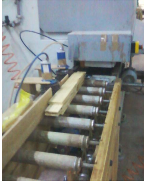
Εικ. 70. Μεταφορά στοιχείων με ράουλα.
