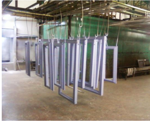
Εικ. 47. Κουφώματα μετά την βαφή
