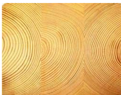
Εικ. 34. Διάταξη στρώσεων τριολλητού ξύλου
