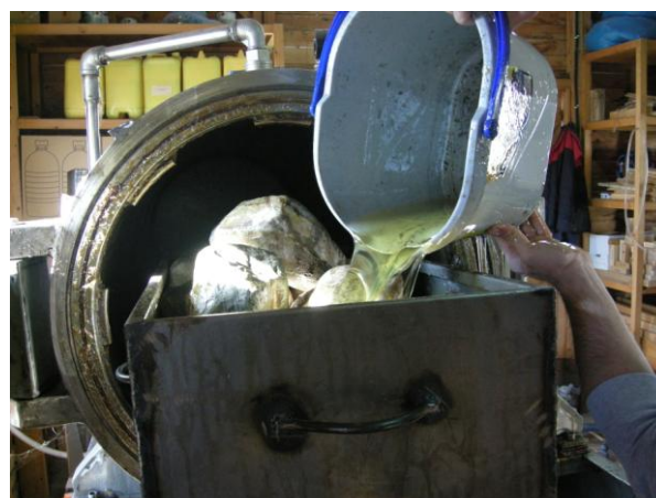
Εικ. 58. Πλήρωση της δεξαμενής με εμποτιστικό υγρό (κραμβέλαιο)
