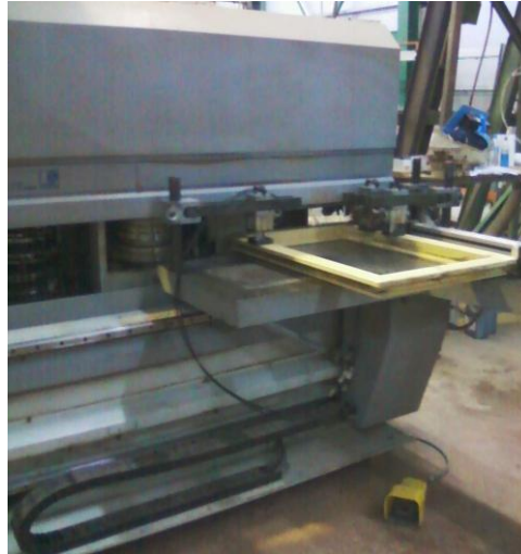
Εικ. 45. Τοποθέτηση παραθύρου για περιμετρικό προφίλ.
