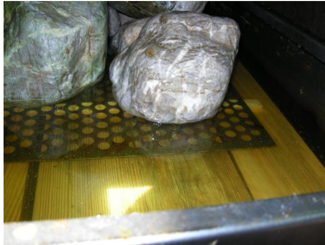
Εικ. 59. Τοποθέτηση δεξαμενής στον θάλαμο εμποτισμού
