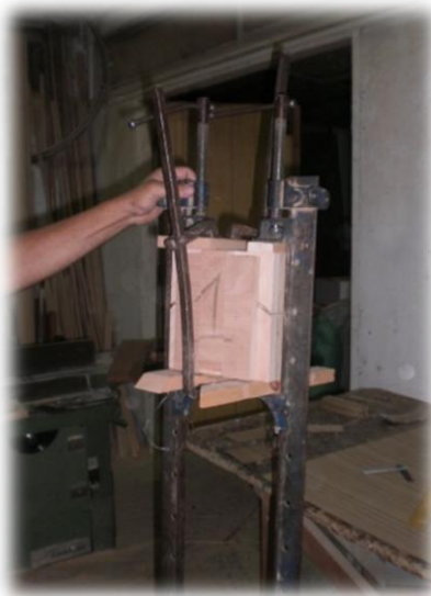
Εικόνα 33: Σταθεροποίηση καλουπιού με σφικτήρες
