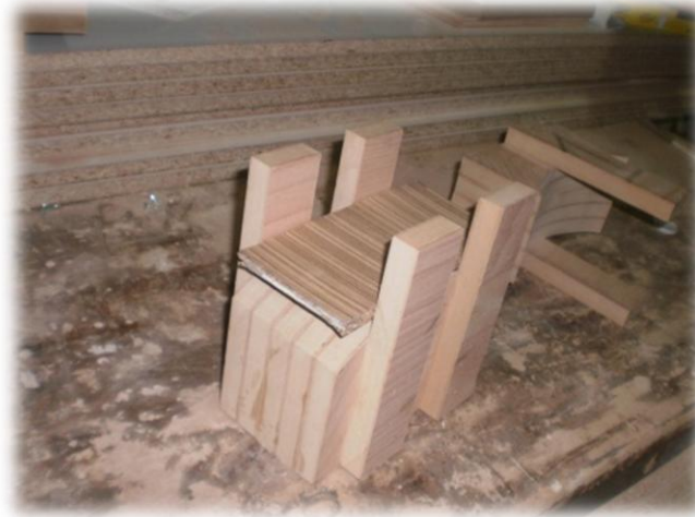
Εικόνα 30: Τοποθέτηση ξυλοφύλλων στο καλούπι
