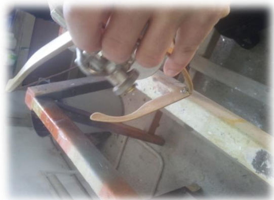
Εικόνα 54-55: Φινίρισμα με πιστόλι αέρος.
