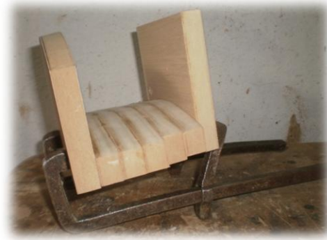
Εικόνα 25:Συγκόλληση και πρεσάρισμα.
