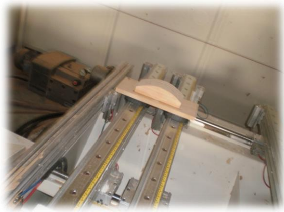
Εικόνα 36: Τοποθέτηση καλουπιού στη πλάκα της CNC
