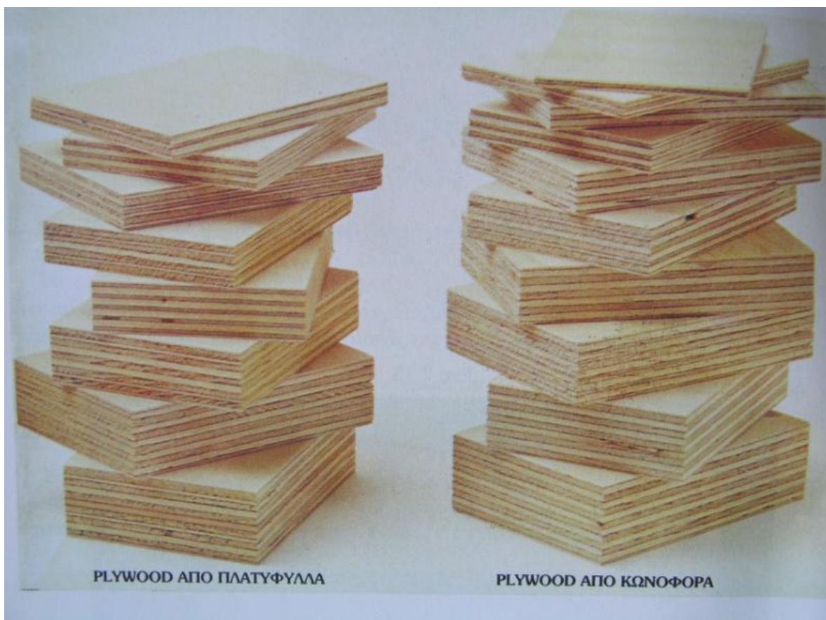
Εικόνα 8: Αντικολλητό ξύλο σε διάφορα πάχη από κωνοφόρα και πλατύφυλλα
