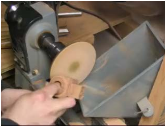
Εικόνα 4.9 : Μορφοποίηση ξυλοτεμάχιου στον τριβέα.
