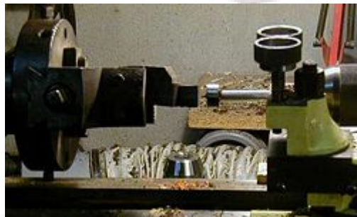
Εικόνα 5.1.8: τοποθέτηση στον τόρνο.
