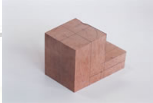
Εικόνα 4.5.: Τετραγωνισμένο τεμάχιο με σχεδιασμένες τις απαραίτητες γραμμές για την κατεργασία
