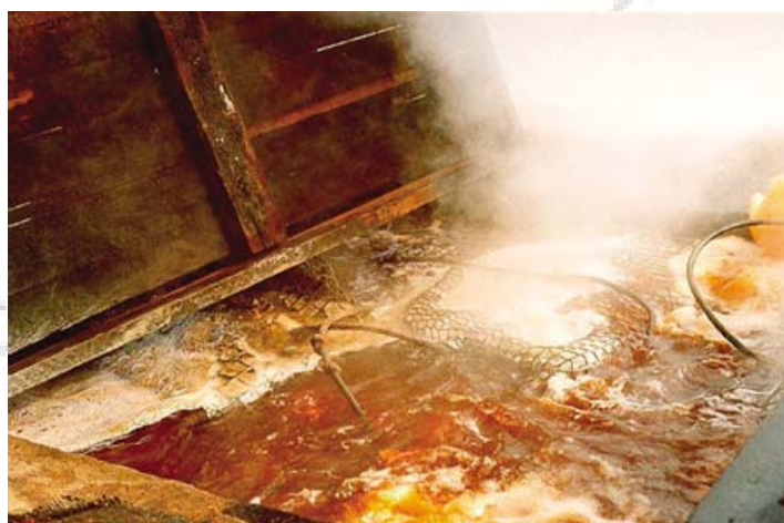
Εικόνα 4.2.: Διαδικασία βρασμού ριζών ρεικιού
