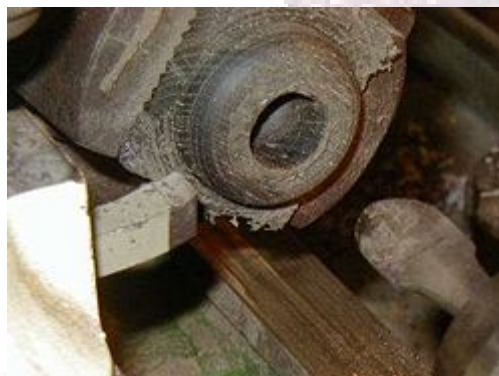
Εικόνα 5.1.10: Διαδικασία διάνοιξης της οπής του αέρα.
