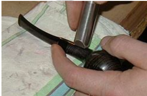
Εικόνα 5.1.13: σφράγιση της καπνοσύριγγας
