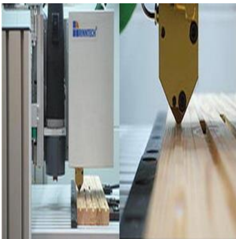
Εικόνα 20: Όργανο μέτρησης πλάτους αυξητικών δακτυλίων LIGNOSTATION (Πηγή http://www.ictinternational.com/ , 2015)
