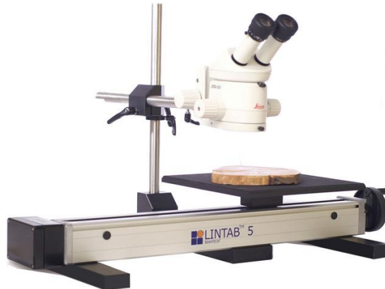
Εικόνα 19: Όργανο μέτρησης πλάτους αυξητικών δακτυλίων LINTAB. (Πηγή http://www.ictinternational.com/ , 2015 )
