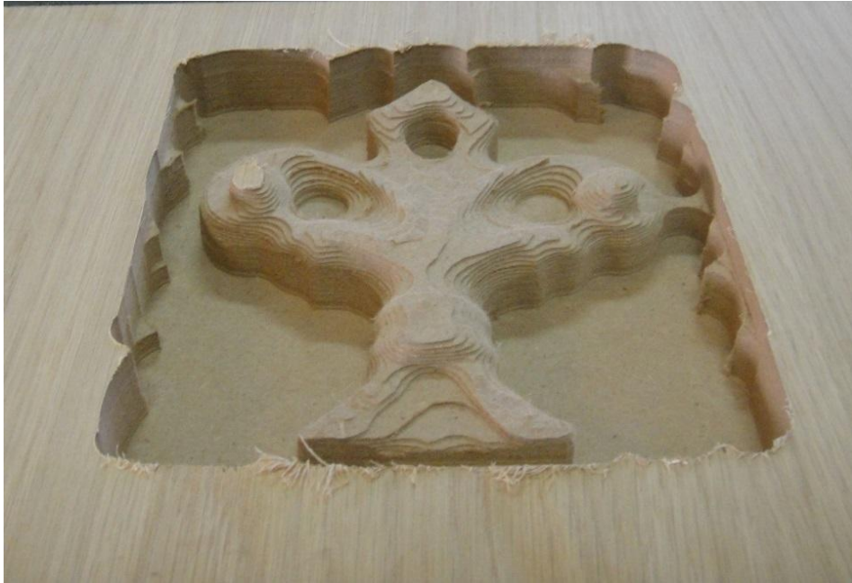
Εικόνα 11. 42 Τελικό αποτέλεσμα της κατεργασίας του Ξεχονδρίσματος σε MDF.
