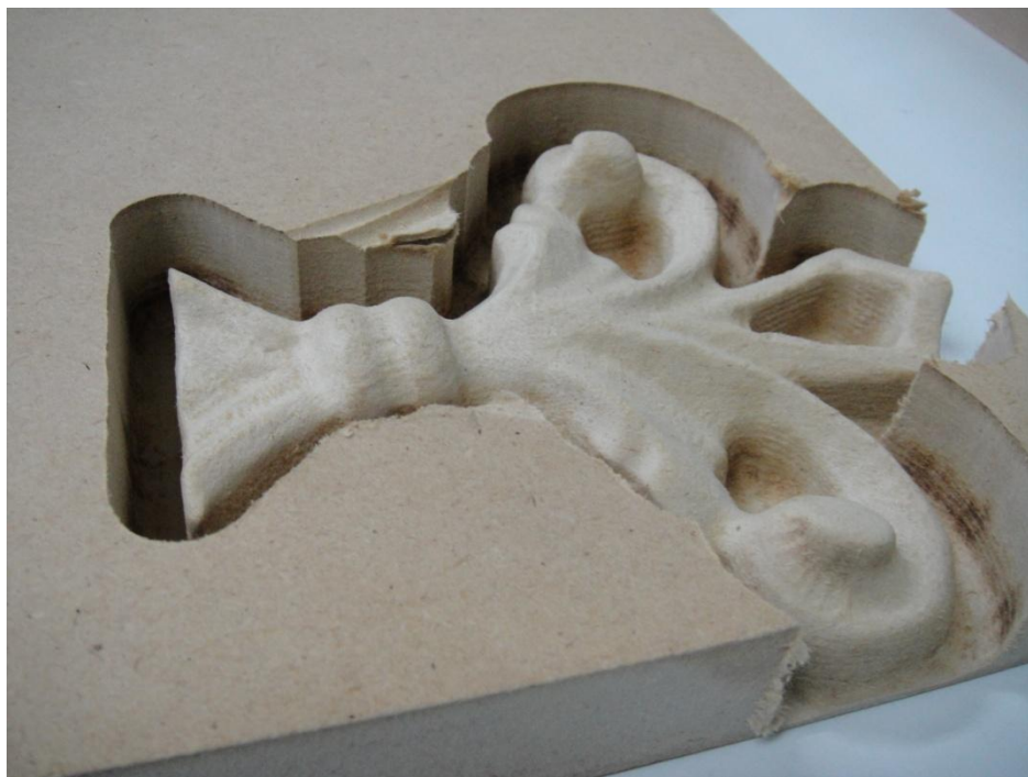
Εικόνα 11. 45 Τελικό αποτέλεσμα της κατεργασίας του Φινιρίσματος σε MDF.
