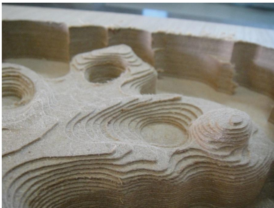
Εικόνα 11. 41 Βλέπουμε το αποτέλεσμα της βηματικής βύθισης (Cut Increment 1mm) που αφήνει το κοπτικό κατά την κατεργασία του Ξεχονδρίσματος.
