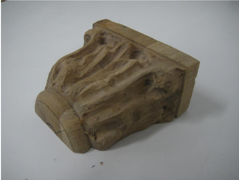
Εικόνα 11. 47 Ξυλόγλυπτο μετά από κατεργασία σε παντογράφο: οι λεπτομέρειες δεν μπορεί να αποδοθούν ικανοποιητικά.
