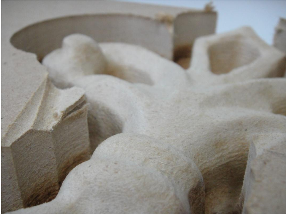
Εικόνα 11. 44 Τελικό αποτέλεσμα της κατεργασίας του Φινιρίσματος σε MDF.
