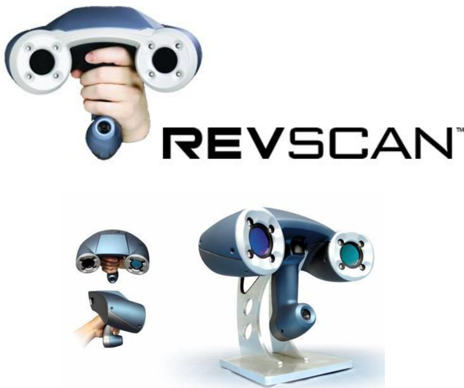
Εικόνα 11. 1 Ο φορητός ψηφιακός σαρωτής REVSCAN που χρησιμοποιήθηκε για τη σάρωση του αντικειμένου.
