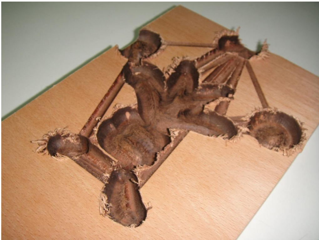
Εικόνα 11. 46 Απευθείας κατεργασία φινιρίσματος σε ξύλο οξιάς
