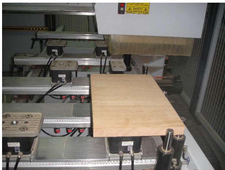
Εικόνα 11. 39 Τοποθέτηση του προς επεξεργασίας τεμαχίου στην τράπεζα εργασίας.
