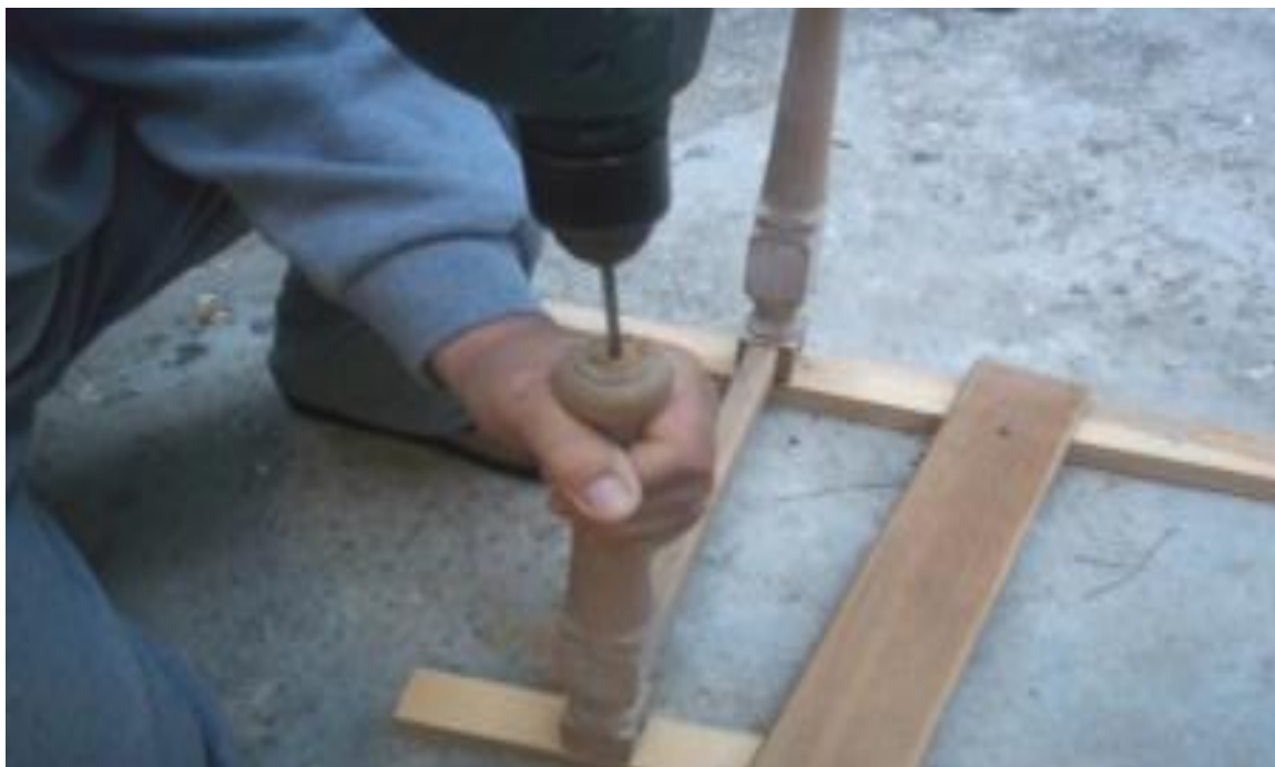
Εικόνα 3.26 Οπή με τρυπάνι χειρός στην κάτω πλευρά για την προσθήκη ξυλόβιδας
