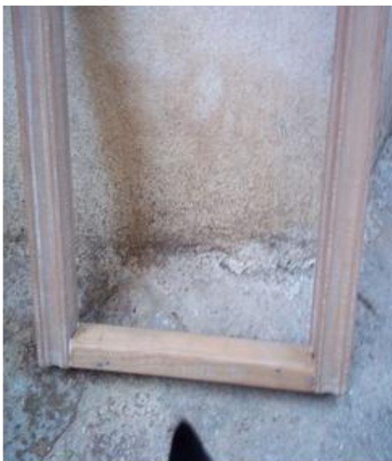
Εικόνες 3.16, 3.17 Κλείσιμο πλαισίου πλάτης με περισσευούμενη τραβέρσα καθίσματος. Σύνδεση με καβίλιες και ξυλόκολλα
