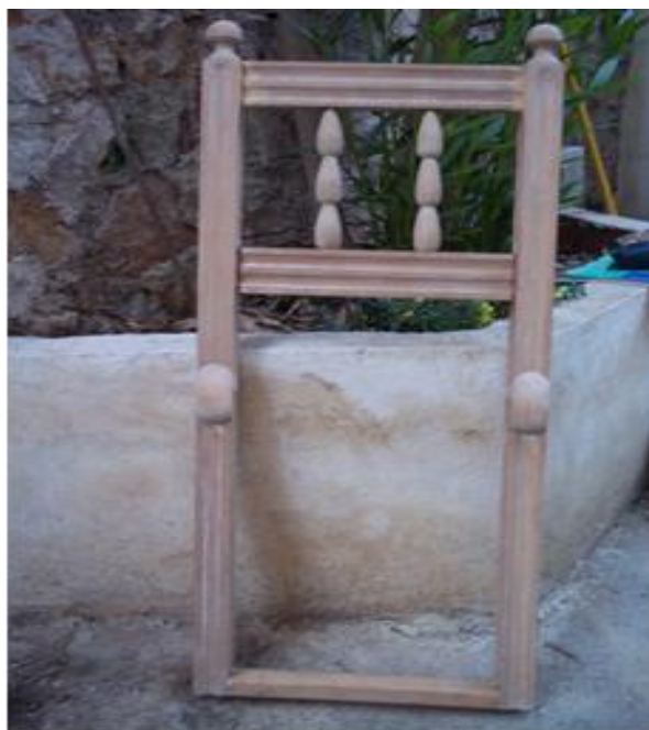
Εικόνες 3.16, 3.17 Κλείσιμο πλαισίου πλάτης με περισσευούμενη τραβέρσα καθίσματος. Σύνδεση με καβίλιες και ξυλόκολλα
