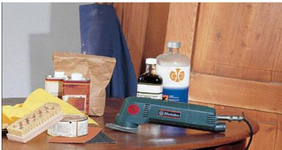
Εικόνα 2.3 Εργαλεία και υλικά φινιρίσματος ( www.mastoremata.gr )
