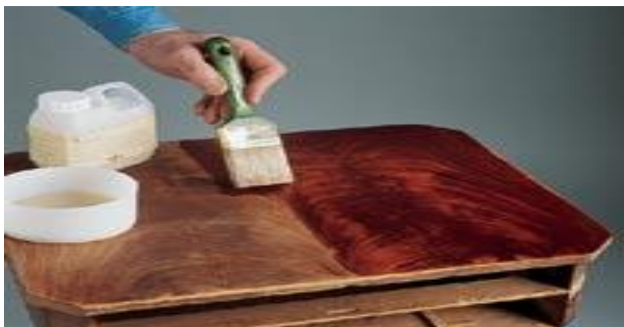
Εικόνα 2.8 Επάλειψη με ξυλοβαφή ( www.bioblast.gr )
