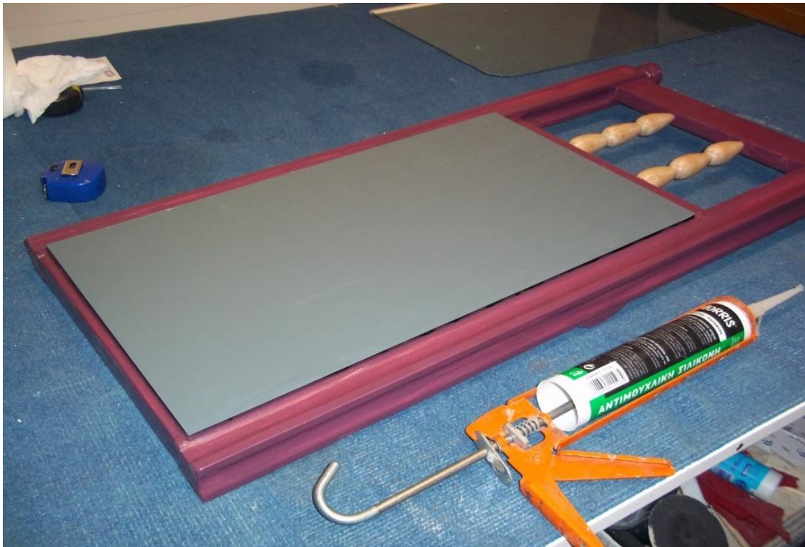
Εικόνα 3.20 Τοποθέτηση καθρέπτη, συγκόλληση με σιλικόνη
