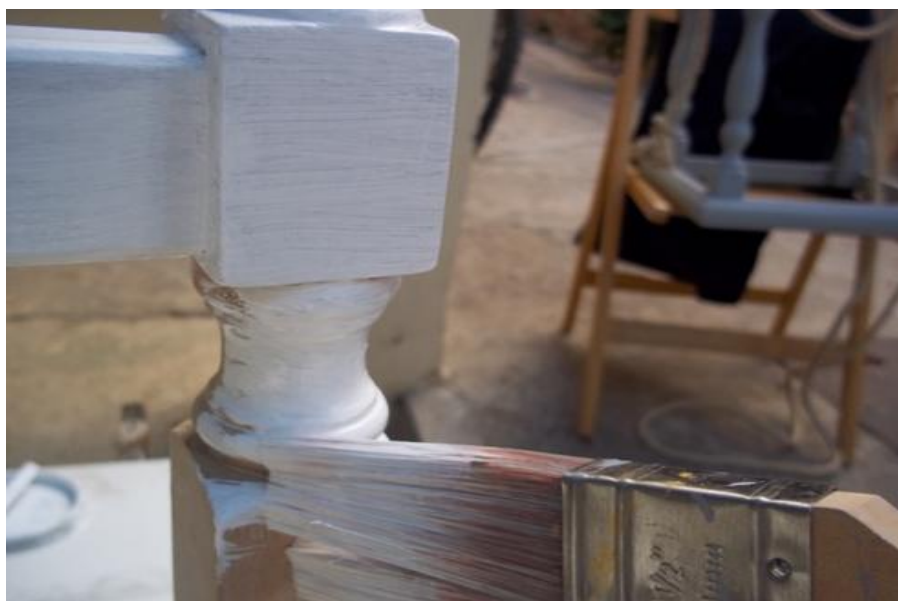
Εικόνα 3.31 Βάψιμο με ριπολίνη νερού (2 ο πέρασμα)
