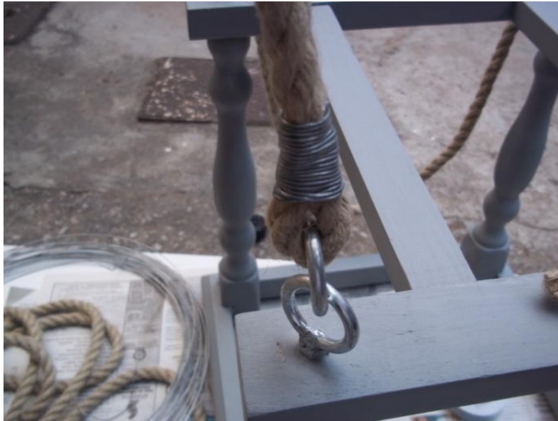
Εικόνα 3.51 Ολοκλήρωση δεσμού με ατσαλόσυρμα
