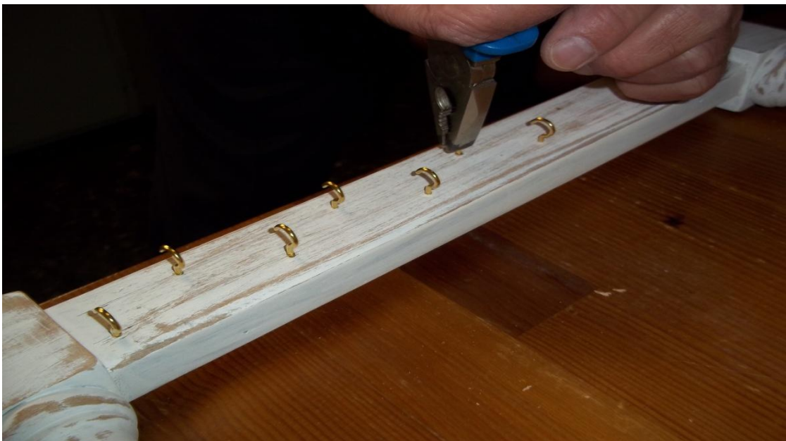
Εικόνα 3.36 Τοποθέτηση μεταλλικών γάντζων
