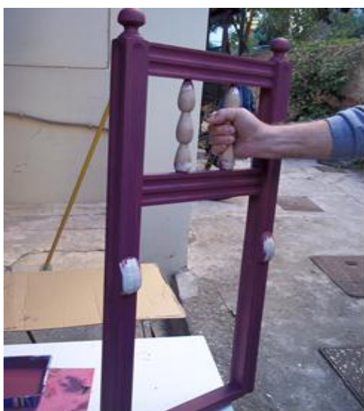
Εικόνες 3.18, 3.19 Πέρασμα πρώτο χέρι με αστάρι. Τρίφτηκε ελαφρά όπου μετά το στέγνωμα ακολούθησε το βάνιμο με ριπολίνη νερού, απόχρωση βυσσινί. Τέλος ακολουθεί υδατοδιαλυτό προστατευτικό βερνίκωμα με σατινέ εμφάνιση
