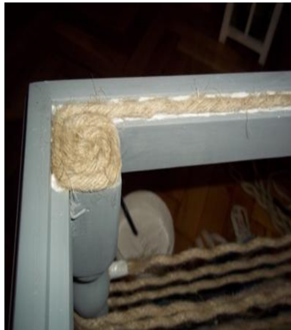
Εικόνα 3.53 Ολοκλήρωση τοποθέτησης κανναβόσχοινου
