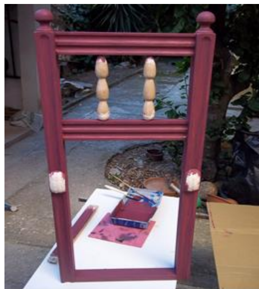
Εικόνες 3.18, 3.19 Πέρασμα πρώτο χέρι με αστάρι. Τρίφτηκε ελαφρά όπου μετά το στέγνωμα ακολούθησε το βάνιμο με ριπολίνη νερού, απόχρωση βυσσινί. Τέλος ακολουθεί υδατοδιαλυτό προστατευτικό βερνίκωμα με σατινέ εμφάνιση
