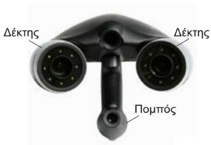
Εικόνα 3.4. Φορητή συσκευή τρισδιάστατου σαρωτή ακτίνων laser.
