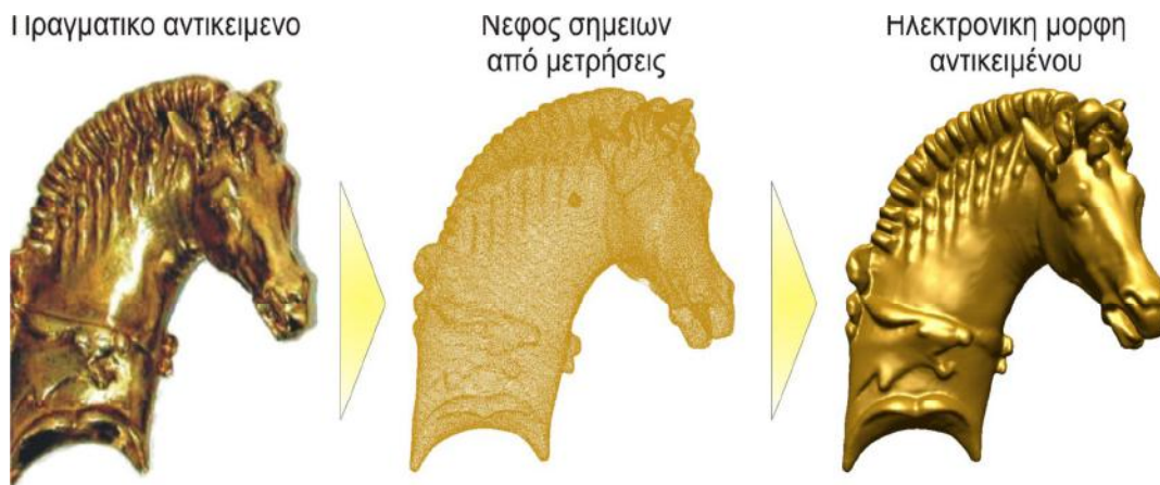
Εικόνα 3.1. Απόκτηση ψηφιακής μορφής αντικειμένου από το πρωτότυπο φυσικό αντικείμενο μέσω τεχνικών αντίστροφης μηχανολογίας.
