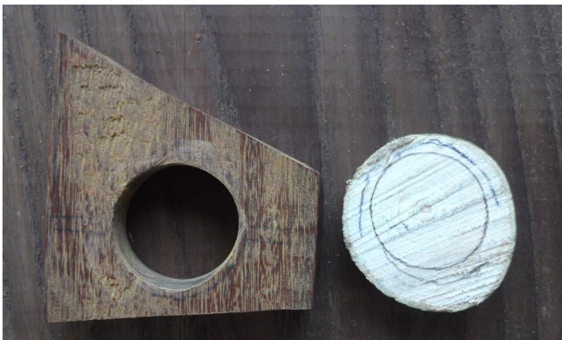
Σχεδιασμός κύκλου πάνω στο σόκορο με χρήση κυρίως σώματος σαν οδηγό.
