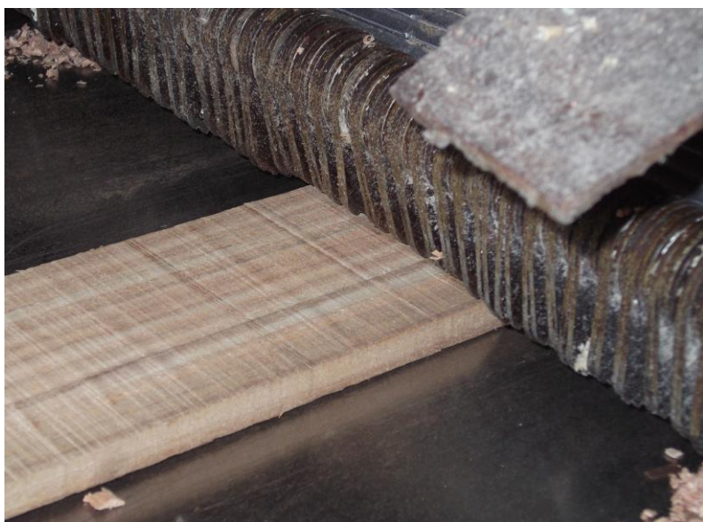
Ξεχόνδρισμα σε ξεχονδριστήρα. Τελικό πάχος 15 mm
