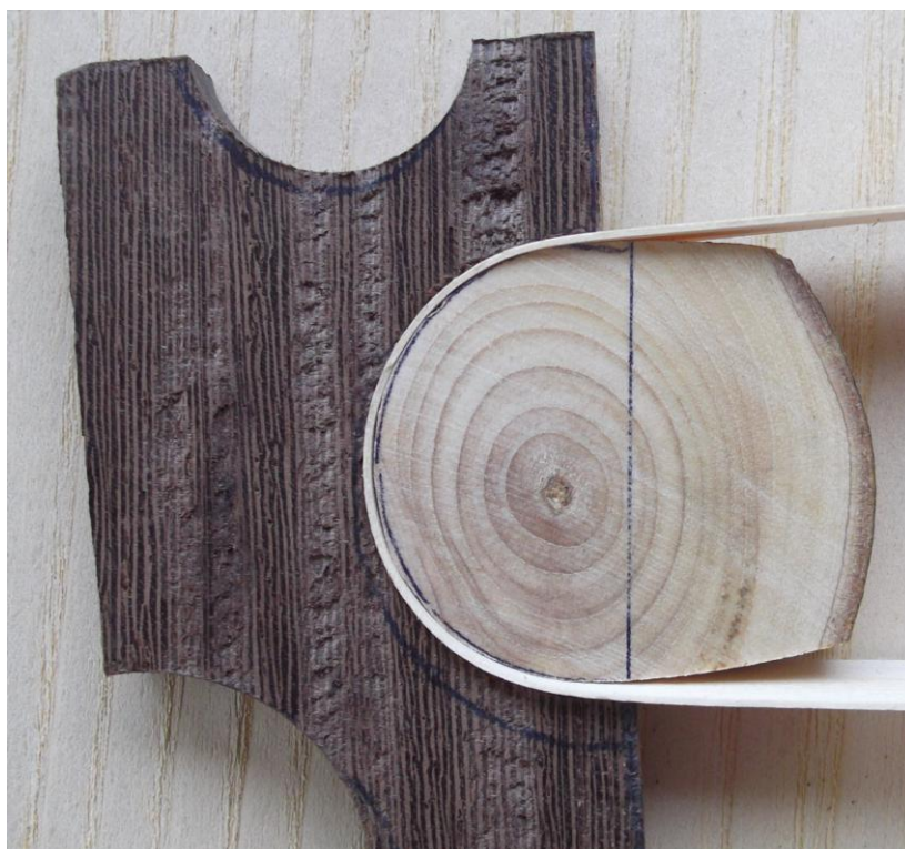
Τοποθέτηση ξυλοφύλλων ενδιάμεσα από το κυρίως σώμα και τα σόκορα
