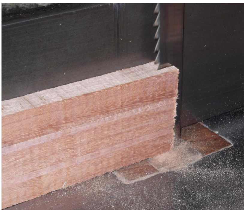
Ξεχόνδρισμα σε ταινιοπρίονα με υπερδιάσταση 6 mm
