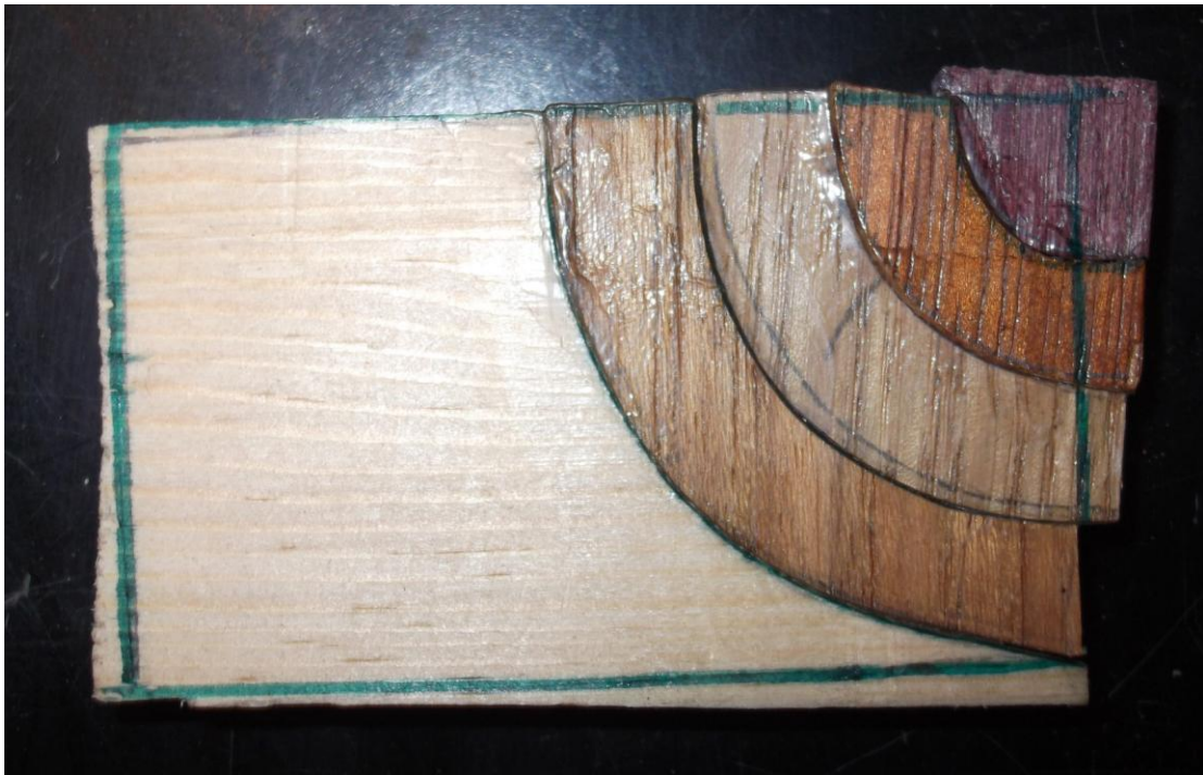
Ορισμός τελικών διαστάσεων. Σχεδιασμός των τμημάτων που θα αφαιρεθούν κατά το τρίψιμο.
