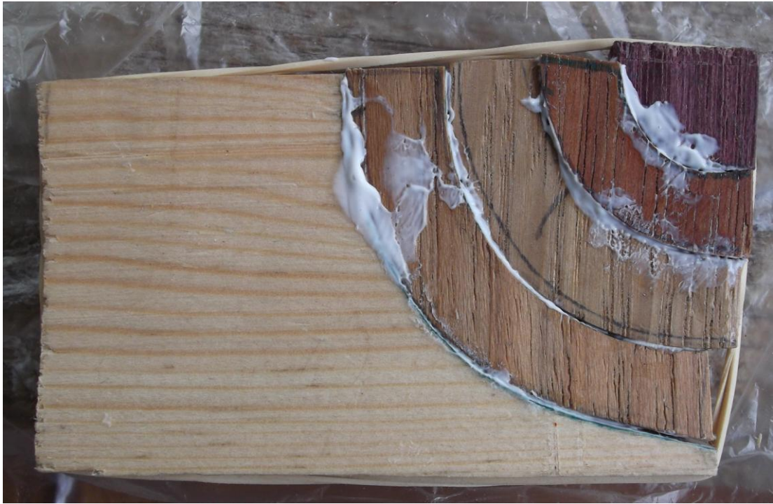
Συγκόλληση και συγκράτηση με τη χρήση ελαστικού ιμάντα
