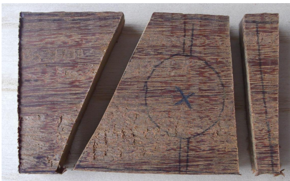
Κοπή των τμημάτων με τη χρήση επιτραπέζιας σέγας
