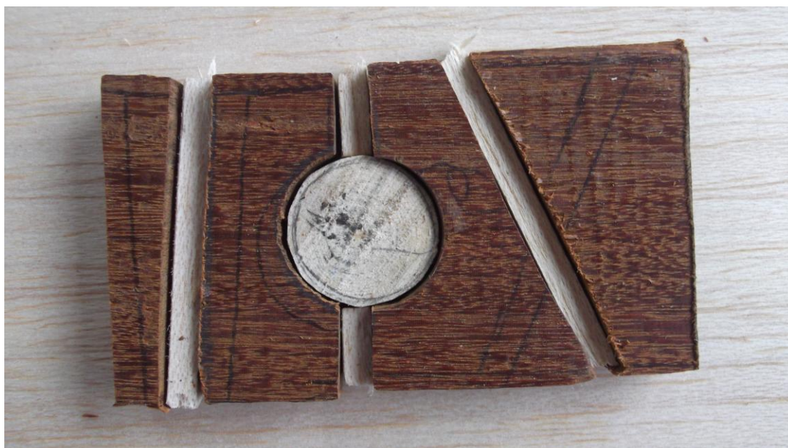
Τοποθέτηση Balsa στα ενδιάμεσα κενά και πρόχειρη συναρμολόγηση
