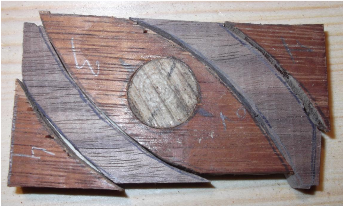
Κοπή επιμέρους τμημάτων με τη χρήση επιτραπέζιας σέγας και πρόχειρη συναρμολόγηση.
