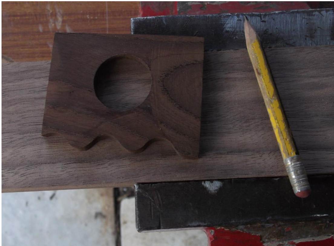
Σχεδιασμός δεύτερου τμήματος με χρήση του σώματος σαν οδηγό για τις καμπύλες
