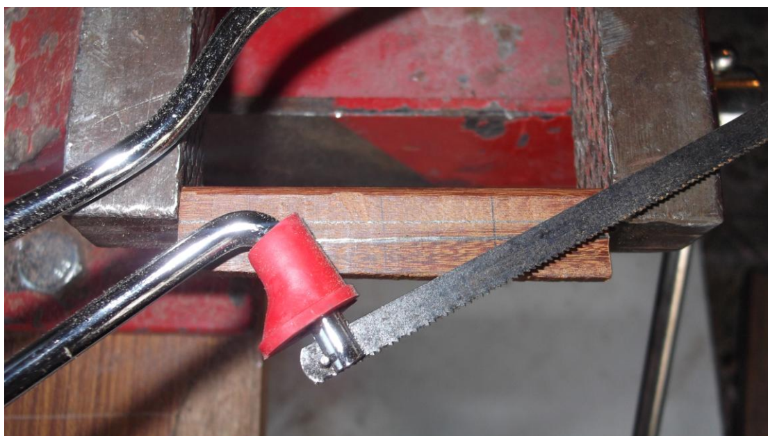
Σχεδιασμός και κοπή τρίτου τμήματος με πριονάκι χειρός
