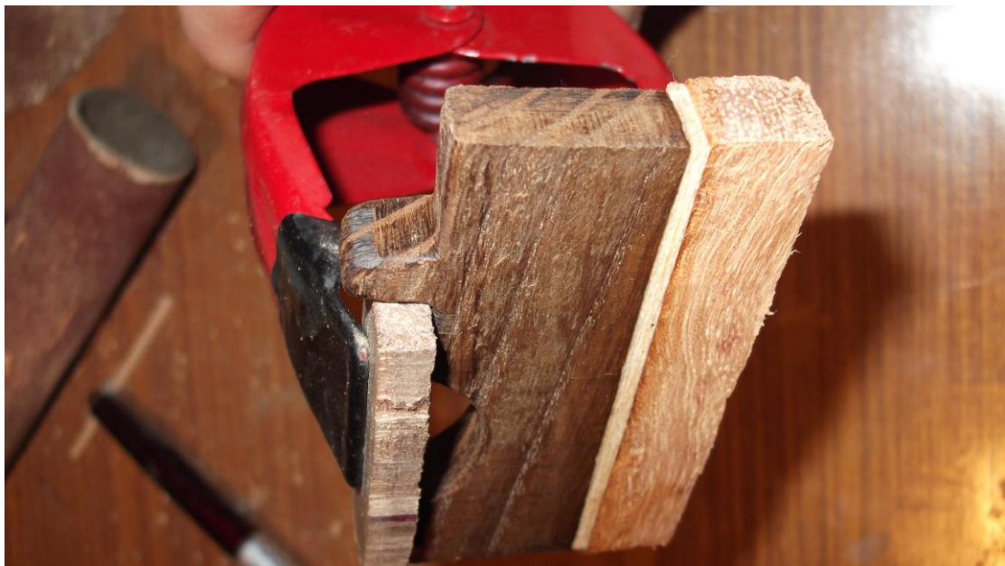
Συγκόλληση τμημάτων και συγκράτηση αυτών με χρήση σφιγκτήρα (τοποθέτησα βοηθητικά ξυλάκια στις άκρες για να μην προκληθούν χαρακιές και βαθουλώματα από την πίεση)
