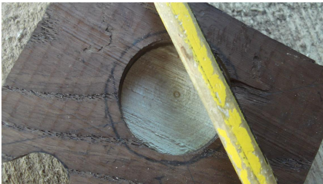
Σχεδιασμός κύκλου πάνω στο σόκορο με χρήση του σώματος σαν οδηγό
