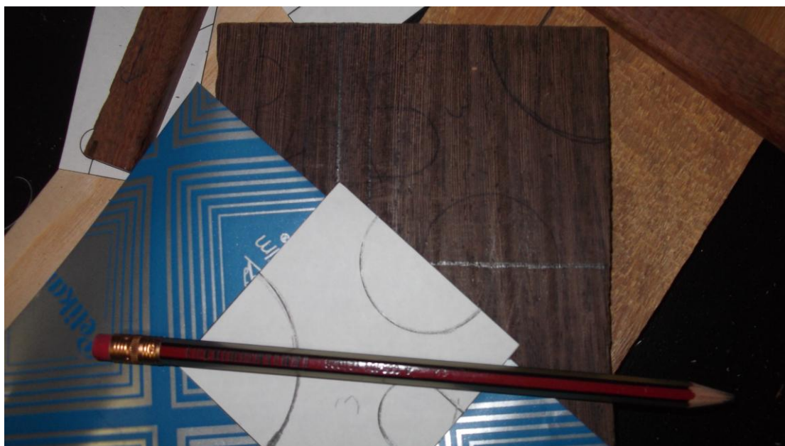
Σχεδιασμός κυρίως σώματος πάνω στο ξύλο με τη χρήση καρμπόν
