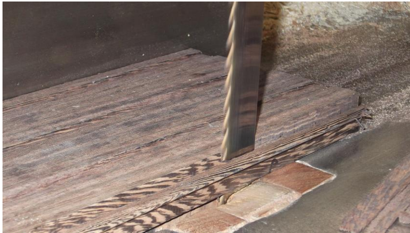
Ξεφάρδισμα σε ταινιοπρίονα για να φύγουν οι προεξοχές και οι εσοχές των πλακών
