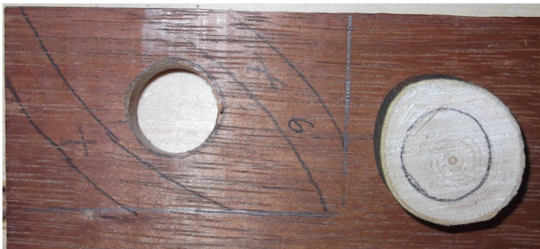
Σχεδιασμός κύκλου στο σόκορο με χρήση κυρίως σώματος σαν οδηγό.
