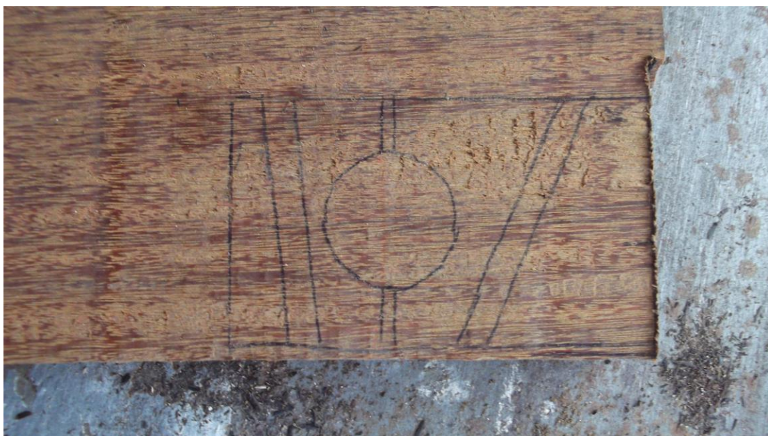
Σχεδιασμός των τμημάτων πάνω στα ξύλα με τη χρήση καρμπόν
