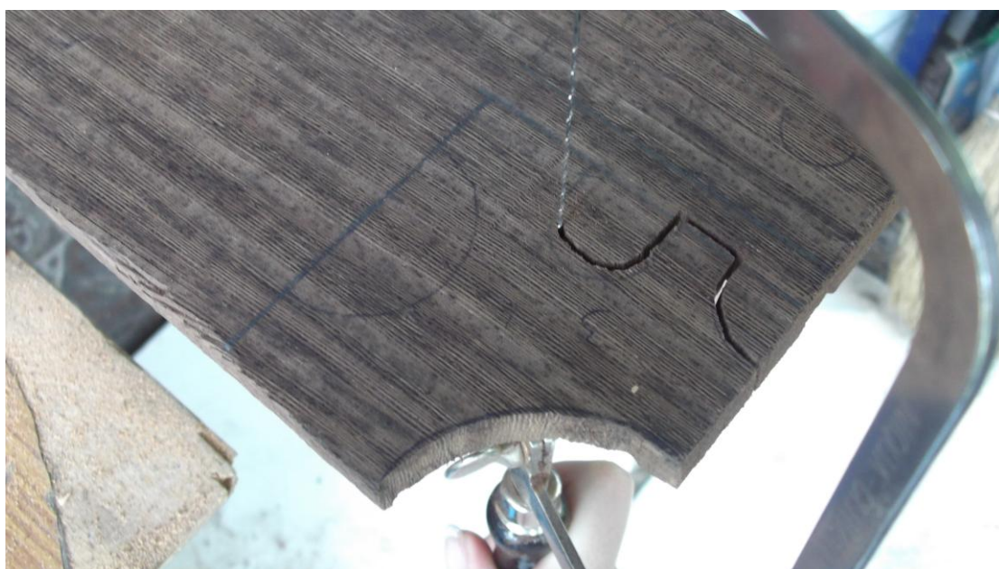
Κοπή κυρίως σώματος με πριονάκι χειρός
