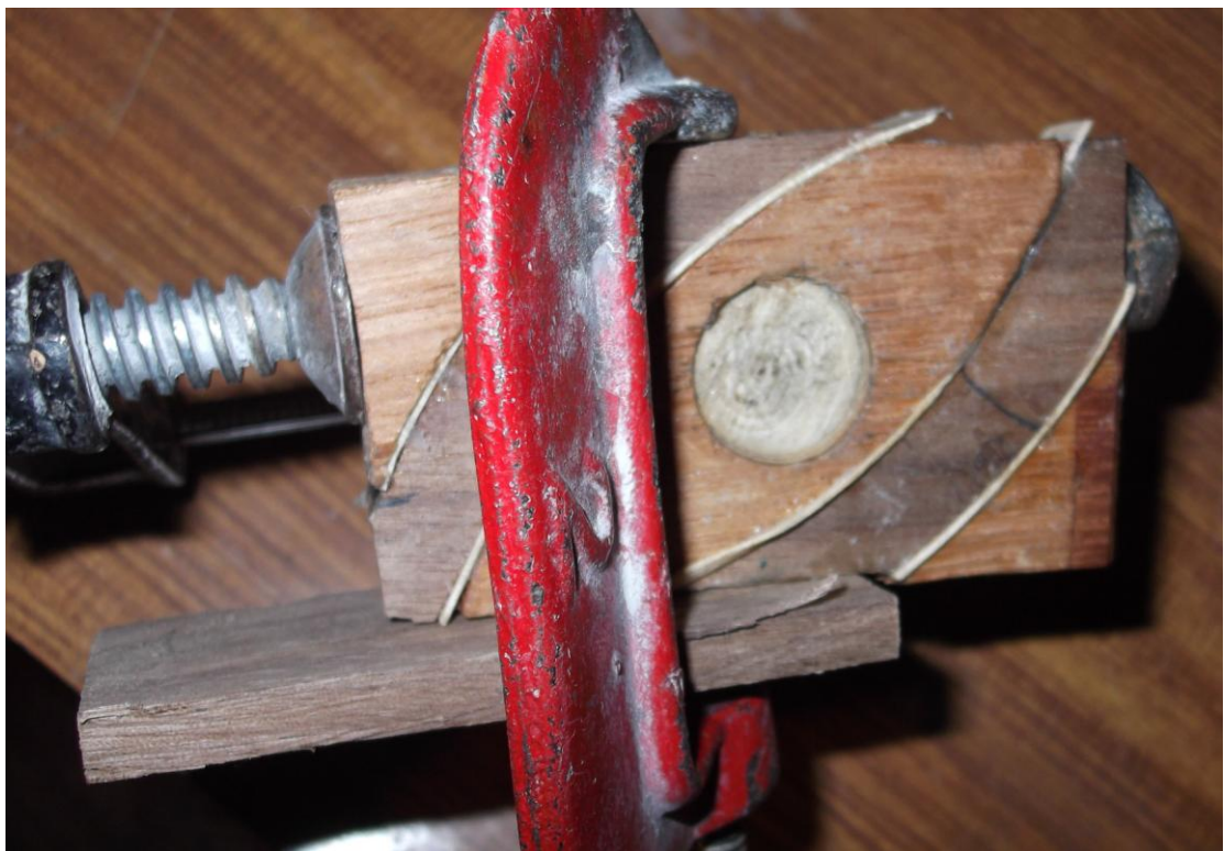
Συγκόλληση και συγκράτηση με τη χρήση σφιγκτήρων.
