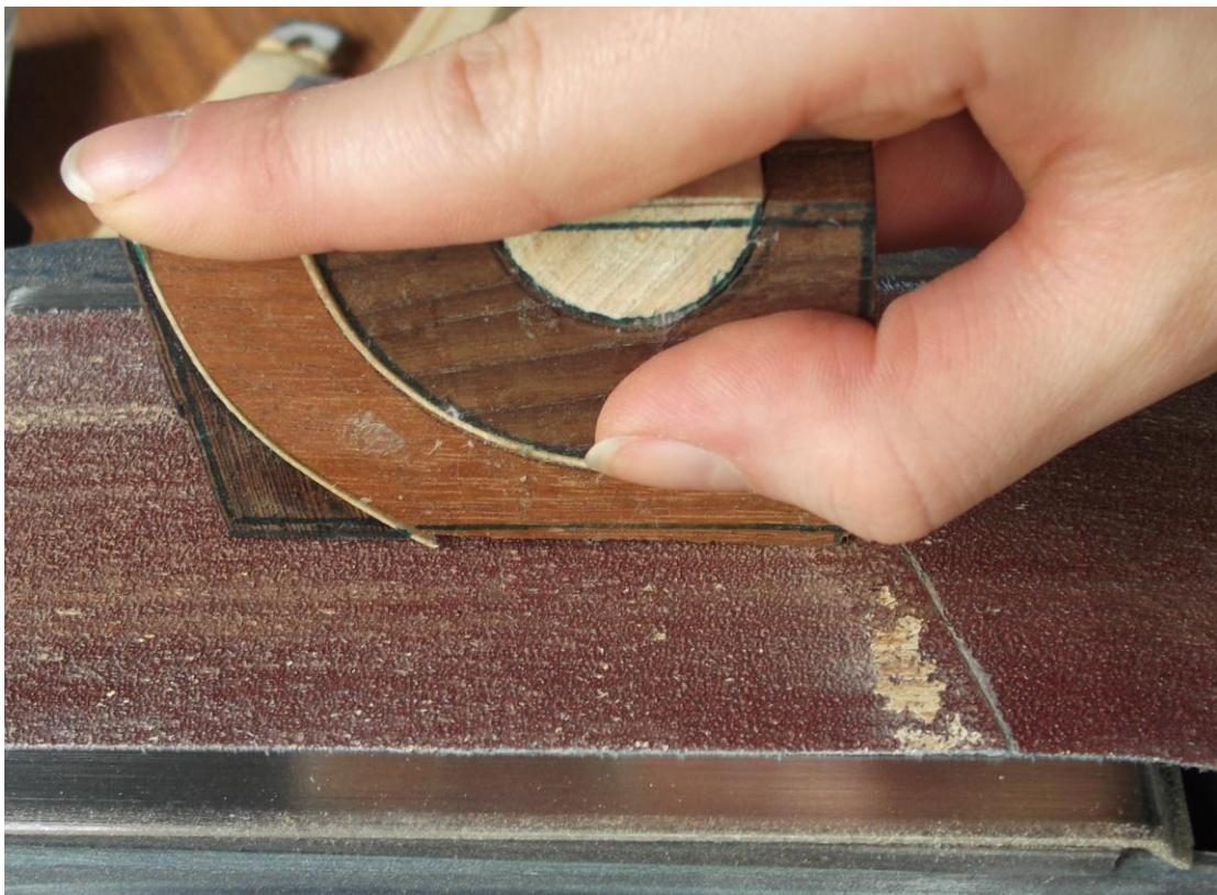
Τρίψιμο αρχικά με γυαλόχαρτο No 100 για να προσδώσω τις τελικές διαστάσεις και έπειτα με γυαλόχαρτο No 300 και 600 για να έχουμε την επιθυμητή υφή και γυαλάδα.
