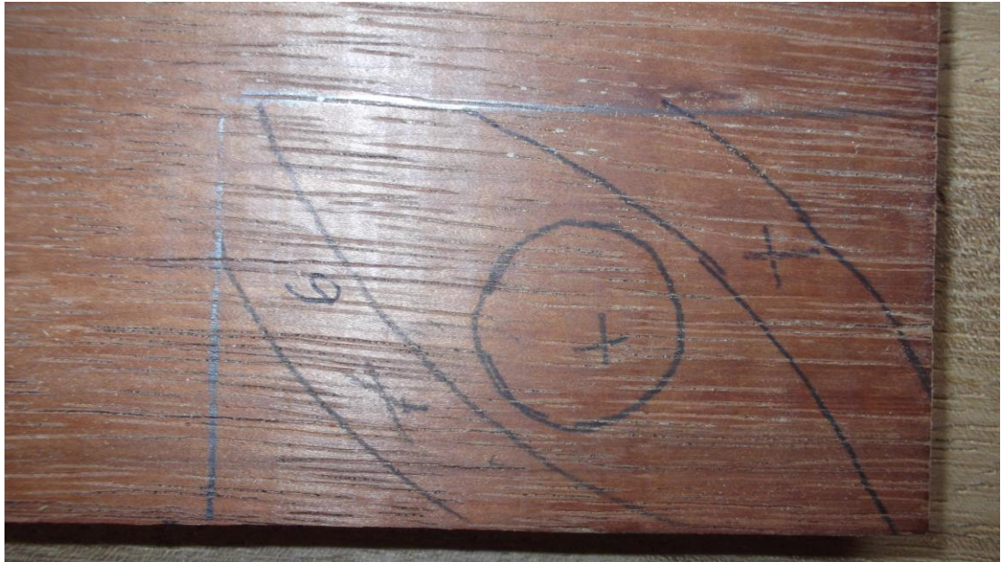
Σχεδιασμός των τμημάτων πάνω στα ξύλα με τη χρήση καρμπόν
