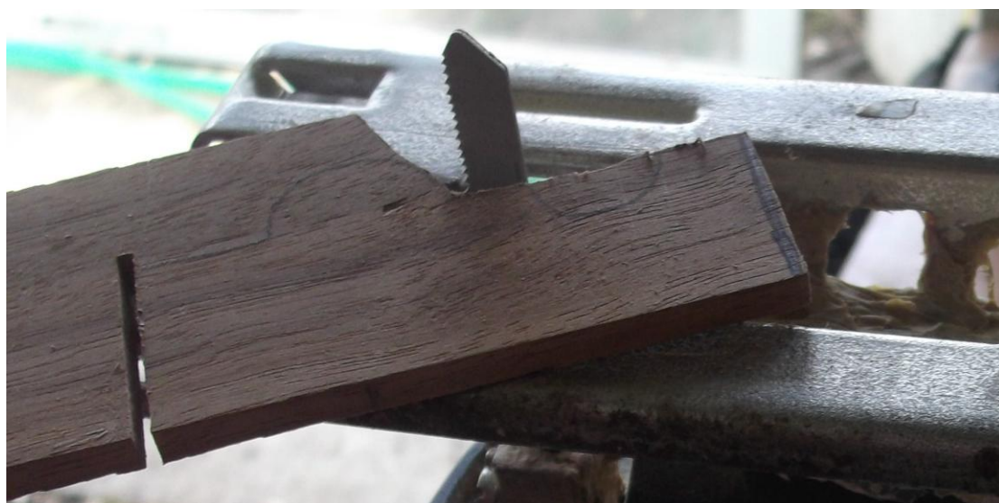
Κοπή των τμημάτων με τη χρήση σέγας
