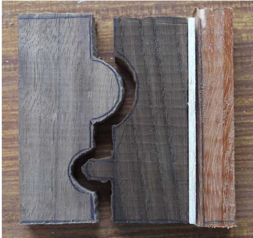
Πρόχειρη συναρμολόγηση πριν τη συγκόλληση
