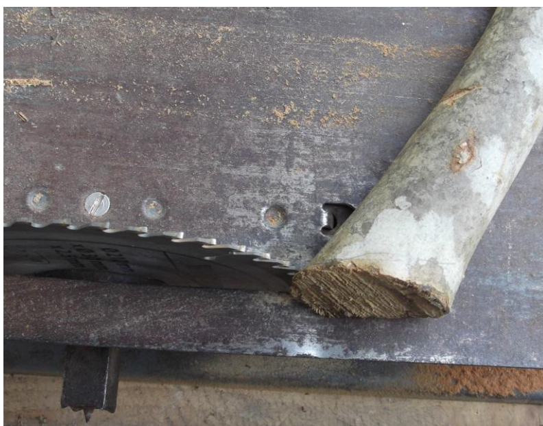
Κοπή κλαδιών σε δισκοπρίονο. Τελικό πάχος 15 mm
