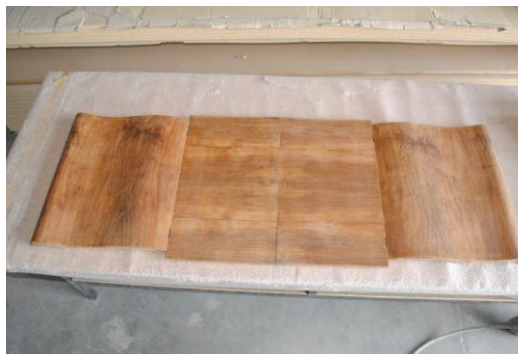
Οι πόρτες καθαρές από λούστρα έτοιμες για φινίρισμα.
