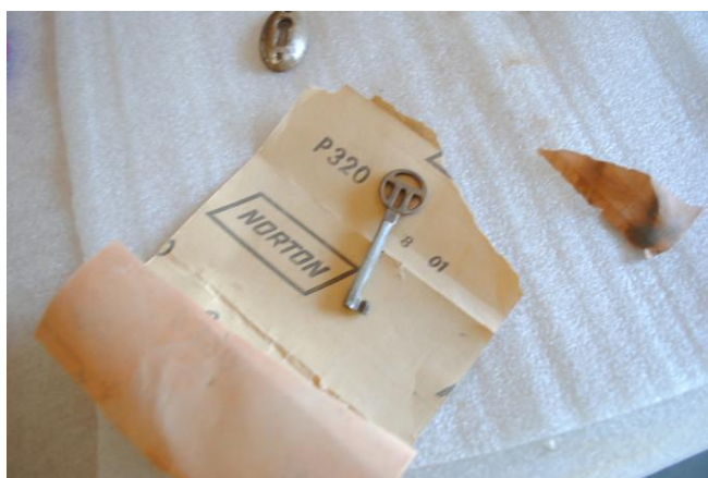
Καθαρισμός κλειδιού με χρήση γυαλόχαρτου 320.
