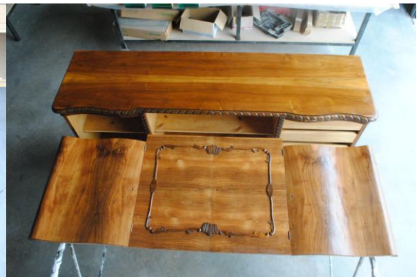
Το καπάκι και οι πόρτες πριν (αριστερά) και μετά το λουστράρισμα (δεξιά).
