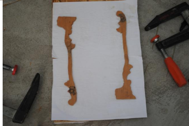
Κόλληση και σφίξιμο των κομματιών στην επιφάνεια με το χαρτί.
