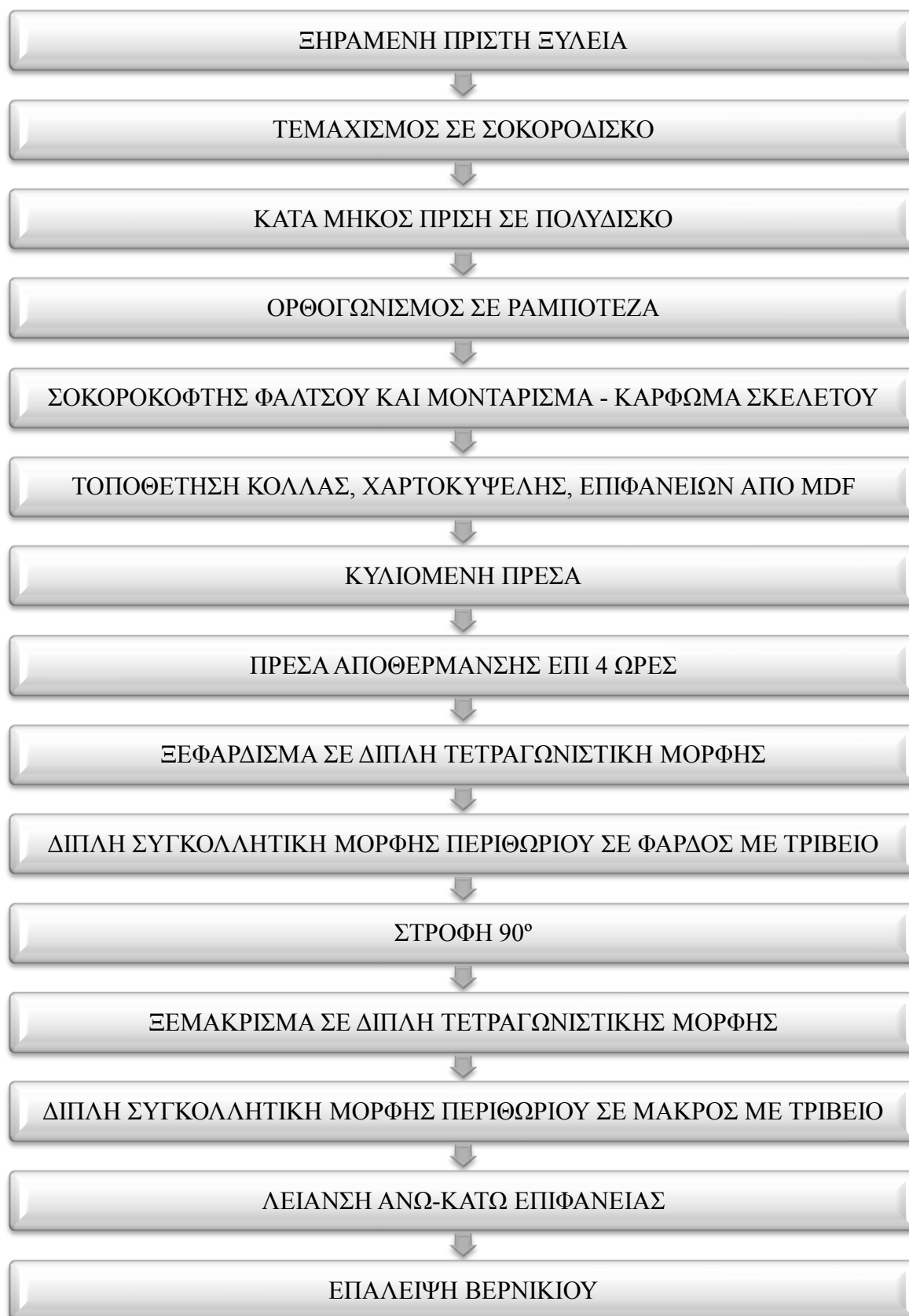
Σχήμα 3.9 Ροή παραγωγής για πρεσαριστές πόρτες. (Πηγή: Κακαράς Ι. 2004. Τεχνολογία Παραγωγής Επίπλων IV ).
