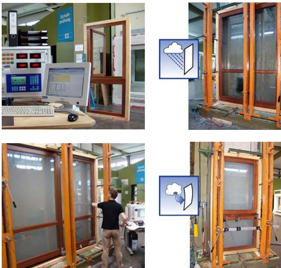
Εικόνα 5.4 Τεχνολογικές εγκαταστάσεις δομικών εργαστηριακών δοκιμών ανεμοπίεσης / αεροστεγανότητας και υδατοστεγανότητας κουφωμάτων. Στην ίδια εγκατάσταση πραγματοποιούνται και οι εργαστηριακές δοκιμές ασφαλείας (έκθεση σε ακραίες συνθήκες τυφώνα)(Πηγή: Πεταλίδης Α. 2010. Ξύλινα Κουφώματα Υψηλής Τεχνολογίας.).
