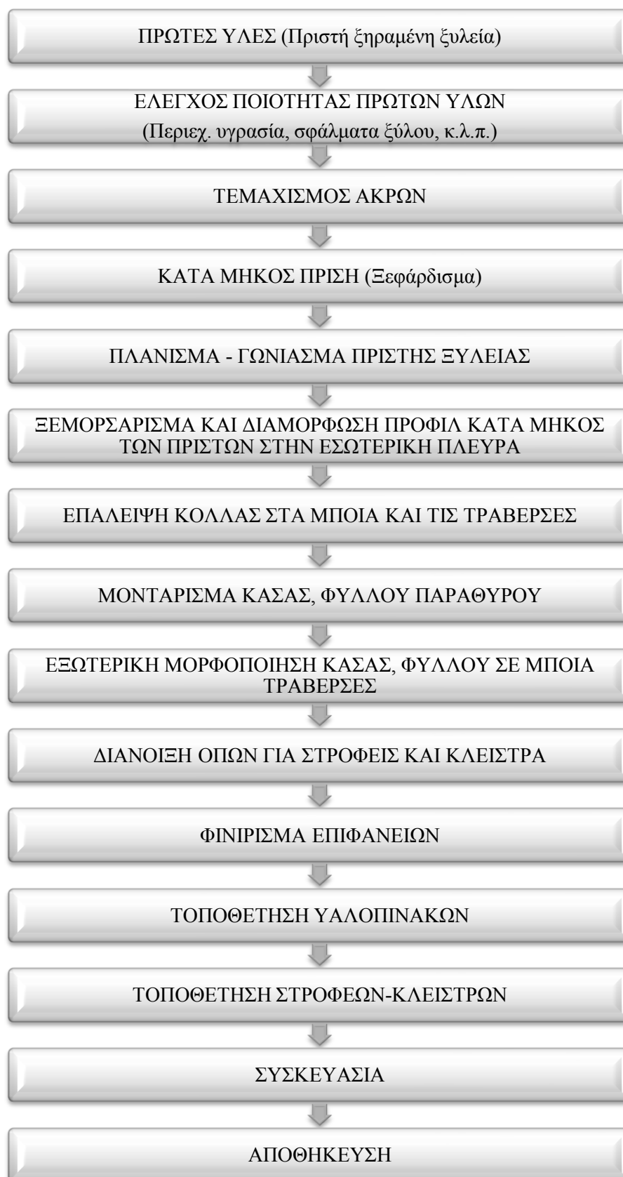
Σχήμα 2.12 Ροή παραγωγής ξύλινων παραθύρων (Πηγή: Κακαράς Ι. 2004. Τεχνολογία Παραγωγής Επίπλου IV ).
