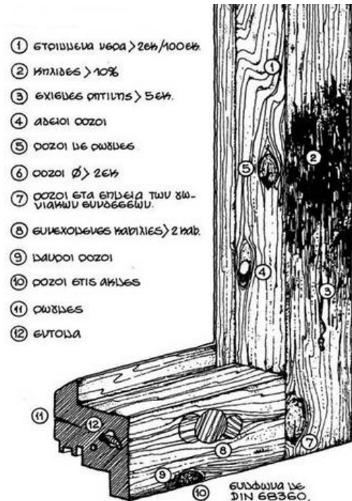
Εικόνα 3.16 Πιθανά ελαττώματα ξύλινων κουφωμάτων (Πηγή: Ρίζος Δ. 2012. Το Ξύλο Ως Βασικό Υλικό Στην Εσωτερική Αρχιτεκτονική & Διακόσμηση)
