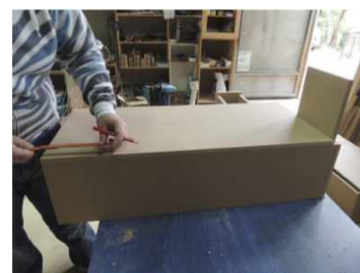
Μέτρηση για την τοποθέτηση των πελμάτων.
