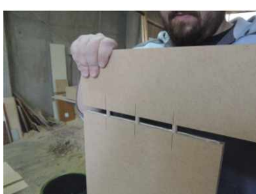
Σύνδεση των τεμαχίων πριν το πρεσάρισμα.
