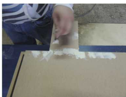
Στοκάρισμα συνδέσεων στο πλαίσιο F.
