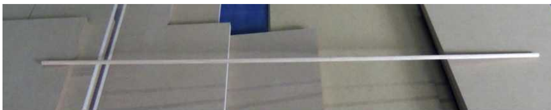
Καβίλια 8 mm διαμέτρου και μήκους 1 m
