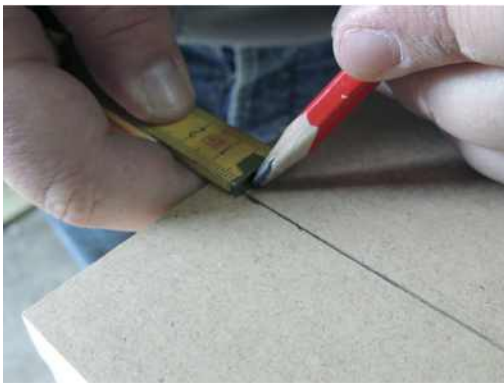
Μέτρηση οπών και σημάδεμα οπών
