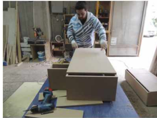
Τοποθέτηση και συναρμολόγηση επάνω επιφάνειας.
