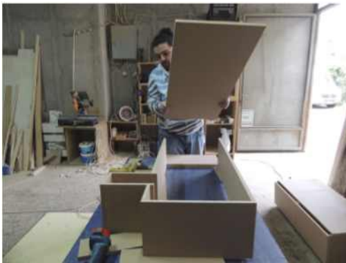
Τοποθέτηση πάνω επιφάνειας.
