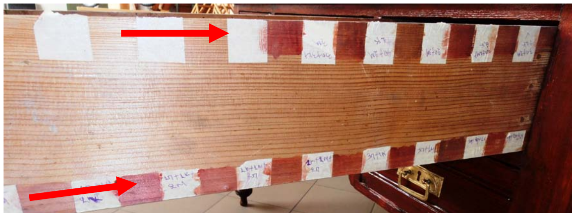
Εικ. 15.2.1: Δοκιμές με συνδυασμούς τριών αποχρώσεων ακουαρέλας και κατάληξη στην καταλληλότερη
