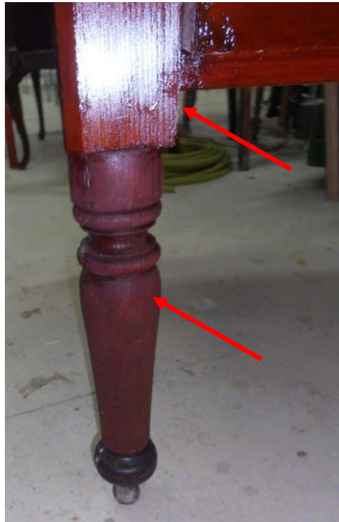
Εικ. 15.4.8: Διαφορά φινιρισμένης και όχι περιοχής (πόδι γραφείου)
