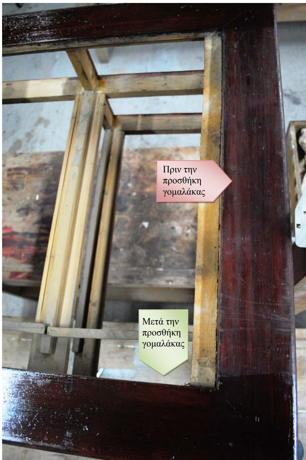
Εικ 15.4.7: Σημείου του επίπλου πριν την εφαρμογή γομαλάκας και σημείο μετά την εφαρμογή της
