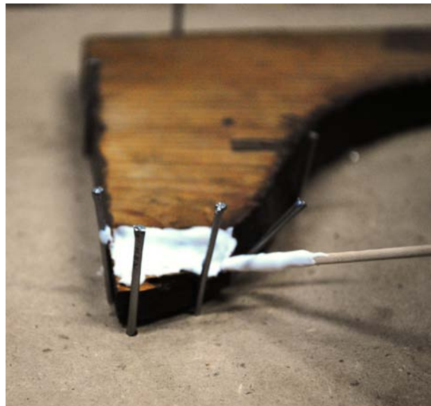
Εικ. 14.1.7: Εφαρμογή κόλλας ανάμεσα στα δυο τμήματα για τη συγκόλλησή τους
