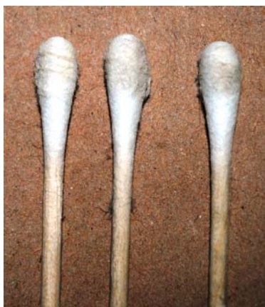
Εικ. 13.1.2: Αποτελέσματα κατά τη δοκιμή αφαίρεσης βερνικιού με White spirit
