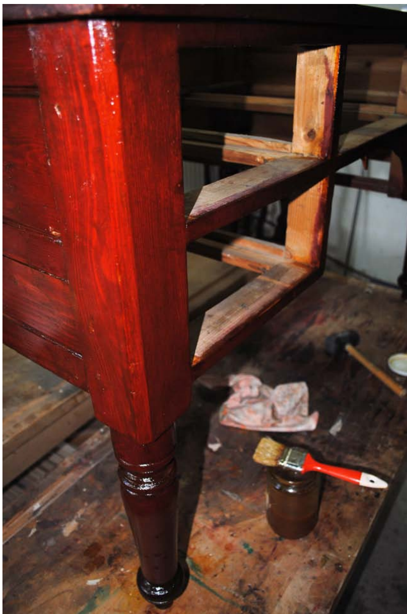
Εικ. 15.4.2: Το πόδι του επίπλου ολοκληρωμένο, αφού εφαρμόστηκαν όλα τα χέρια γομαλάκας
