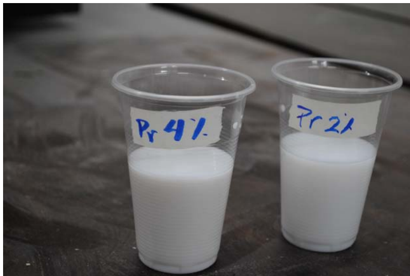
Εικ. 15.1.1: Δείγματα μίγματος Primal AC33 σε απιονισμένο νερό
