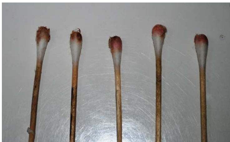
Εικ 3.1.8: Αποτελέσματα κατά τη δοκιμή αφαίρεσης βερνικιού με διάλυμα αλκοόλης προς ακετόνη 1/1
