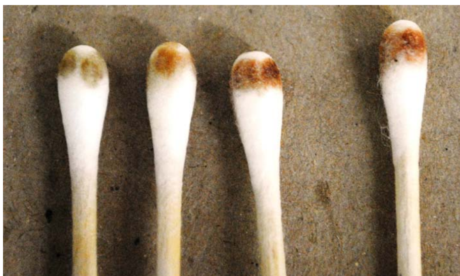
Εικ. 13.2.1: Αποτελέσματα κατά τη δοκιμή αφαίρεσης βερνικιού με διάλυμα 5ml white spirit και 5ml αλκοόλης, το διάλυμα που επιλέχθηκε
