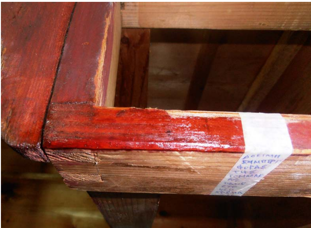
Εικ. 15.4.1: Δοκιμές συμπεριφοράς γομαλάκκας πάνω σε ήδη βαμμένο σημείο του επίπλου
