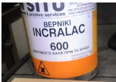
Εικ. 17.5.1: Το βερνίκι Incralac 600 για το λουστράρισμα των χερουλιών
