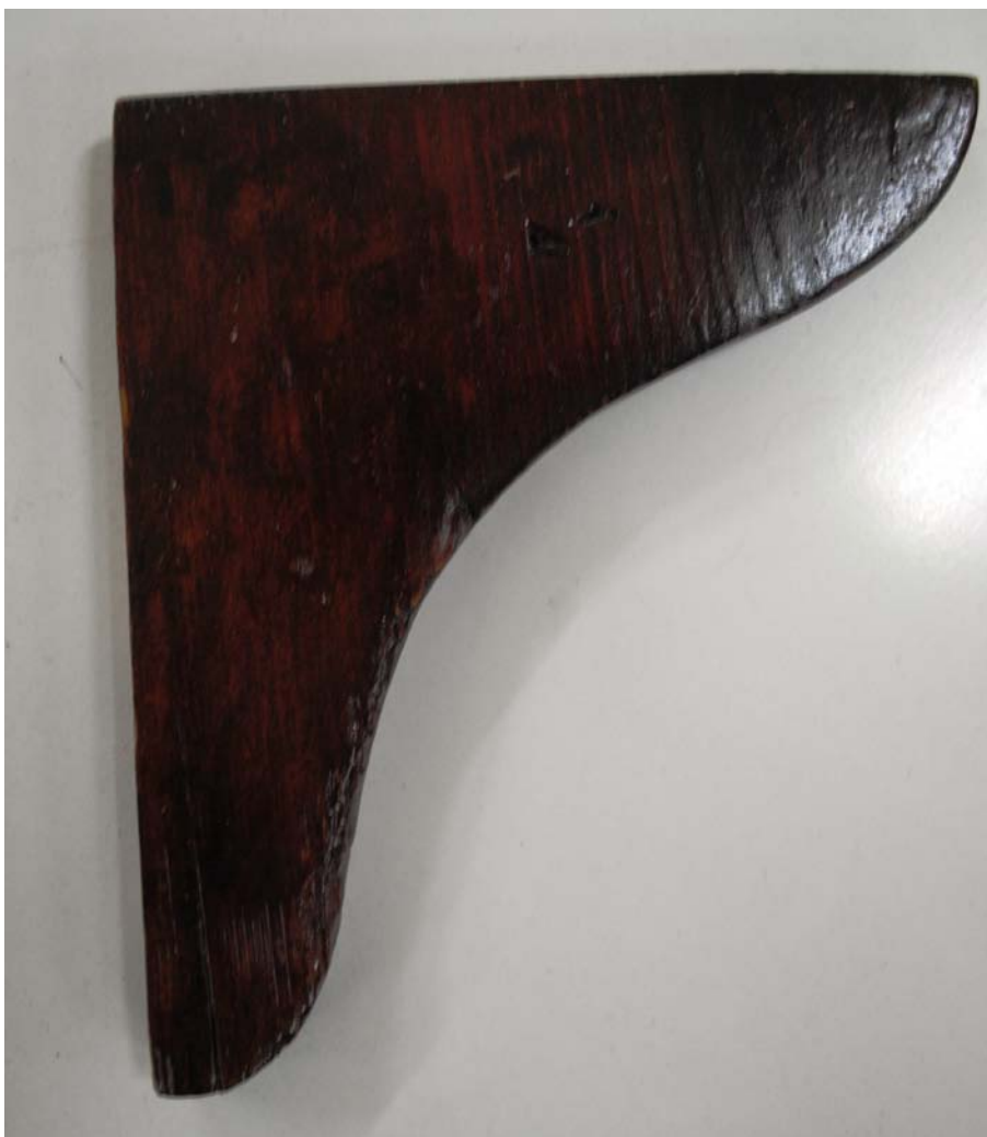
Εικ. 14.1.11: Η τελική επιφάνεια του ξύλινου διακοσμητικού κομματιού μετά το βάψιμο και το πέρασμα της γομαλάκκας
