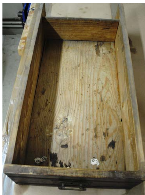
Εικ. 11.1.14: Τα συρτάρια πριν την συντήρησή τους με εμφανείς ρόζους
