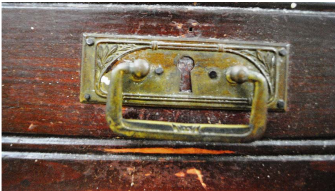
Εικ. 11.1.8: Ένα από τα χερούλια του επίπλου πριν την συντήρησή του (διάβρωση, πατίνα)
