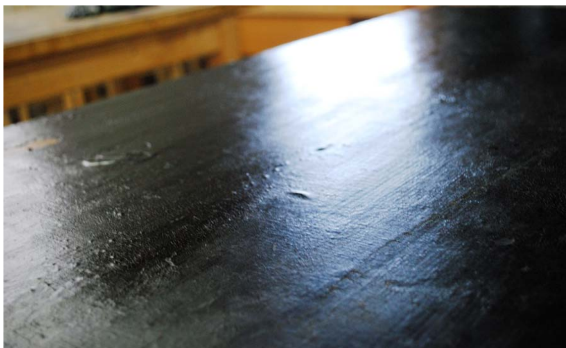
Εικ. 16.3.8: Το αποτέλεσμα καθαρισμού της επιφάνειας του δέρματος μετά την χρήση του διαλείμματος 50% ασετόν και 50% white spirit (1/1)
