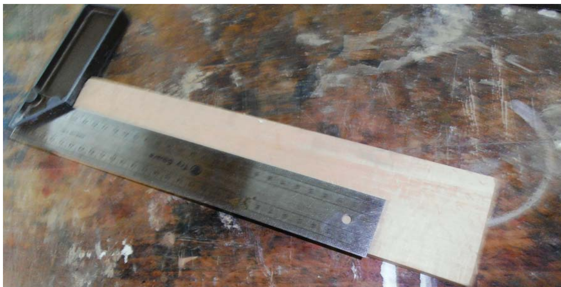
Εικ. 14.2.1: Μέτρημα για κόψιμο οδηγού συρταριών
