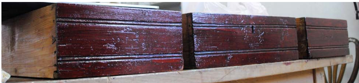
Εικ. 15.4.3: Τα συρτάρια του επίπλου ολοκληρωμένα, αφού εφαρμόστηκαν όλα τα χέρια γομαλάκας
