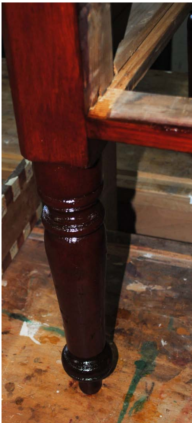
Εικ. 15.4.6: Πόδι του επίπλου ολοκληρωμένο, αφού εφαρμόστηκαν όλα τα χέρια γομαλάκας
