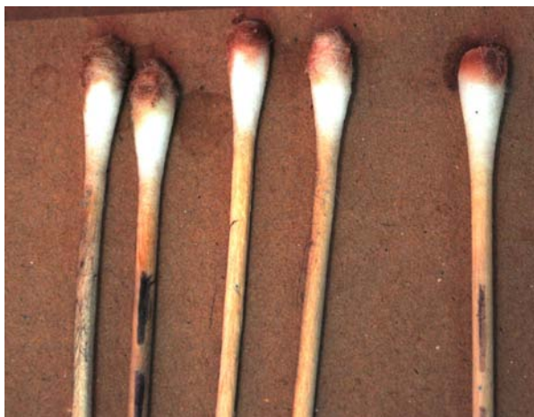
Εικ 3.1.9: Αποτελέσματα κατά τη δοκιμή αφαίρεσης βερνικιού με μίγμα white spirit ακετόνης 1/1
