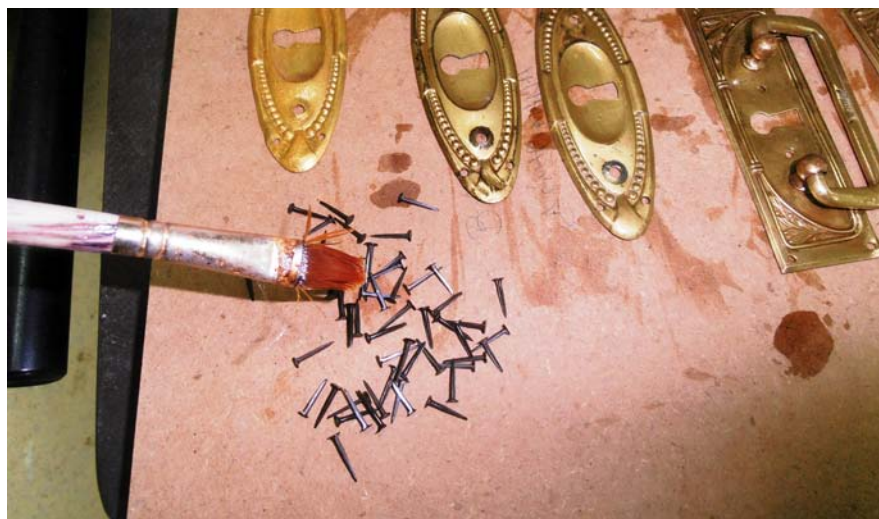
Εικ. 17.5.2: Πέρασμα βερνικιού στα καρφάκια (τοποθέτησης των χερουλιών) και στα χερούλια
