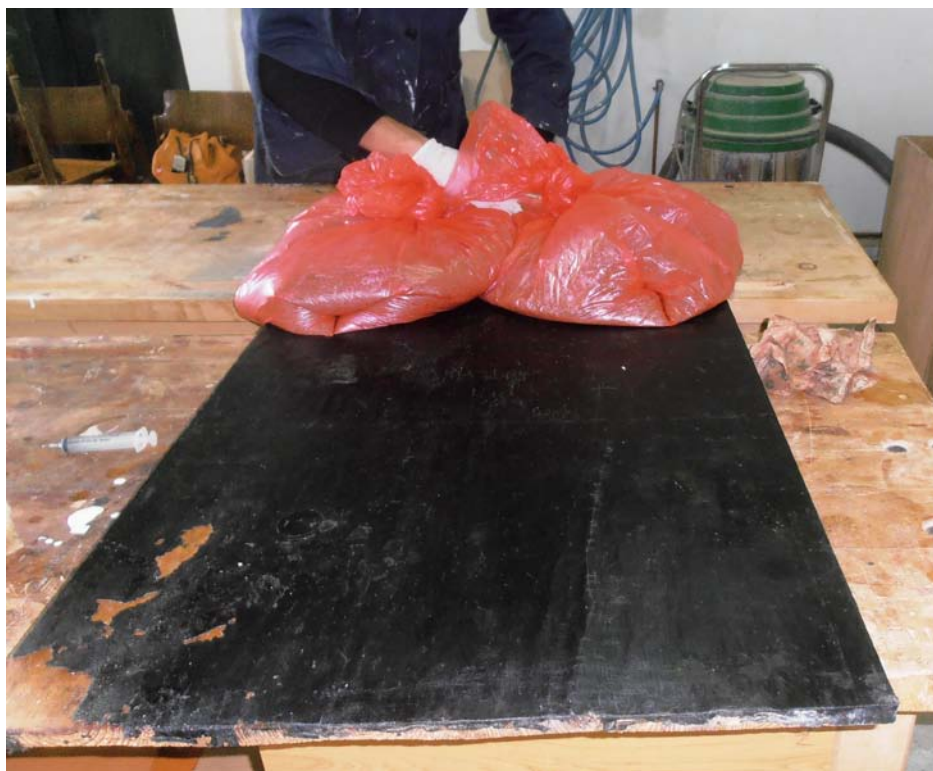
Εικ. 16.2.3: Τοποθέτηση σακουλών με άμμο για τη συγκόλληση του δέρματος
