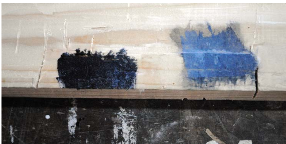
Εικ. 16.4.5: Οι δοκιμές για την επιλογή απόχρωσης και υλικού για την αισθητική αποκατάσταση των συμπληρώσεων ιαπωνικού χαρτιού
