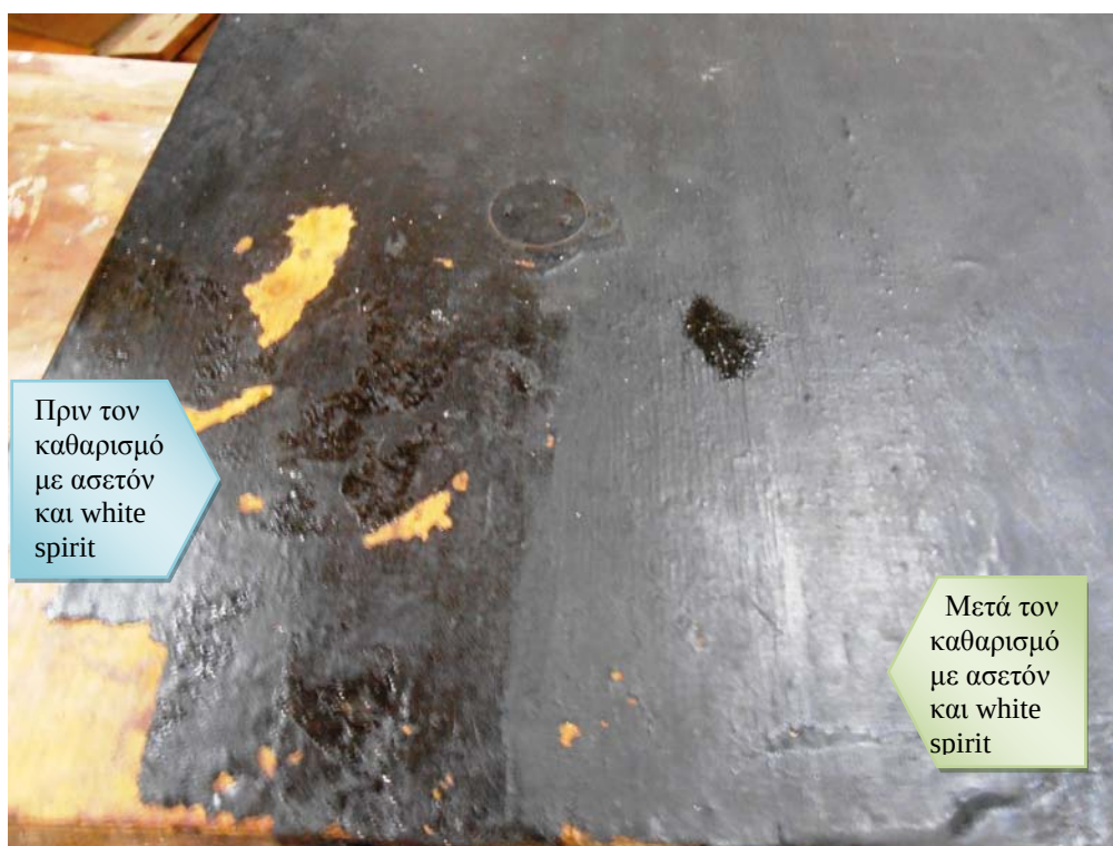
Εικ. 16.3.6: Διαφορές της επιφάνειας του δέρματος, πριν και μετά τον καθαρισμό με το διάλυμα 50% ασετόν και 50% white spirit (1/1)
