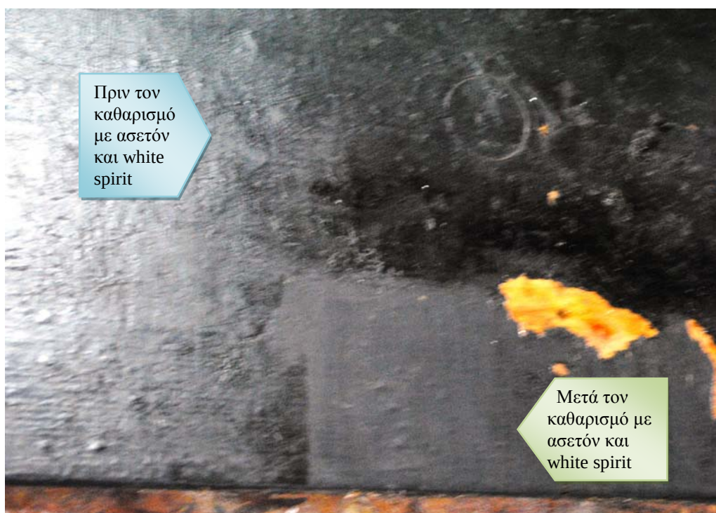
Εικ. 16.3.7: Διαφορές της επιφάνειας του δέρματος, πριν και μετά τον καθαρισμό με το διάλυμα 50% ασετόν και 50% white spirit (1/1)
