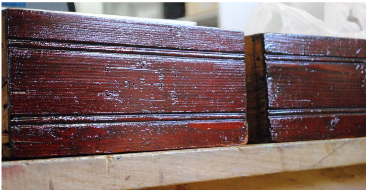
Εικ 15.4.4: Συρτάρια του επίπλου ολοκληρωμένα, αφού εφαρμόστηκαν όλα τα χέρια γομαλάκκας
