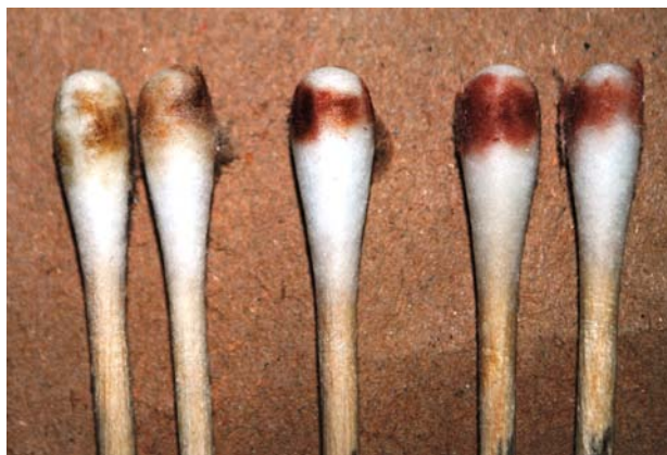
Εικ. 13.1.6: Αποτελέσματα κατά τη δοκιμή αφαίρεσης βερνικιού με ακετόνη
