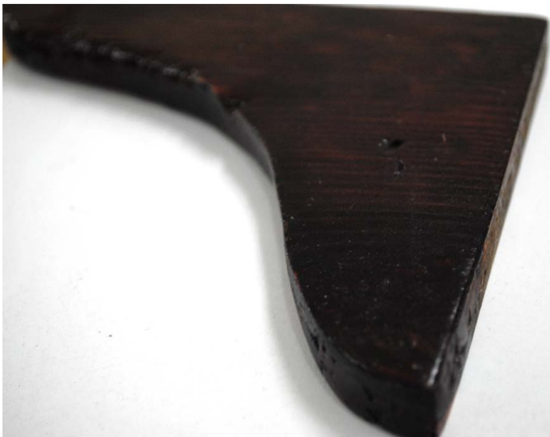
Εικ. 14.1.10: Η τελική επιφάνεια του ξύλινου διακοσμητικού μετά την αισθητική αποκατάσταση και την εφαρμογή φινιρίσματος γομαλάκκας
