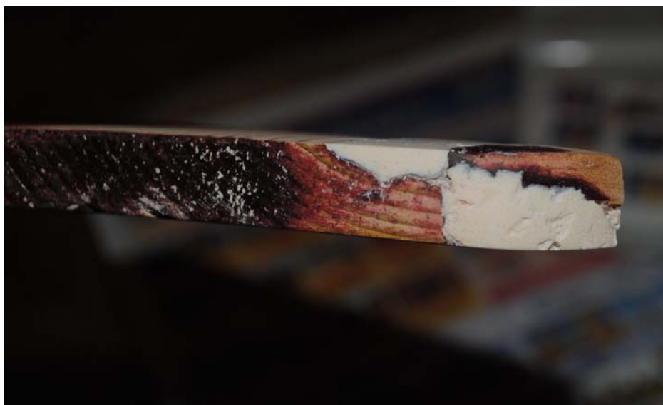
Εικ. 14.1.8: Το τμήμα μετά το τρίψιμο με γυαλόχαρτο (πλάγια όψη)
