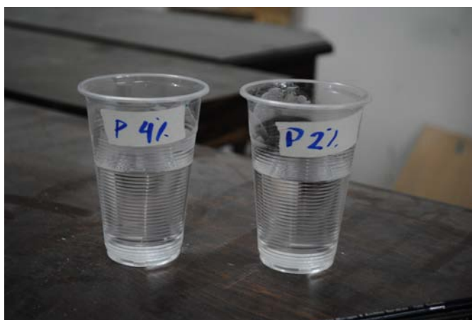
Εικ. 15.1.2: Δείγματα μίγματος Paraloid σε ακετόνη
