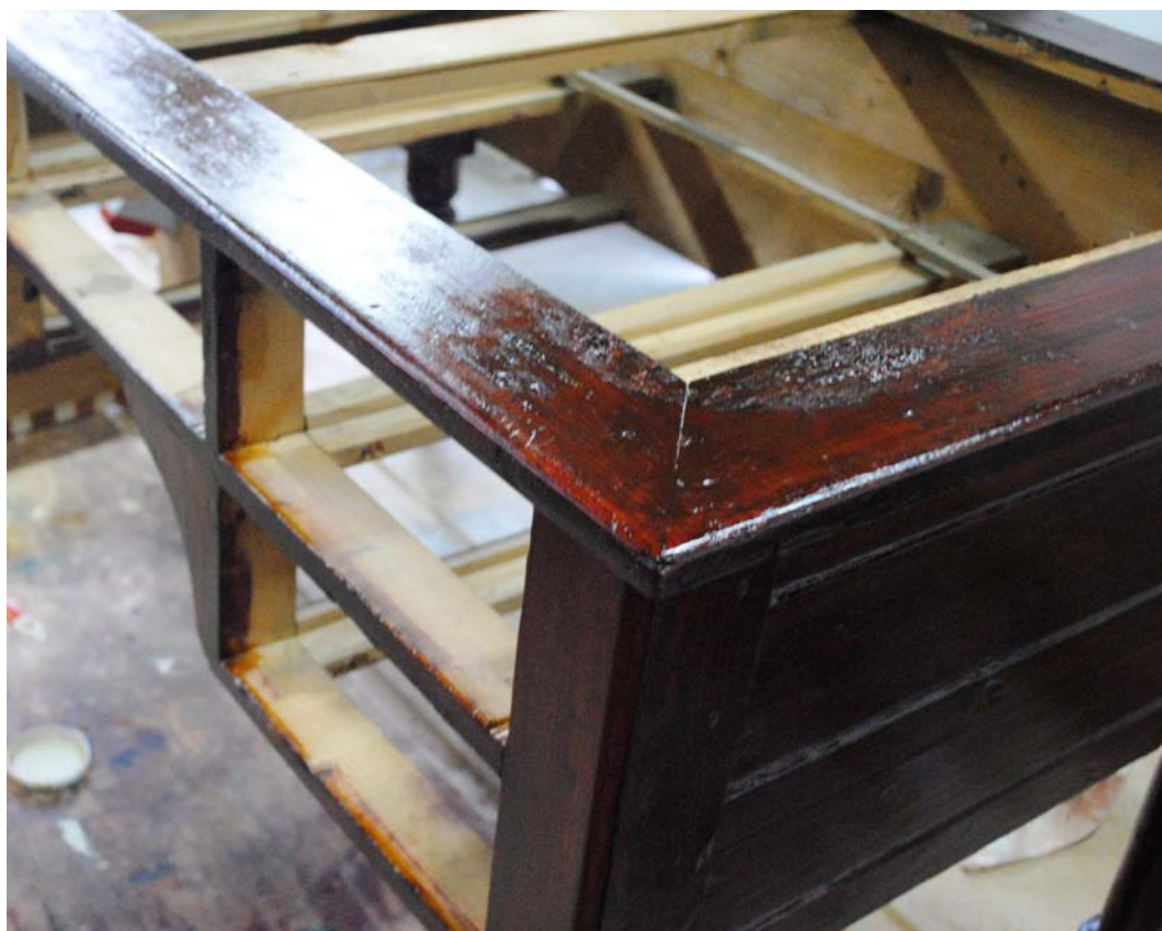
Εικ. 15.4.5: Λεπτομέρεια περιμετρικά του καπακιού του επίπλου ολοκληρωμένη, αφού εφαρμόστηκαν όλα τα χέρια γομαλάκκας
