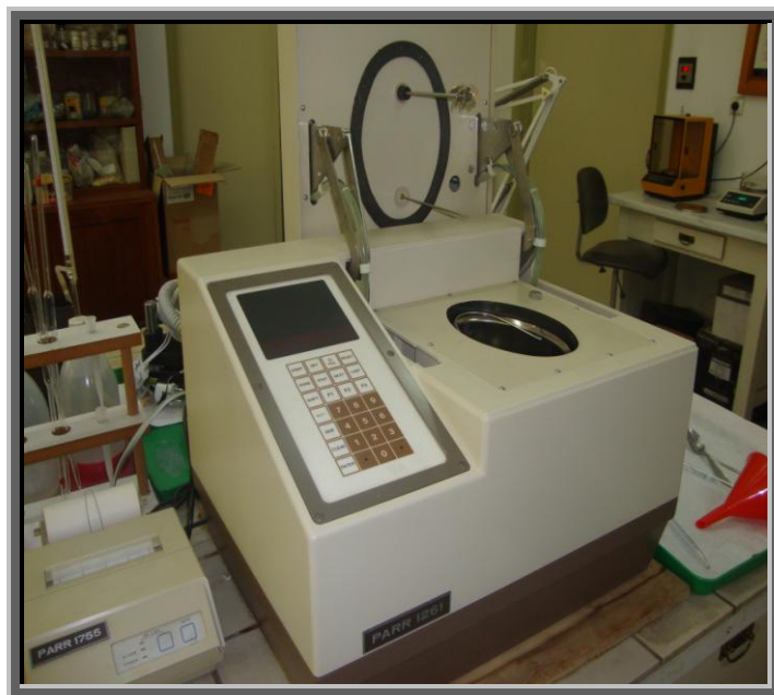
Εικόνα 18: Θερμιδομετρητής τύπου οβίδας.
