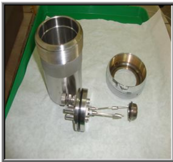
Εικόνα 20: Οβίδα του θερμιδομετρητή.
