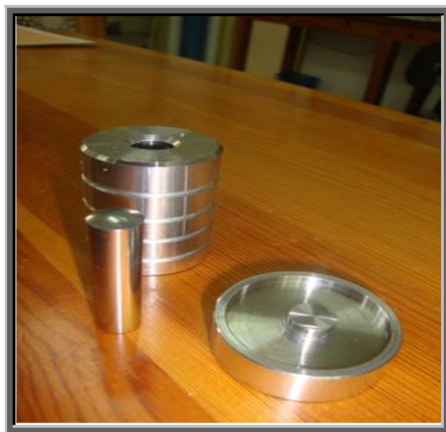
Εικόνα 14: Μήτρα παραγωγής εργαστηριακών pellet.
