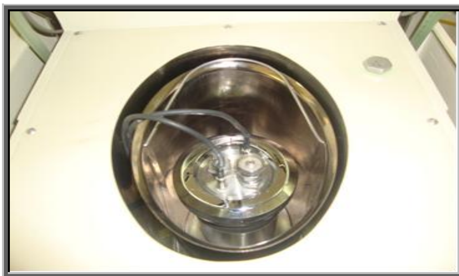
Εικόνα 25: Τοποθέτηση οβίδας-κάδου στο θερμιδομετρητή και σύνδεση ηλεκτρονίων.
