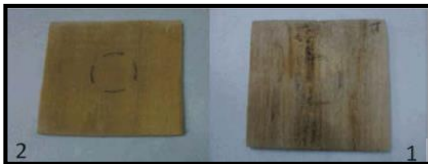
Εικόνα 2 Μη επεξεργασμένο δείγμα (1) και επεξεργασμένο δείγμα (2) με νάνο-οξείδιο του ψευδαργύρου συγκέντρωσης 1.5% μετά από 600 ώρες έκθεσης.
