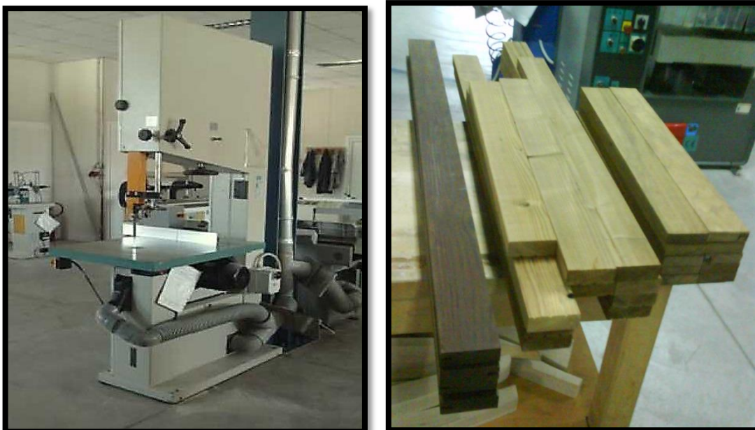
Εικόνα 48. Διαμόρφωση τροποποιημένης ξυλείας κατά πλάτος στην πριονοκορδέλα.
