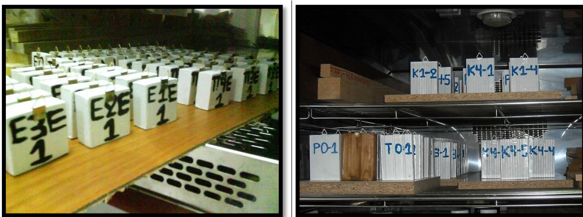
Εικόνα 65. Κλιματισμός δοκιμίων μετά από το χειρισμό με το νανοσκεύασμα.
