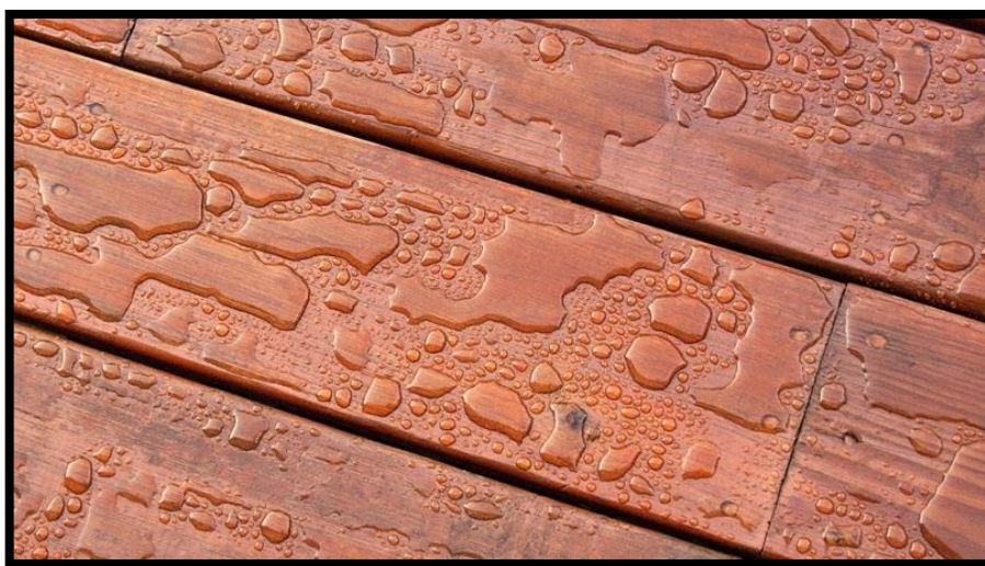
Εικόνα 14. Τροποποιημένη με νανοσωματίδια ξύλινη επιφάνεια.
