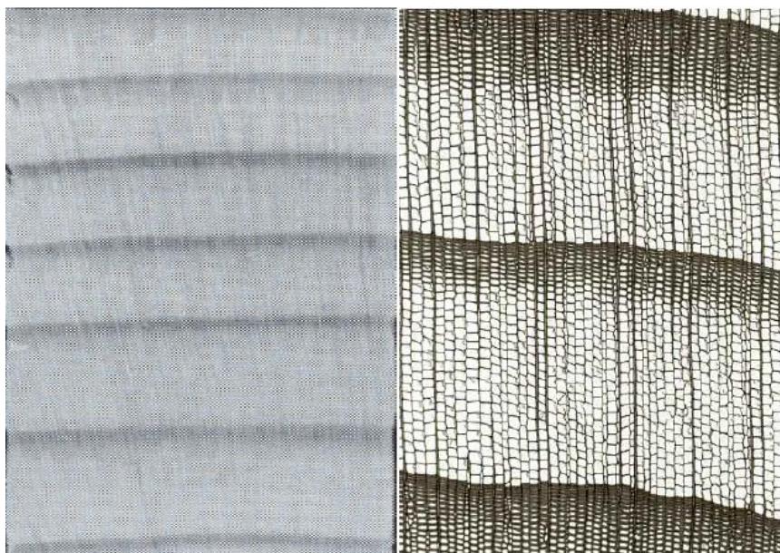
Εικόνα 20. Μακροσκοπική (αριστερά) και μικροσκοπική (δεξιά) εμφάνιση ξύλου ελάτης, σε εγκάρσια επιφάνεια. ( http://users.teilar.gr/~mantanis/ergastiriaki-yli.pdf ).
