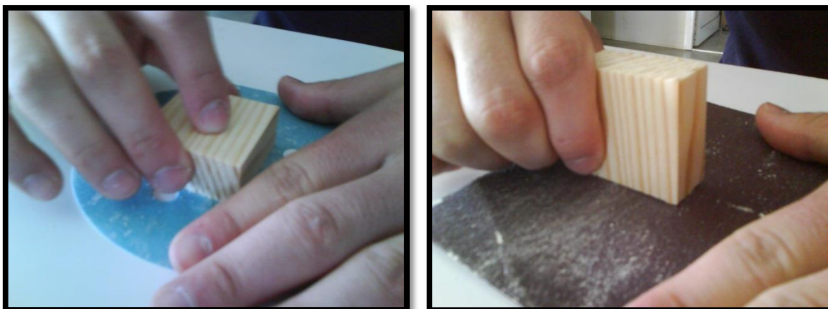
Εικόνα 50. Λείανση δοκιμίων πεύκου και έλατου.
