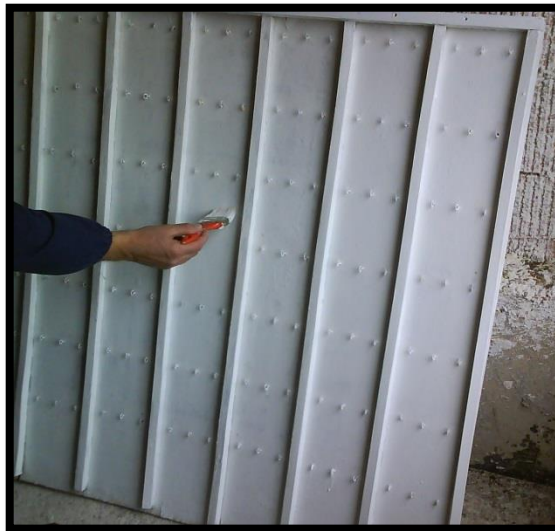
Εικόνα 67. Συντήρηση υπάρχουσας βάσης έκθεσης δοκιμίων.
