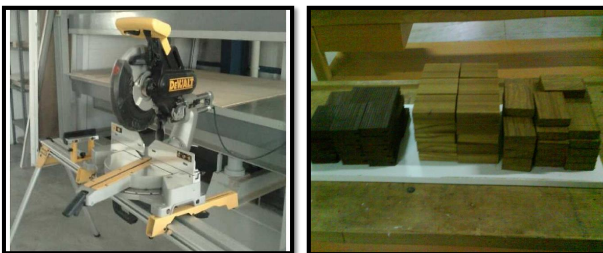
Εικόνα 49. Διαμόρφωση τροποποιημένης ξυλείας στο δισκοπρίονο για τελικό μήκος δοκιμίων.
