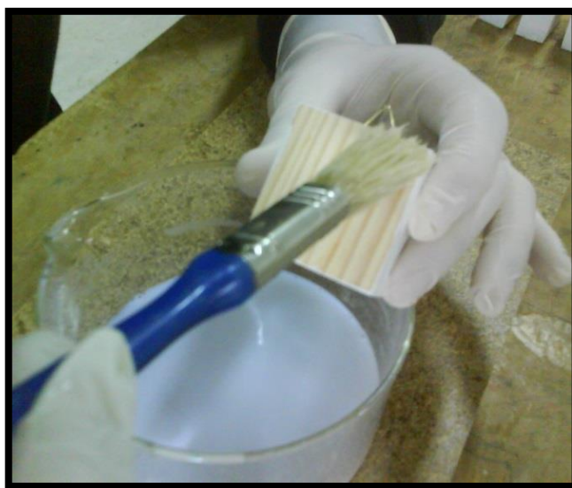
Εικόνα 61. Χειρισμός επάλειψης δοκιμίων με πινέλο.
