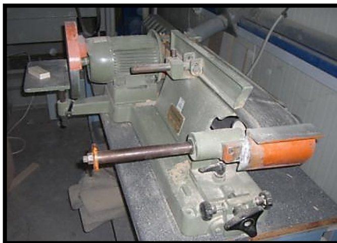
Εικόνα 40. Ταινιολειαντήρας - γυαλοχαρτιέρα τύπου F9.
