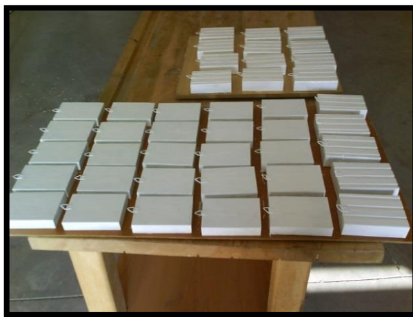
Εικόνα 58. Διαχωρισμός δοκιμίων τροποποιημένης ξυλείας.
