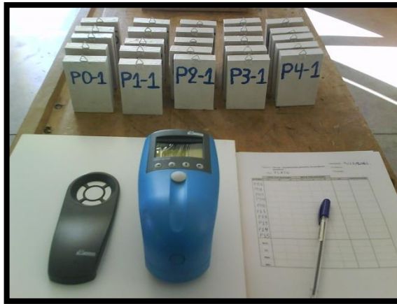
Εικόνα 66. Μέτρηση χρώματος δοκιμίων.
