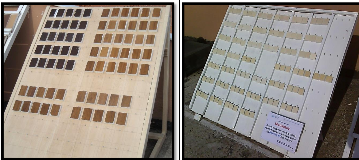
Εικόνα 69. Ταξινόμηση των δοκιμίων στις βάσεις έκθεσης στην ταράτσα του τμήματος.
