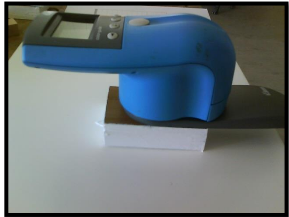
Εικόνα 66. Μέτρηση χρώματος δοκιμίων.
