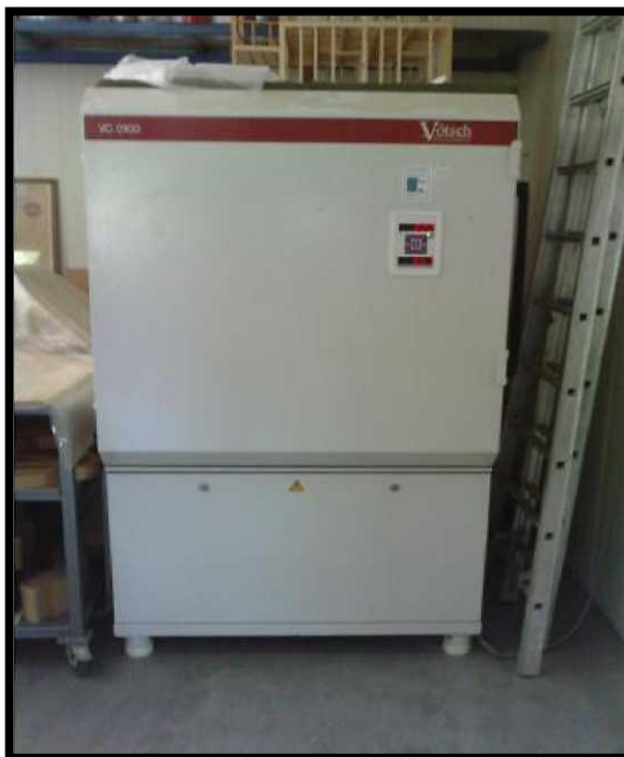
Εικόνα 41. Θάλαμος κλιματισμού τύπου Votsch VC0100.
