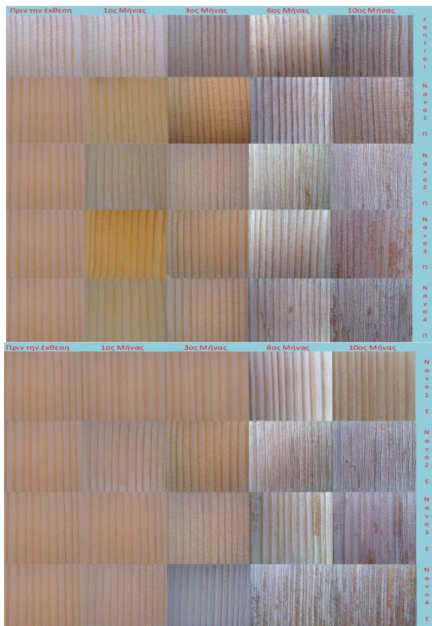
Εικόνα 71. Χρωματικές μεταβολές δοκιμίων έλατου μετά από 10 μήνες έκθεση στην ηλιακή ακτινοβολία.
