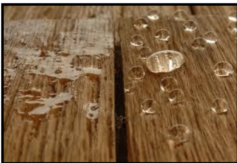
Εικόνα 15. Ξύλινη επιφάνεια τροποποιημένη με νανοσωματίδια (δεξιά).
