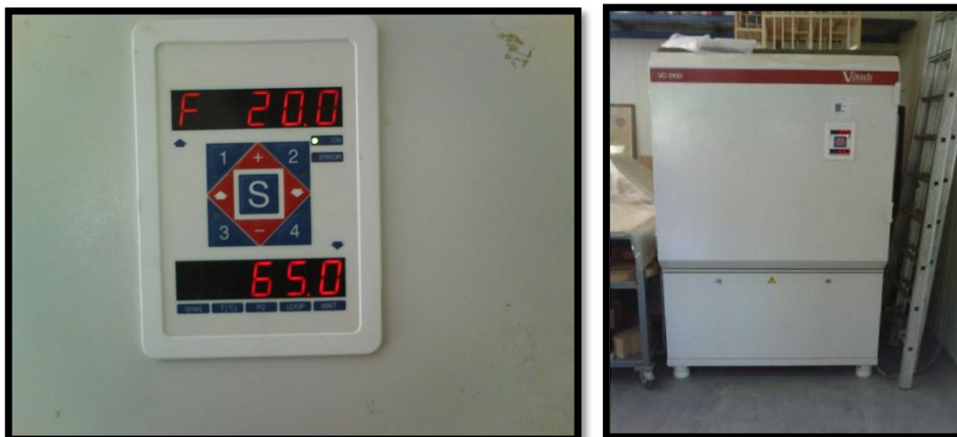
Εικόνα 52. Κλιματισμός δοκιμίων ξύλου σε κατάλληλες συνθήκες.
