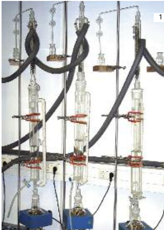
1. Συσκευή εκχύλισης της μεθόδου Perforator
