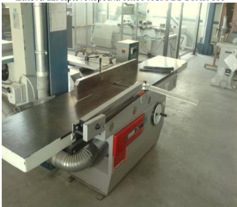
Εικόνα 13. Πλάνη τύπου CASADEI MACCHINE DS 510
