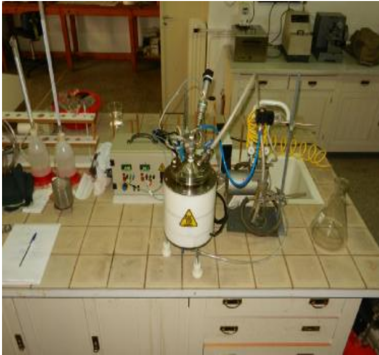
Εικόνα 22. Αντιδραστήρας διεξαγωγής των υδροθερμικών χειρισμών.
