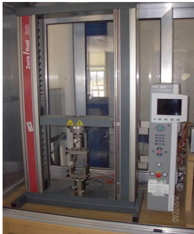
Εικόνα 21. Συσκευή μηχανικών αντοχών τύπου Zwick/Roell Z020
