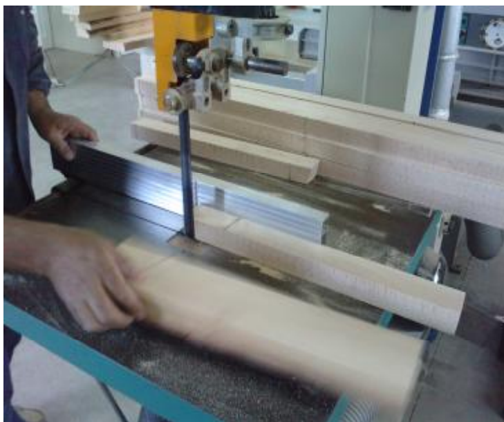
Εικόνα 26. Δημιουργία δοκών τετραγωνικής διατομής.
