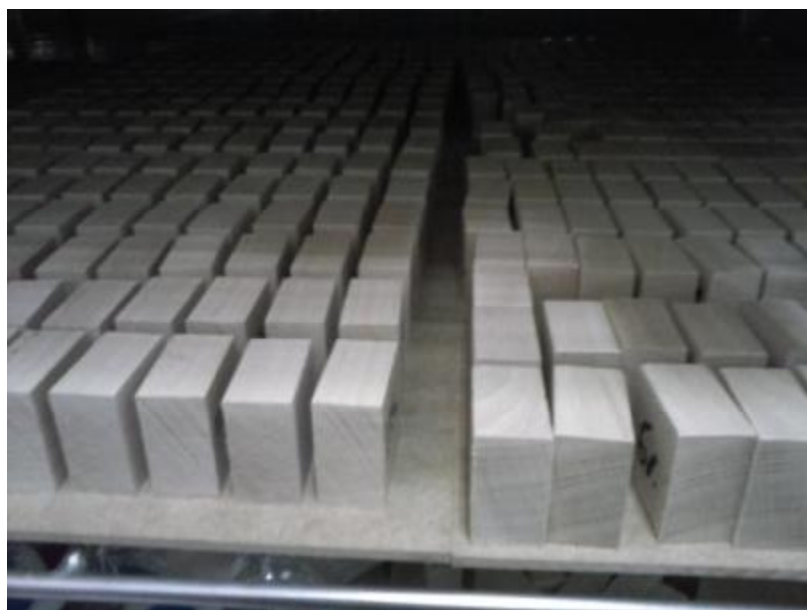
Εικόνα 36. Τοποθέτηση δοκιμίων στο θάλαμο.
