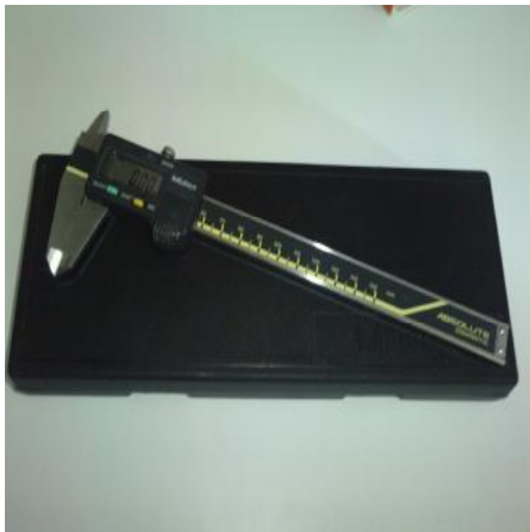
Εικόνα 17. Ηλεκτρονικό παχύμετρο ακριβείας τύπου Mitutoyo 500-181U
