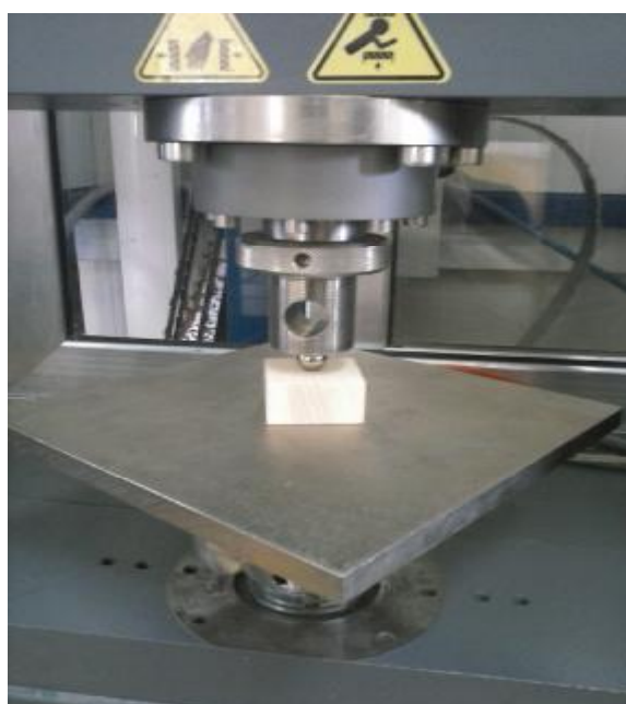
Εικόνα 40. Δοκιμή σκληρότητας δοκιμίων ομάδας A
