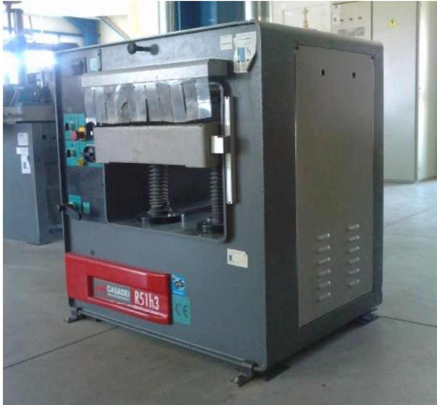
Εικόνα 14. Ξεχονδριστήρας τύπου CASADEI MACCHINE R51h3
