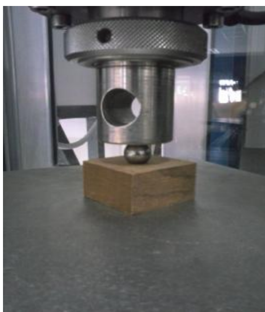
Εικόνα 41. Δοκιμή σκληρότητας των δοκιμίων της ομάδας B
