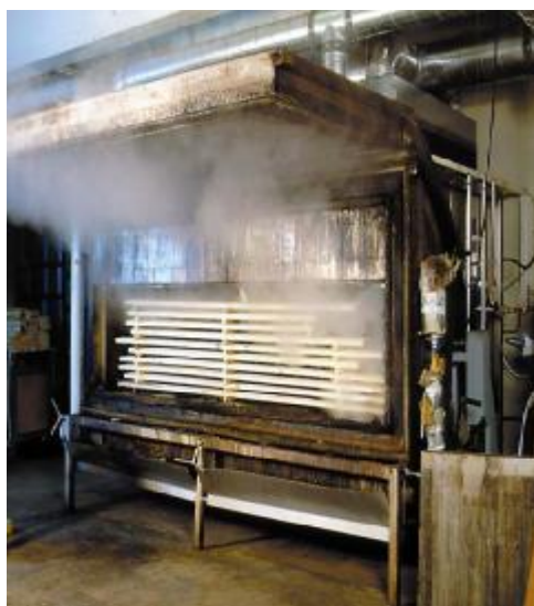
Εικόνα 9. Ο πρώτος θάλαμος χειρισμού θερμικά τροποποιημένης ξυλείας στις αρχές του 90.
