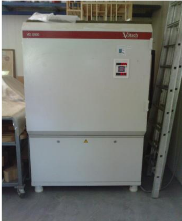
Εικόνα 20. Θάλαμος κλιματισμού τύπου Votsch VC0100
