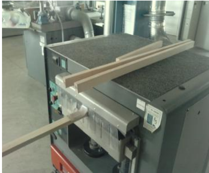
Εικόνα 31. Ξεχόνδρισμα σε τελικές διαστάσεις πάχους
