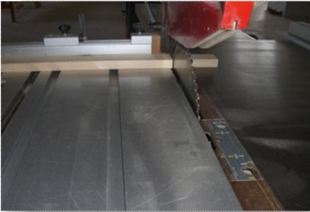
Εικόνα 34. Κοπή πεύκου στην γωνιάστρα στο radial
