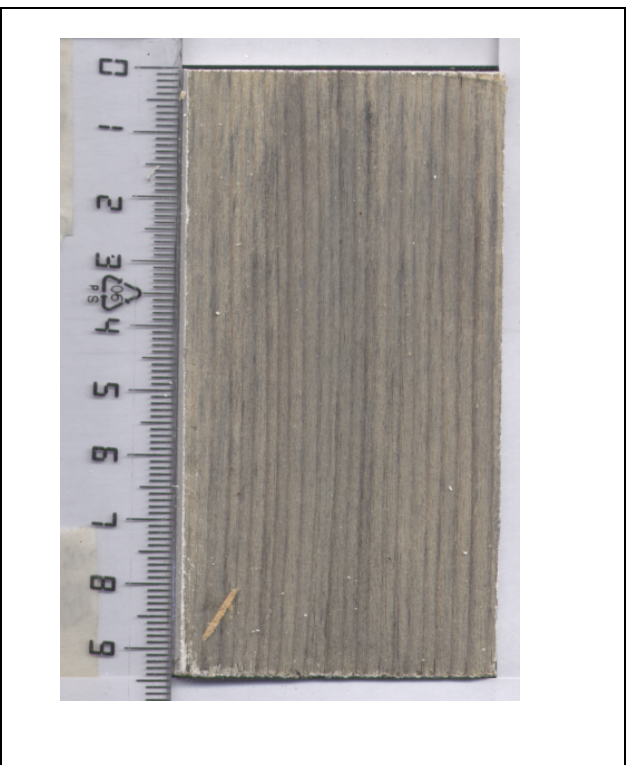
Εικόνα 54. Δοκίμιο E22-M ΜΕΤΑ ΑΠΟ 317 ΗΜΕΡΕΣ ΕΚΘΕΣΗΣ
