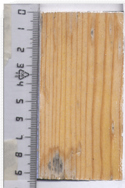
Εικόνα 72. Δοκίμιο Ε7-Α ΜΕΤΑ ΑΠΟ 317 ΗΜΕΡΕΣ ΕΚΘΕΣΗΣ
