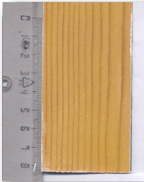
Εικόνα 48. Δοκίμο Ε4-Λ ΜΕΤΑ ΑΠΟ ΕΚΘΕΣΗ 74 ΗΜΕΡΩΝ
