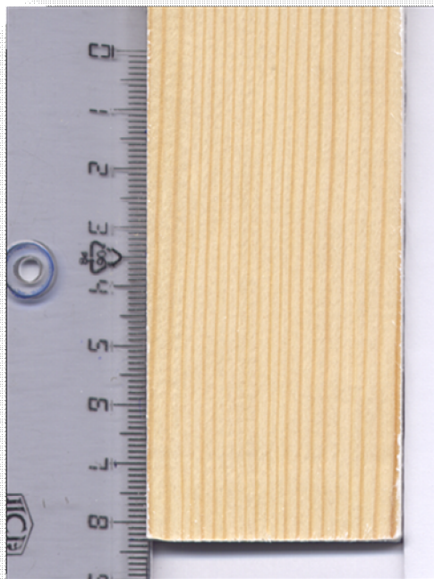
Εικόνα 67 δοκίμιο Π51-Χ ΜΕΤΑ ΤΗΝ ΕΠΙΚΑΛΥΨΗ
