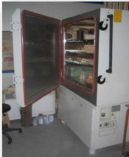
Εικόνα 16. Θάλαμος κλιματισμού (votsch VC0100)
