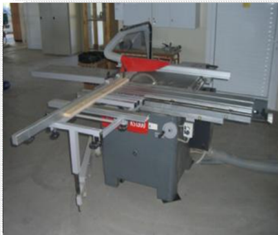
Εικόνα 13. Γωνιάστρα (CASADEI –KS1300)
