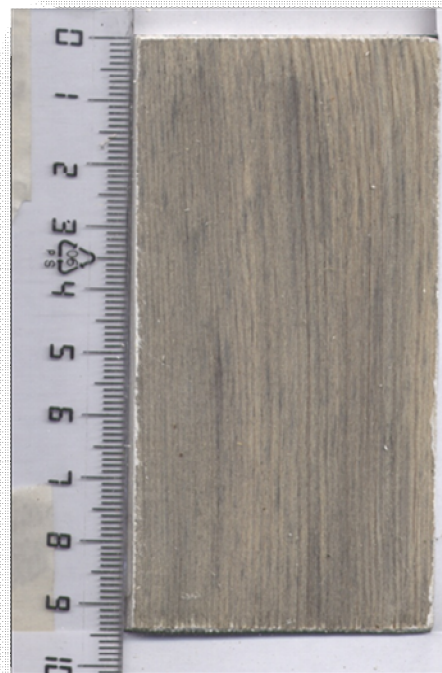
Εικόνα 86. Δοκίμιο Π14-Λ ΜΕΤΑ ΑΠΟ 317 ΗΜΕΡΕΣ ΕΚΘΕΣΗΣ
