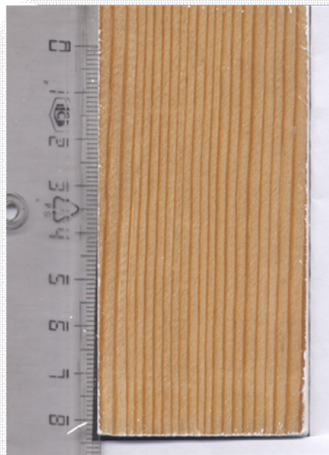
Εικόνα 68. Δοκίμιο Π51-Χ ΜΕΤΑ ΑΠΟ 74 ΗΜΕΡΕΣ ΕΚΘΕΣΗΣ
