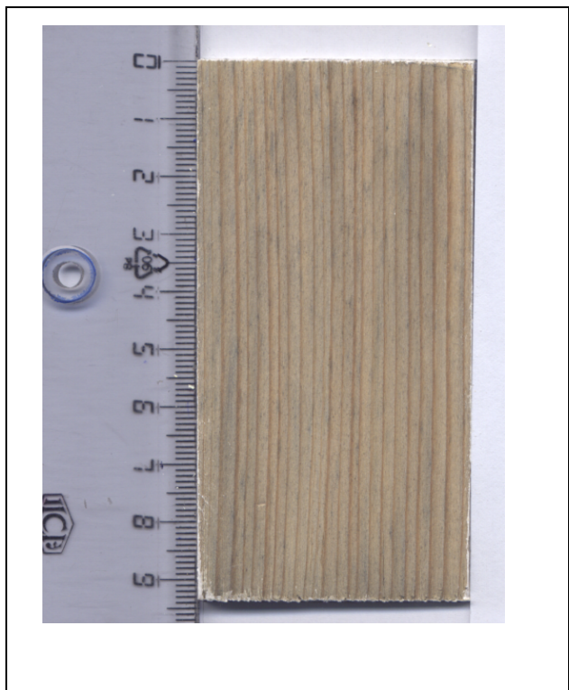
Εικόνα 53. Δοκίμιο E22-M ΜΕΤΑ ΑΠΟ 149 ΗΜΕΡΕΣ ΕΚΘΕΣΗΣ
