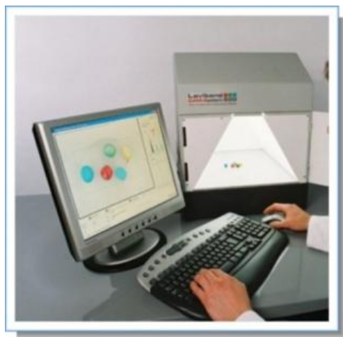
Εικόνα 11. Χρωματόμετρο τύπου Lovibond®CAM-System ( www.colourmeasurement.co.uk )
