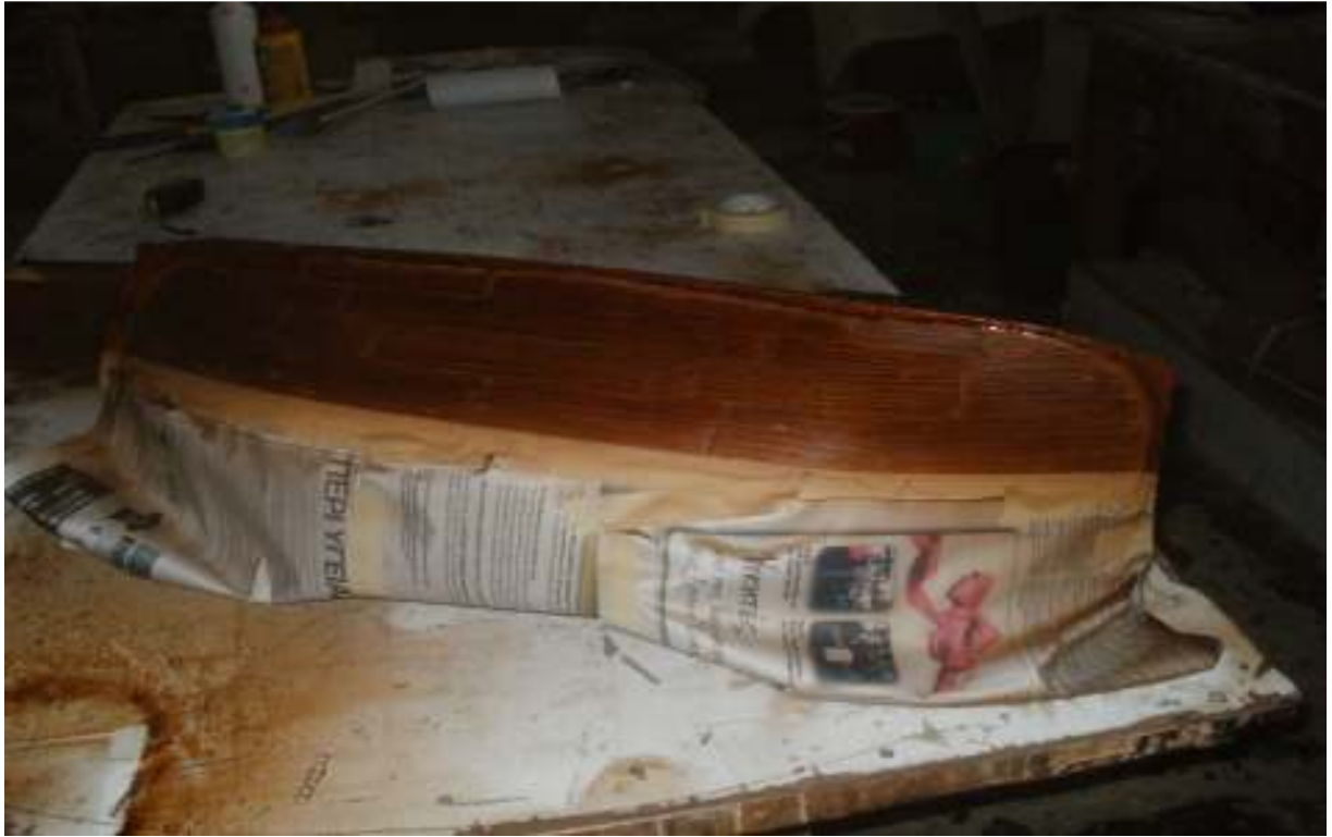
Εικ.71 Βάψιμο με χρώμα στο κάτω μέρος και δημιουργία γραμμής ύφαλου.
