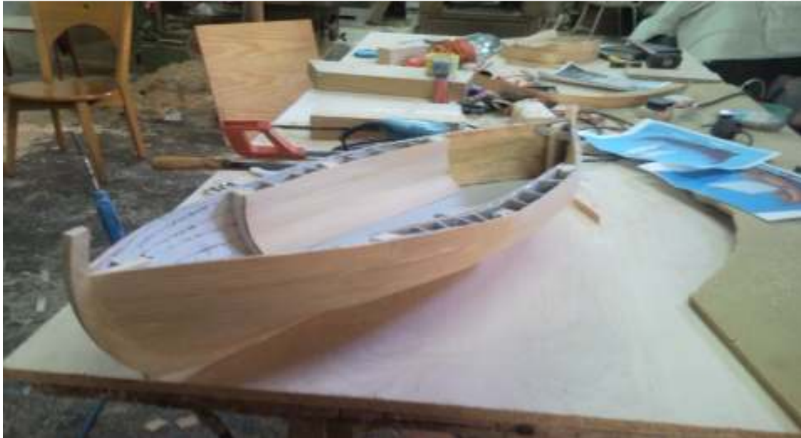
Εικ.65 Επένδυση ξυλοφύλλου στο εσωτερικό μέρος του πλοίου.
