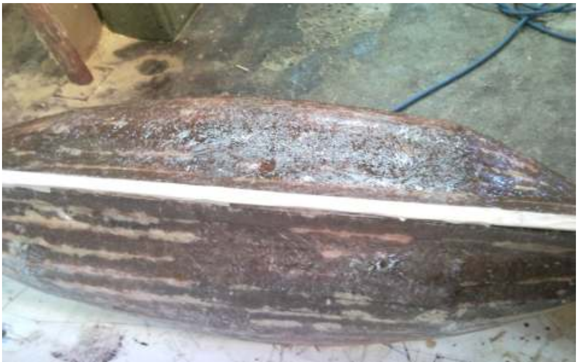
Εικ.62 Τελικό αποτέλεσμα μετά την εφαρμογή του fiberglass.
