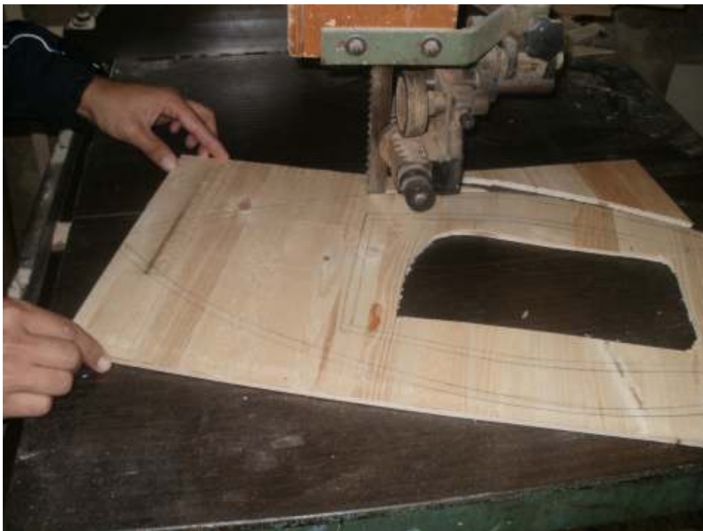
Εικ.66 Κοπή σηματομεμένου ξύλου που θα αποτελέσει τη βάση του καταστρώματος.
