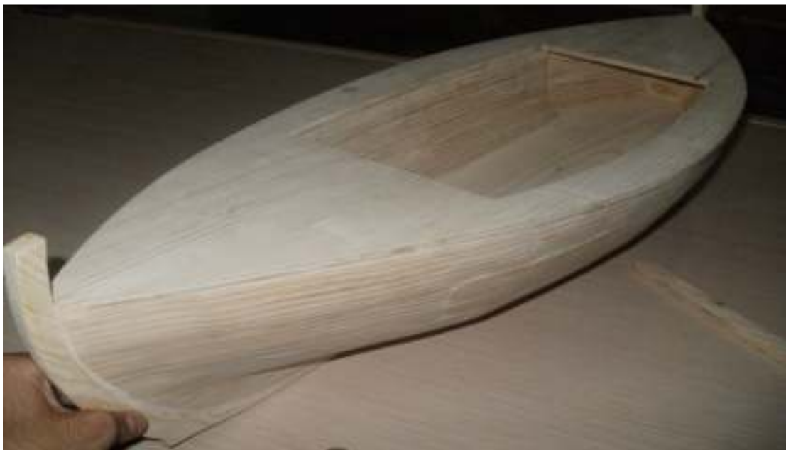
Εικ.68 Τοποθέτηση του καταστρώματος.
