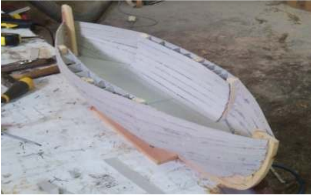
Εικ.57 Διαδικασία στερέωσης του εξωτερικού περιβλήματος και των επιπλέον κομματιών για τον καθορισμό του σχήματος.
