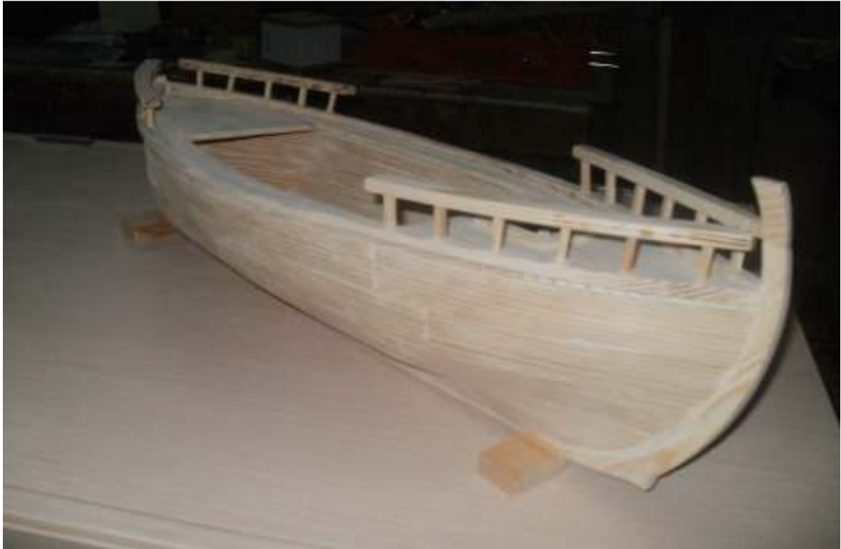
Εικ.70 Τοποθέτηση ξύλινων κάγκελων.
