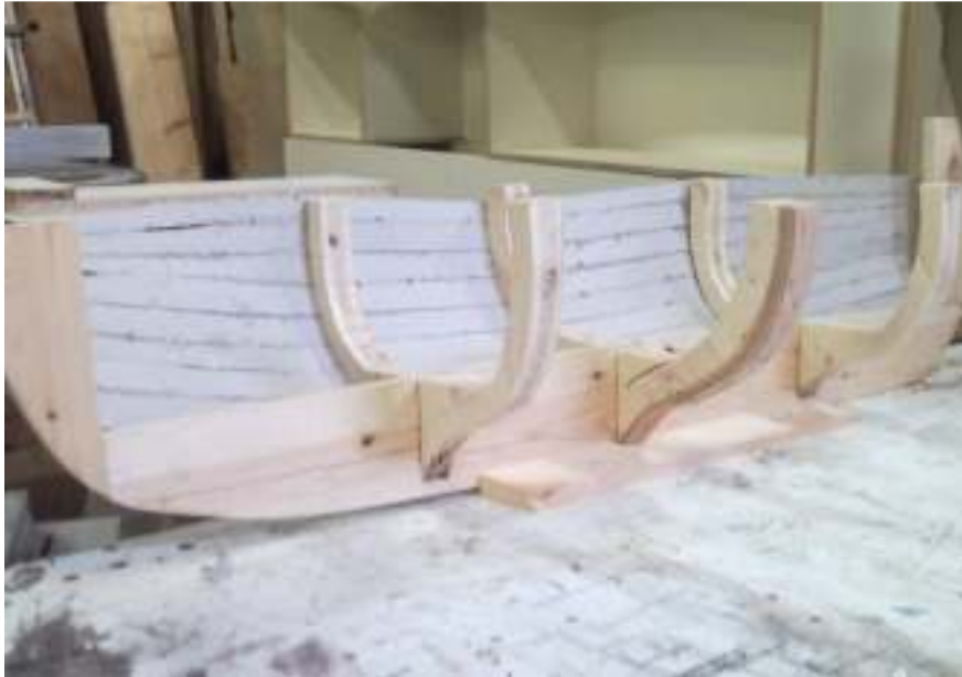
Εικ.55 Διαδικασία στερέωσης του εξωτερικού περιβλήματος με χαρτόνι.
