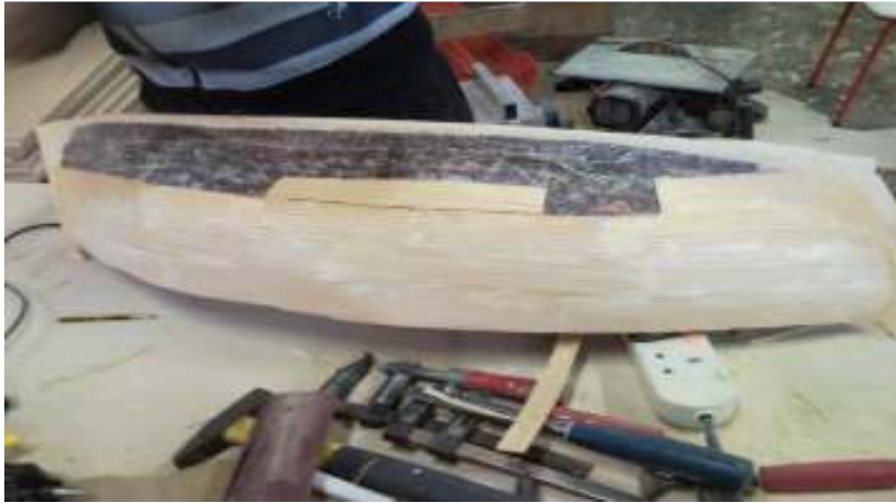
Εικ.63 Επένδυση ξυλοφύλλου στο εξωτερικό μέρος του πλοίου.
