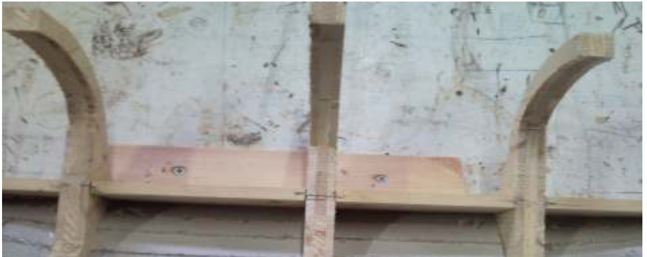
Εικ.54 Εγκοπές στη καρίνα για τη σύνδεση των νομέων.
