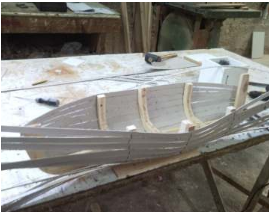
Εικ.56 Διαδικασία στερέωσης του εξωτερικού περιβλήματος.
