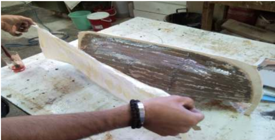
Εικ.60 Διαδικασία τοποθέτησης του fiberglass.
