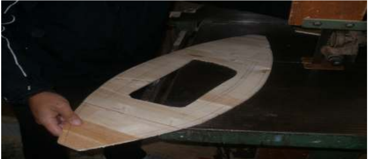
Εικ.67 Τελική μορφή της βάσης του καταστρώματος.
