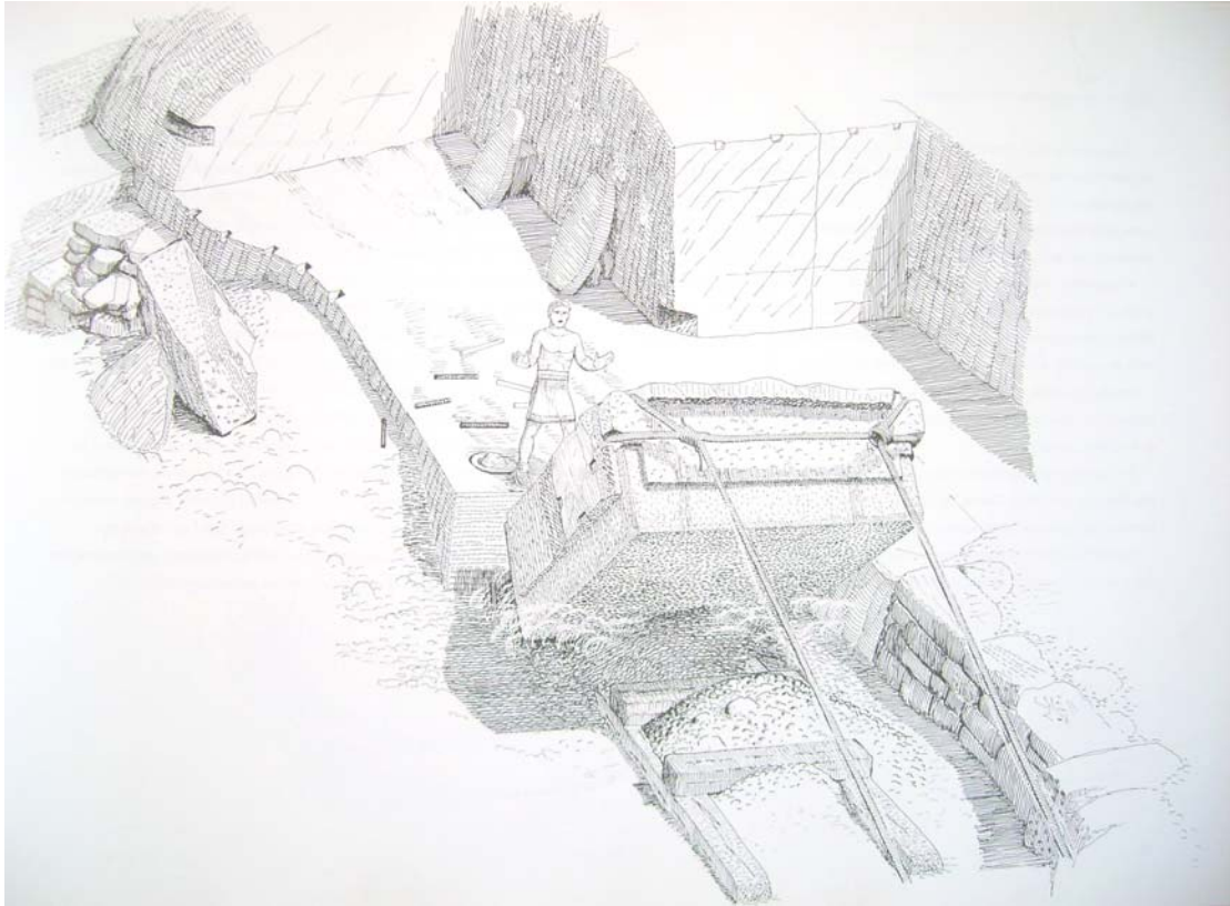
Εικ. 3.8.1 Το μάρμαρο σύρεται με τη βοήθεια από τα σχοινιά βαρουλκών
