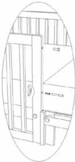
Λεπτομέρεια 2. Αφαίρεση του πείρου ασφαλείας και του πείρου - οδηγού.
