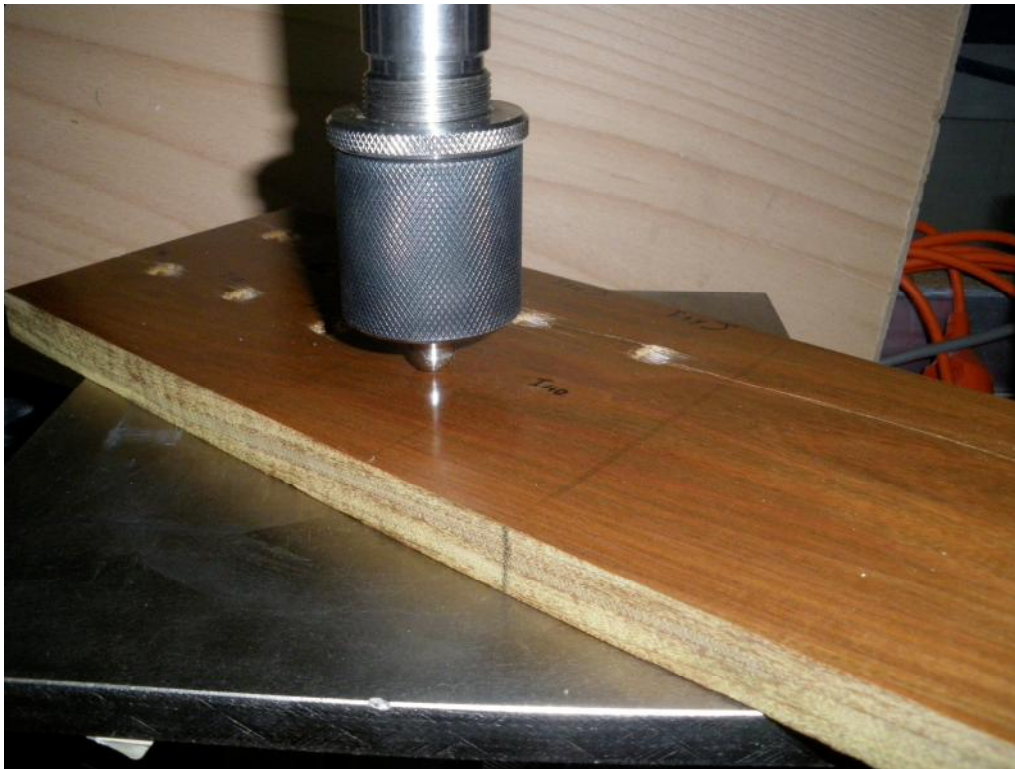
Εικόνα 7. Μέτρηση σκληρότητας με τη μέθοδο Janka.
