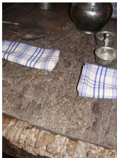
Εικόνα 26. Ι.Μ. Μ. Μετεώρου-Έντονη αποσάθρωση και αποπίπτοντα τμήματα ξύλου της τράπεζας
