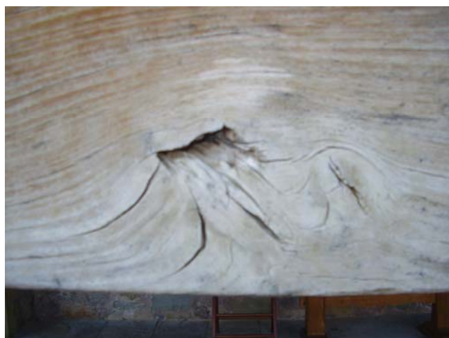
Εικόνα 10 Ι.Μ. Αγίου Στεφάνου-Σήμαντρο, αποπίπτοντας ρόζος
