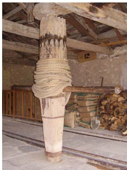
Εικόνα 34. Ι.Μ. Βαρλαάμ-Ο ξύλινος εργάτης για το δίχτυ
